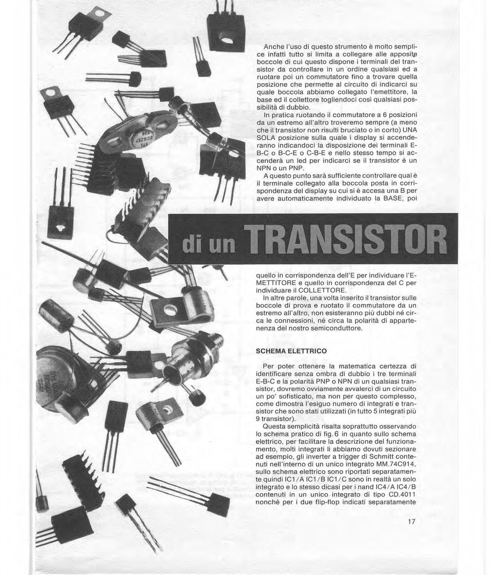
Anche l'uso di questo strumento è molto semplice infatti tutto si limita a collegare alle apposite boccole di cui questo dispone i terminali del transistor da controllare in un ordine qualsiasi ed a ruotare poi un commutatore fino a trovare quella posizione che permette al circuito di indicarci su quale boccola abbiamo collegato l'emettitore, la base ed il collettore togliendoci così qualsiasi possibilità di dubbio.
