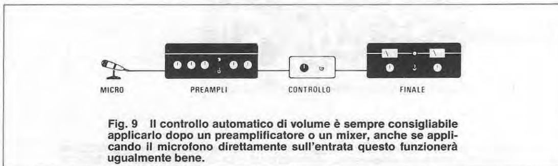
**Fig. 9** Il controllo automatico di volume è sempre consigliabile applicarlo dopo un preamplificatore o un mixer, anche se applicando il microfono direttamente sull'entrata questo funzionerà ugualmente bene.
