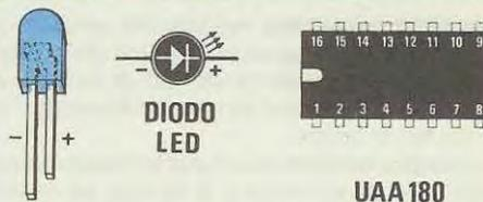
**Fig. 2** Connessioni dell'UAA.180 visto da sopra e del diodo led. Per individuare il catodo e l'anodo dei diodi led ricordatevi che il terminale più lungo è l'anodo.
