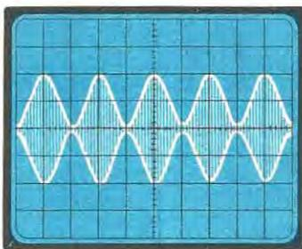
**Fig. 8** Solo erogando lo stadio di BF una potenza pari a quella del segnale AF si riesce a modulare una portante al 100%, l'ampiezza del segnale modulato in questo caso risulterà maggiore di quella di fig. 7.
