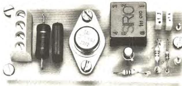
**Tale schema permette di interfacciare qualsiasi circuito a bassa tensione, con un carico alimentato direttamente dalla tensione di rete a 220 volt, senza utilizzare alcun relè.**
