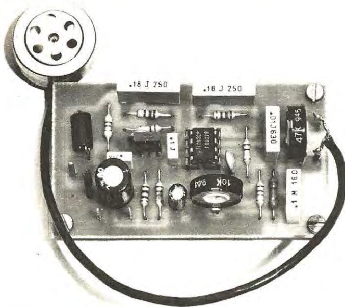
Foto del modulatore per il trasmettitore sperimentale LX.527.
