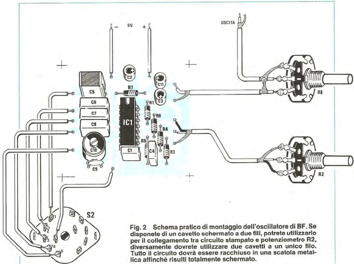
**Fig. 2** Schema pratico di montaggio dell'oscillatore di BF. Se disponete di un cavetto schermato a due fili, potrete utilizzarlo per il collegamento tra circuito stampato e potenziometro R2, diversamente dovrete utilizzare due cavetti a un unico filo. Tutto il circuito dovrà essere racchiuso in una scatola metallica affinché risulti totalmente schermato.
