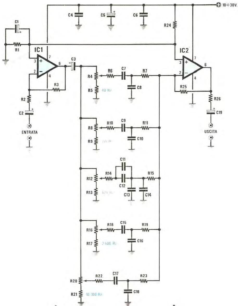
**Fig. 1** Schema elettrico del mini-equalizzatore Hi-Fi. Questo circuito risulta in versione mono, per realizzarlo STEREO ne occorrono due identiche copie. Come spiegato nell'articolo, variando la capacità dei condensatori è possibile modificare la frequenza d'incrocio di ogni filtro.
