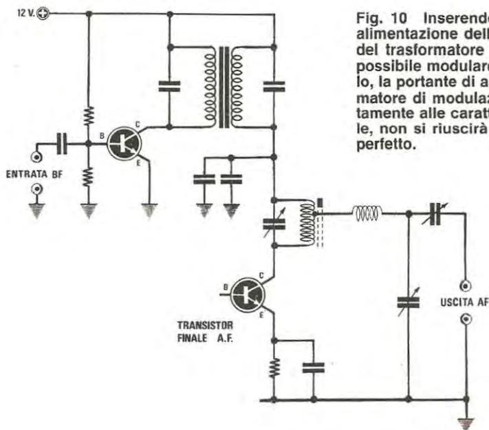
Fig. 10 Inserendo in serie alla tensione di alimentazione dello stadio AF, il secondario del trasformatore di uno stadio finale BF è possibile modulare, come spiegato in articolo, la portante di alta frequenza. Se il trasformatore di modulazione non si adatta perfettamente alle caratteristiche dello stadio finale, non si riuscirà mai a modularlo in modo perfetto.
