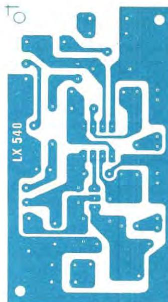
Fig. 14 Disegno a grandezza naturale del circuito stampato necessario per la realizzazione di questo modulatore.
