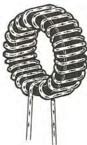
**Fig. 5** L'impedenza Z1 dovrete autocostruirla avvolgendo intorno al nucleo in ferrite 40 spire di filo di rame smaltato del diametro di 0,7 - 0,8 mm. Ricordatevi, una volta terminato il montaggio di raschiare le due estremità di tale filo in modo da eliminare la vernice isolante.
