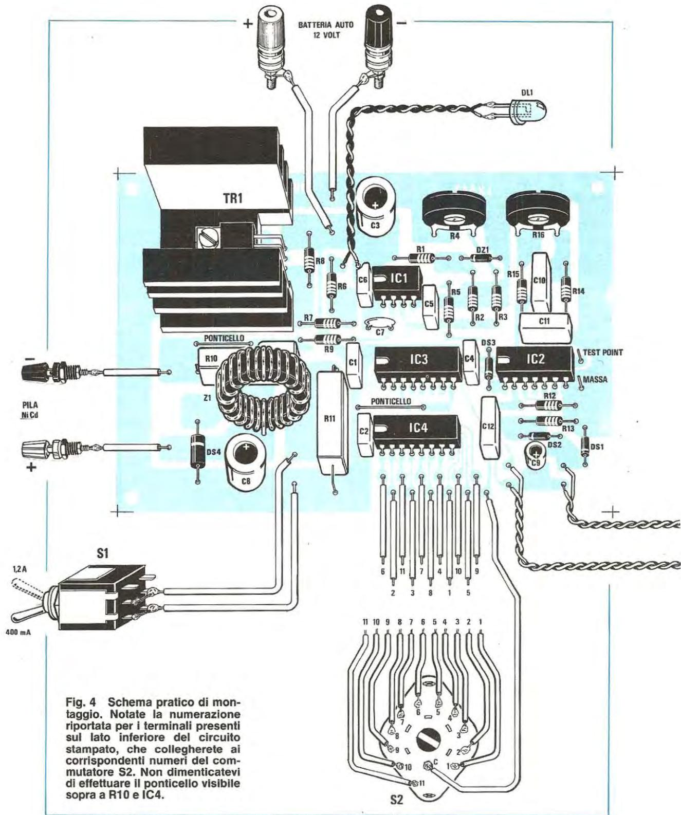
**Fig. 4** Schema pratico di montaggio. Notate la numerazione riportata per i terminali presenti sul lato inferiore del circuito stampato, che collegherete ai corrispondenti numeri del commutatore S2. Non dimenticatevi di effettuare il ponticello visibile sopra a R10 e IC4.
