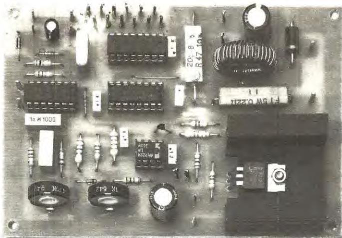
Dalla foto di uno dei prototipi riportata qui di lato, potrete notare come si presenta a realizzazione ultimata il carica-pile. Notate il transistor di potenza fissato sopra all'aletta dissipatrice.
