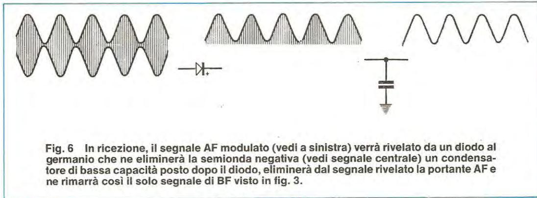
**Fig. 6** In ricezione, il segnale AF modulato (vedi a sinistra) verrà rivelato da un diodo al germanio che ne eliminerà la semionda negativa (vedi segnale centrale) un condensatore di bassa capacità posto dopo il diodo, eliminerà dal segnale rivelato la portante AF e ne rimarrà così il solo segnale di BF visto in fig. 3.
