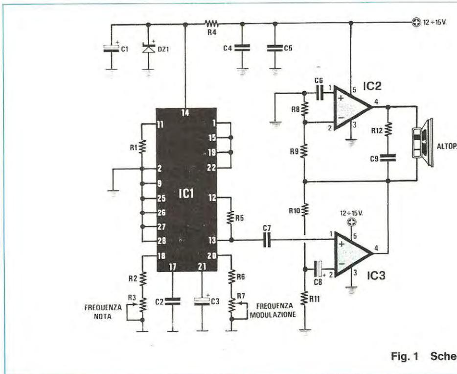
Fig. 1 Schema elettrico
