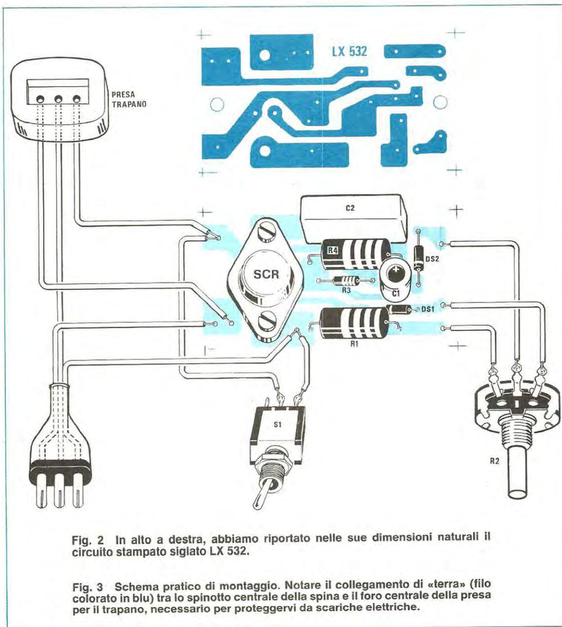
**Fig. 2** In alto a destra, abbiamo riportato nelle sue dimensioni naturali il circuito stampato siglato LX 532.
