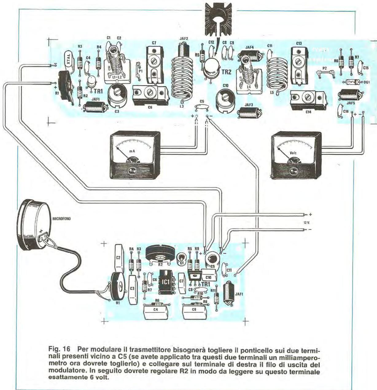
**Fig. 16** Per modulare il trasmettitore bisognerà togliere il ponticello sui due terminali presenti vicino a C5 (se avete applicato tra questi due terminali un milliamperometro ora dovete toglierlo) e collegare sul terminale di destra il filo di uscita del modulatore. In seguito dovete regolare R2 in modo da leggere su questo terminale esattamente 6 volt.
