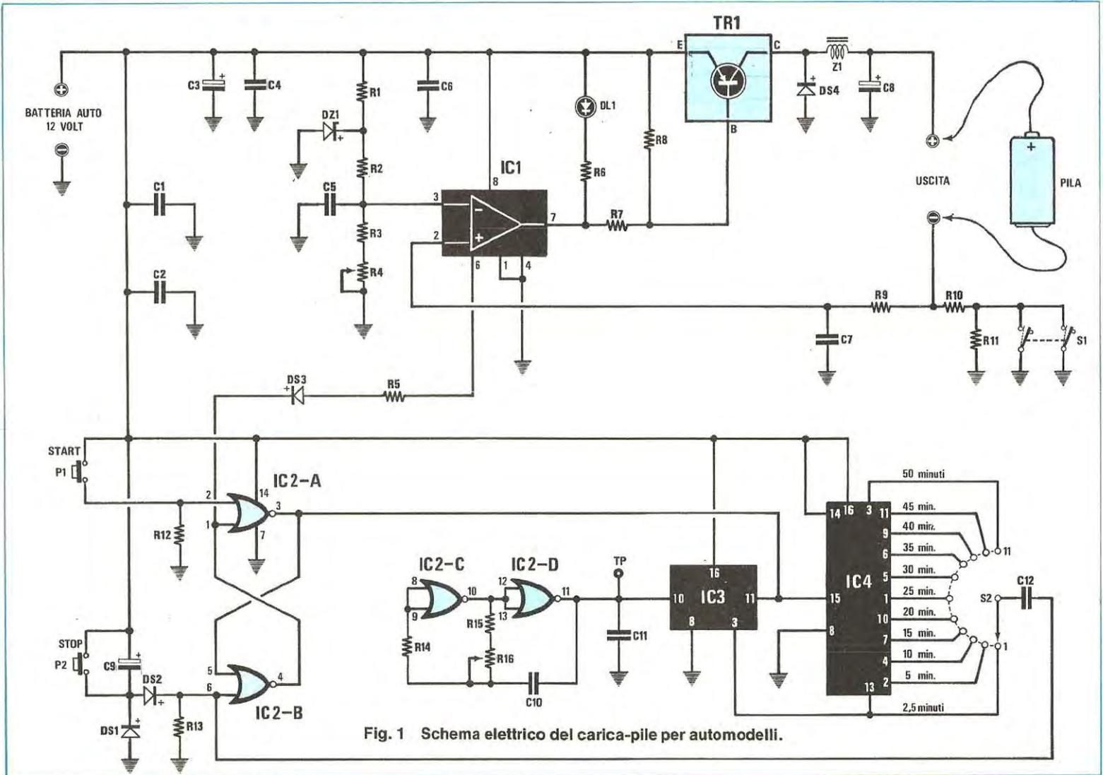
Fig. 1 Schema elettrico del carica-pile per automodelli.
