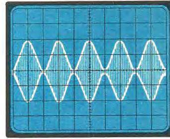
**Fig. 5** Modulando il segnale di AF di Fig. 4 con il segnale di BF di Fig. 3 se ne ricaverà il segnale visibile in figura. Notate il segnale BF riportato sia nel lato superiore che in quello inferiore.
