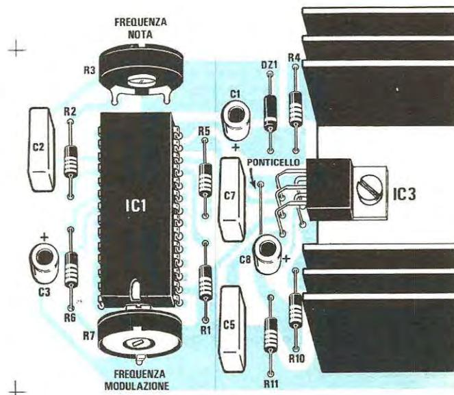
figurazione a ponte (vedi IC2 - IC3) siamo riusciti a raggiungere una potenza di circa 30 watt con un carico di 4 ohm, mentre, con un carico di 8 ohm la potenza raggiunta è di 15 watt.
