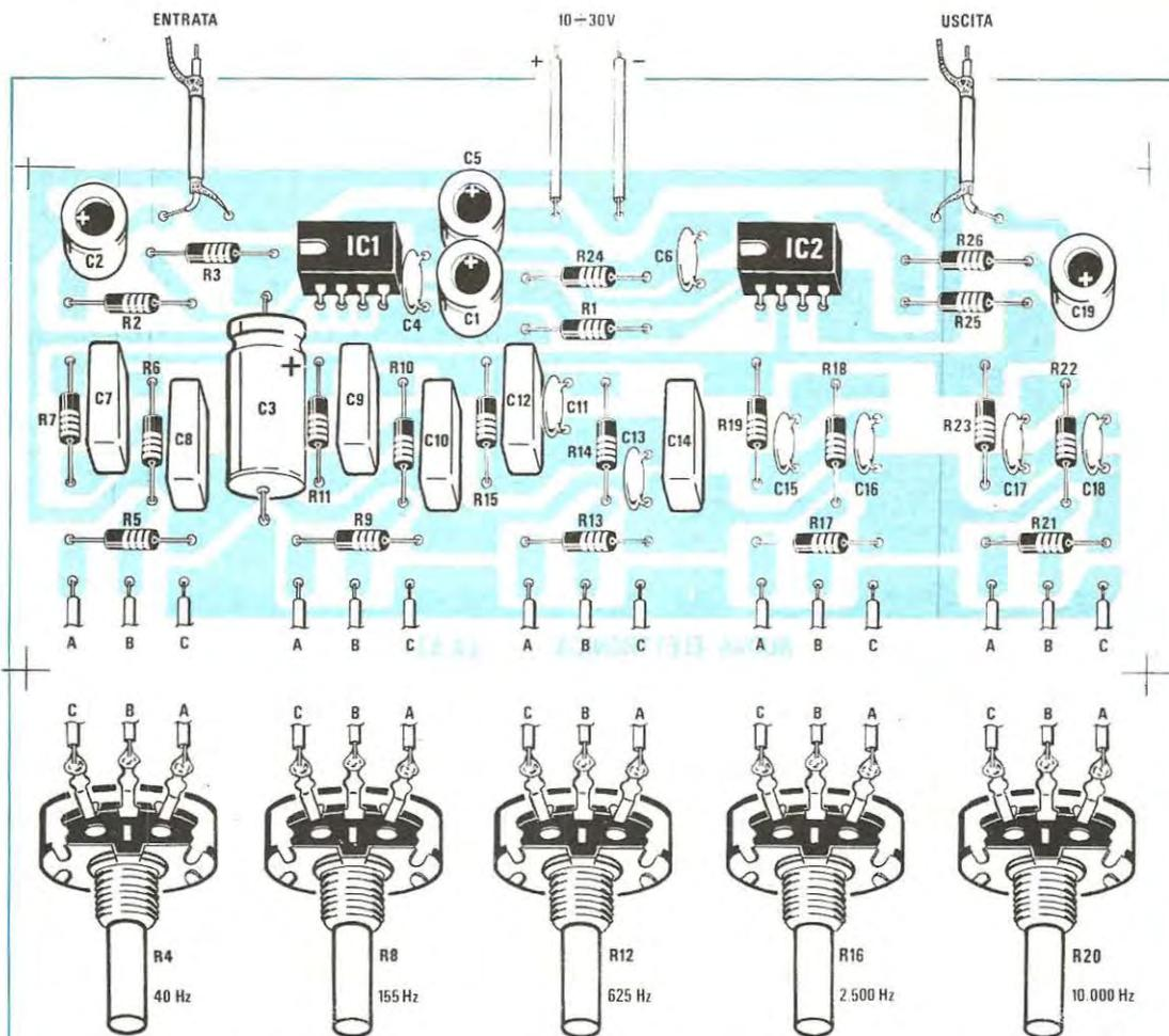
**Fig. 2** Schema pratico di montaggio dell'equalizzatore. In basso sul circuito stampato sono presenti i terminali per i collegamenti dei cinque potenziometri (leggi articolo).
