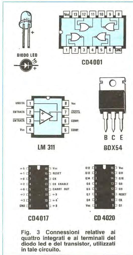
Fig. 3 Connessioni relative ai quattro integrati e ai terminali del diodo led e del transistor, utilizzati in tale circuito.
