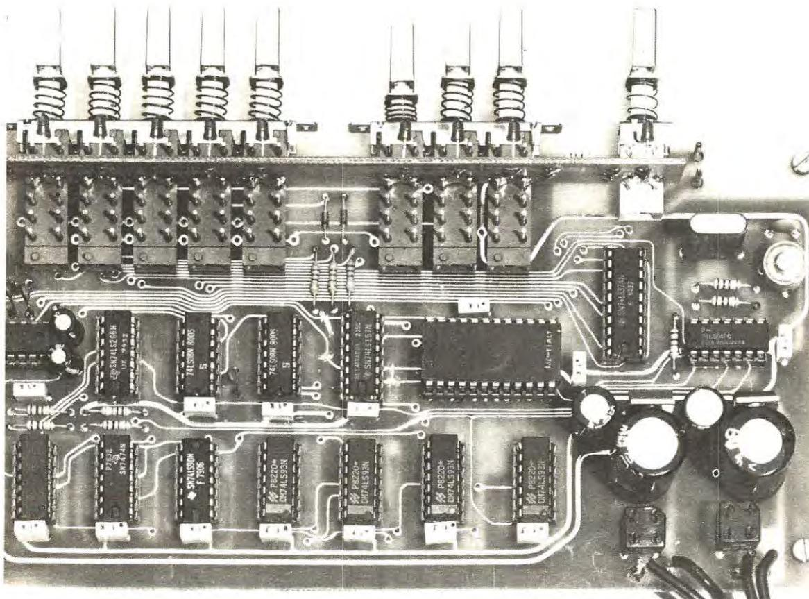
Qui sopra la foto di uno dei nostri primi prototipi di generatore di barre e colori. Si noti il circuito stampato porta-led fissato sopra i terminali dei commutatori a slitta. Nel progetto definitivo i diodi led li abbiamo sostituiti con quelli di tipo rettangolari.
