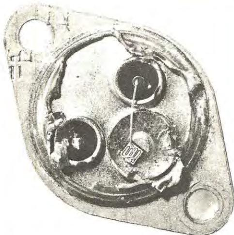
Qui sopra, la foto del darlington montato sull'alimentatore LX 343 inviatici dall'Ing. A.F. di Terracina. Controllando con un tracciacurve tale darlington, acquistato dall'Ingegnere presso un negoziante di fiducia, abbiamo immediatamente constatato che risultava un comune transistor, aprendolo infatti, ne abbiamo avuto la conferma.
