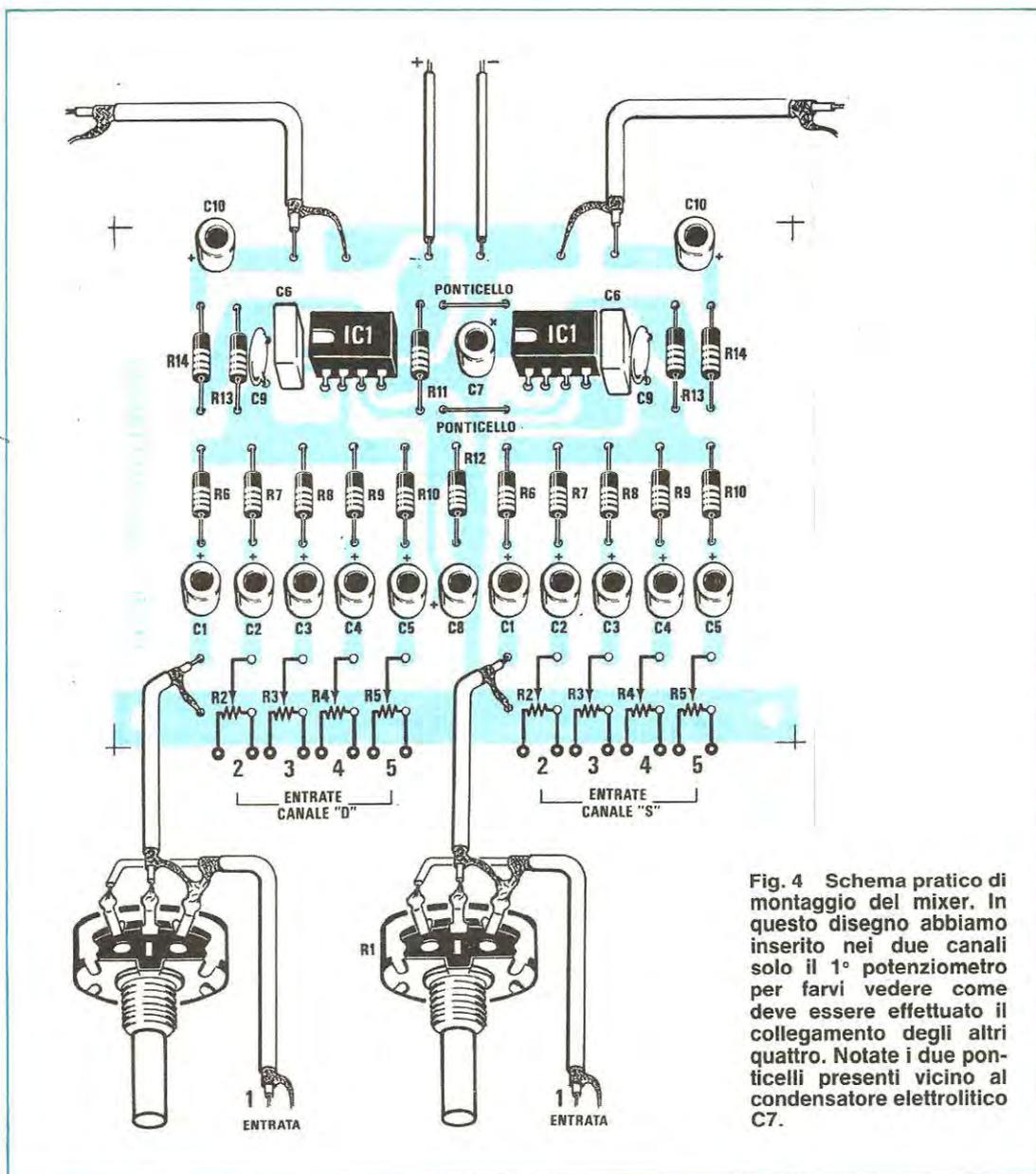
Fig. 4 Schema pratico di montaggio del mixer. In questo disegno abbiamo inserito nei due canali solo il 1° potenziometro per farvi vedere come deve essere effettuato il collegamento degli altri quattro. Notate i due ponticelli presenti vicino al condensatore elettrolitico C7.
