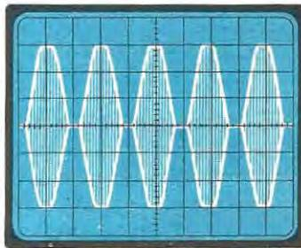
**Fig. 9** Se il segnale di BF risulta di potenza superiore a quello del segnale AF si «sovramodula» cioè l'onda sinusoidale viene troncata superiormente e al centro e in ricezione il segnale verrà captato distorto.
