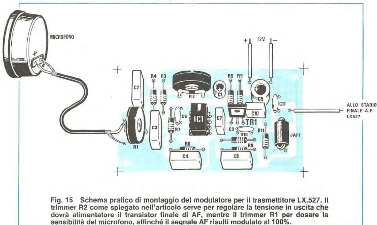
Fig. 15 Schema pratico di montaggio del modulatore per il trasmettitore LX.527. Il trimmer R2 come spiegato nell'articolo serve per regolare la tensione in uscita che dovrà alimentare il transistor finale di AF, mentre il trimmer R1 per dosare la sensibilità del microfono, affinché il segnale AF risulti modulato al 100%.
