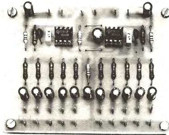
Foto del prototipo del mixer stereo da noi siglato LX.538. Consigliamo di racchiudere il circuito entro una scatola totalmente metallica per evitare che questo capti del ronzio di alternata.
