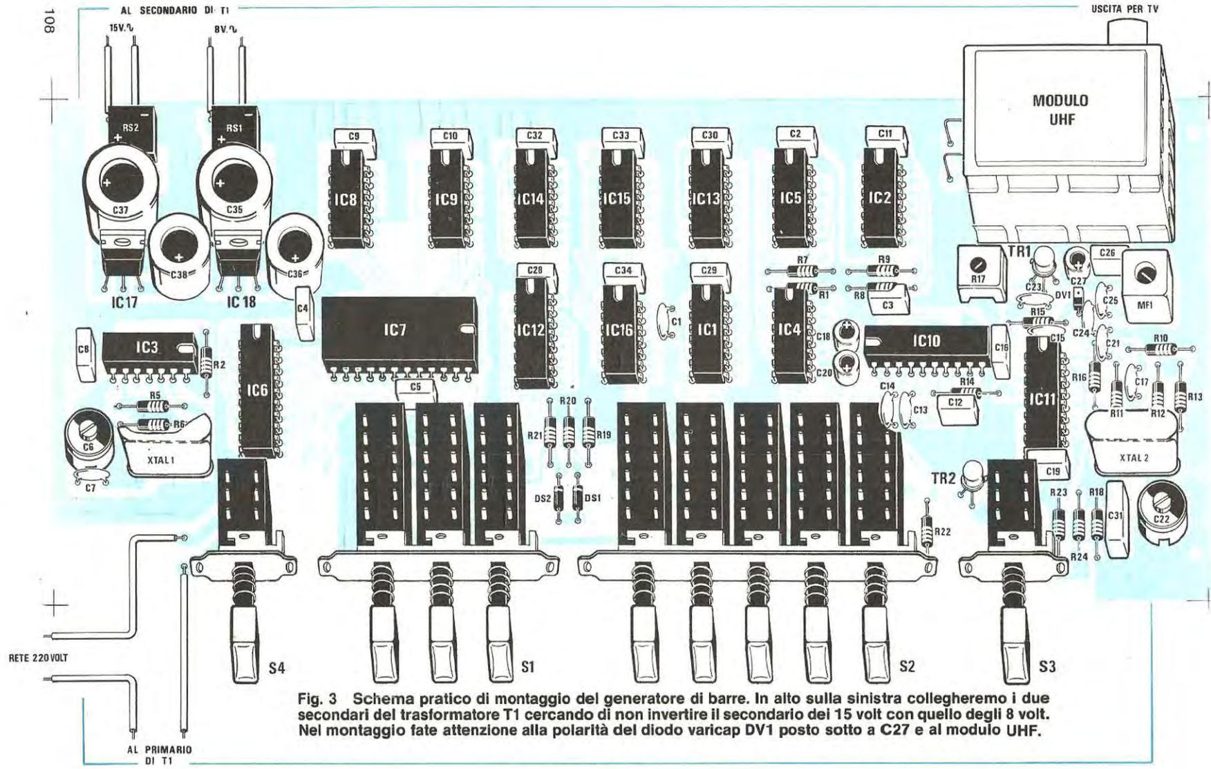
**Fig. 3** Schema pratico di montaggio del generatore di barre. In alto sulla sinistra collegheremo i due secondari del trasformatore T1 cercando di non invertire il secondario del 15 volt con quello degli 8 volt. Nel montaggio fate attenzione alla polarità del diodo varicap DV1 posto sotto a C27 e al modulo UHF.
