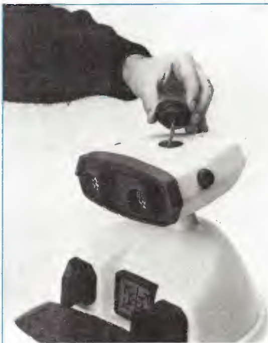
Fig.22 Non dimenticatevi, una volta saldati i fili dei due motorini, di collegare i due condensatori antidisturbo come consigliato in fig.5.
