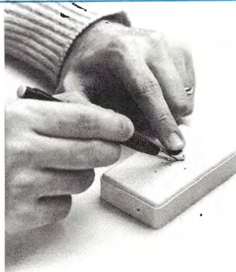
Fig.14 Forate con una punta da 2 mm. i punti incisi, poi infilate il pulsante cercando di fare entrare i terminali nel circuito stampato. Con una matita disegnatene il perimetro.
