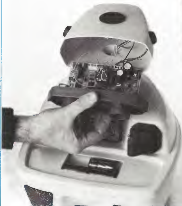
Fig.19 Per montare la testa del robot, dovrete avvitare le due viti presenti all'interno del mobile.
