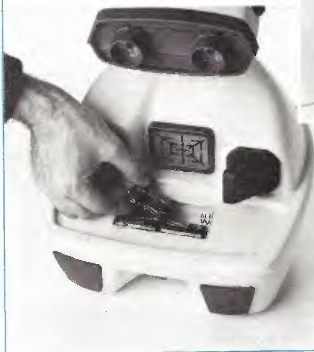
Fig.22 Non dimenticatevi, una volta saldati i fili dei due motorini, di collegare i due condensatori antidisturbo come consigliato in fig.5.
