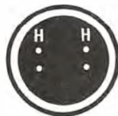
Fig.6 Il piedino di riferimento, come vedesi in questo disegno, è un piccolo terminale collegato allo schermo metallico dello stesso trasformatore.
