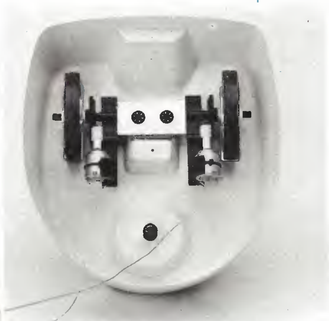
Fig.22 Non dimenticatevi, una volta saldati i fili dei due motorini, di collegare i due condensatori antidisturbo come consigliato in fig.5.
