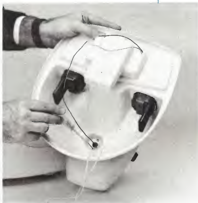
Fig.19 Per montare la testa del robot, dovrete avvitare le due viti presenti all'interno del mobile.
