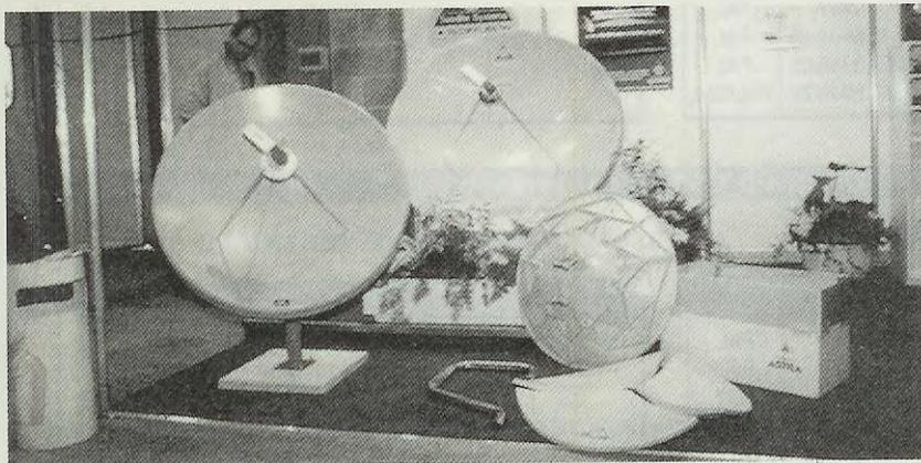
Non tutte le parabole hanno un identico rendimento. Da prove effettuate abbiamo riscontrato che vi sono parabole da 1,80 metri il cui guadagno varia da 42 a 45 dB e parabole da 1,50 metri, il cui guadagno varia da 41 a 43 dB.
