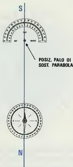
Fig.10 Il cartoncino di fig.9 andrà posto sotto il palo di supporto della parabola, cercando di far collimare i "180 gradi" con la punta Sud della bussola. Poiché la bussola è sensibile ai metalli, conviene tenerla lontano dal palo, poi con un righello tracciare sul terreno la linea Sud- Nord.
