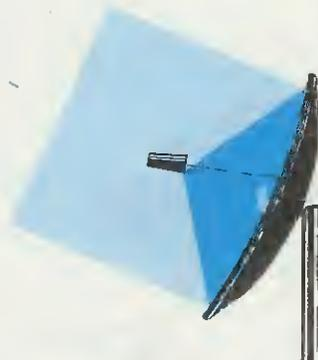
Fig.19 Anche una leggera inclinazione del Convertitore rispetto all'asse centrale della parabola, o la deformazione di un supporto, possono modificare di 1 grado +/- l'angolo reale di elevazione.
