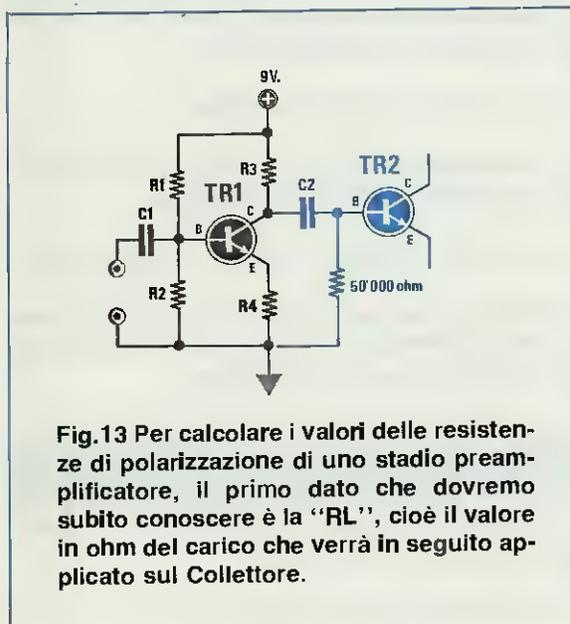
Fig.13 Per calcolare i valori delle resistenze di polarizzazione di uno stadio preamplificatore, il primo dato che dovremo subito conoscere è la "RL", cioè il valore in ohm del carico che verrà in seguito applicato sul Collettore.
