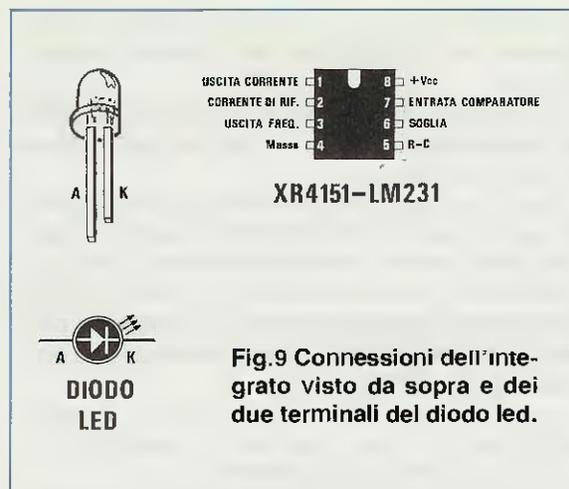
Fig. 9 Connessioni dell'integrato visto da sopra e dei due terminali del diodo led.
