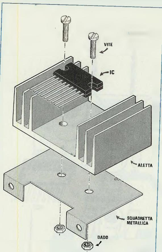
Fig.5 Nel kit, oltre all'aletta di raffreddamento troverete anche una squadretta metallica. Come potete vedere in questo disegno, l'integrato IC2 andrà applicato all'interno dell'aletta. Con le due viti che utilizzerete per fissare l'integrato, bloccherete anche la squadretta di fissaggio a L (fig.7).
