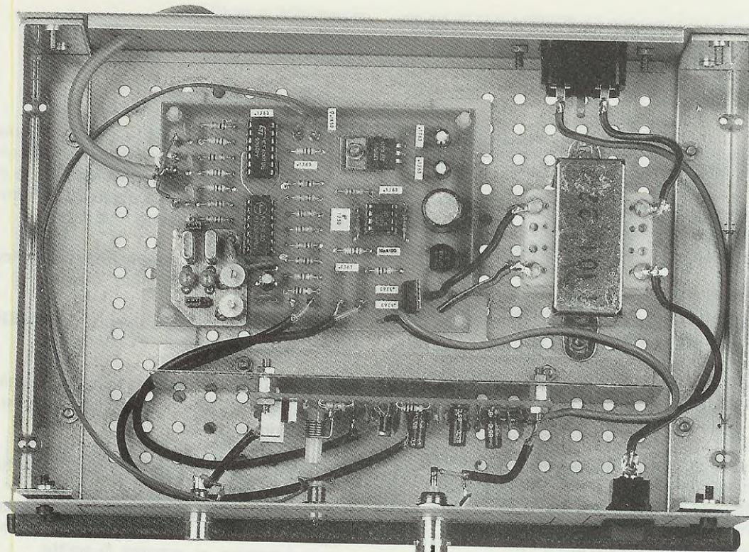
Fig.7 All'interno del mobile, il circuito stampato del sintetizzatore viene fissato al piano base con quattro distanziatori autoadesivi in plastica. Se nello stesso mobile inserite il VFO, lo dovete fissare sulla squadretta di alluminio (vedi fig.8) che funge da SCHERMO.
