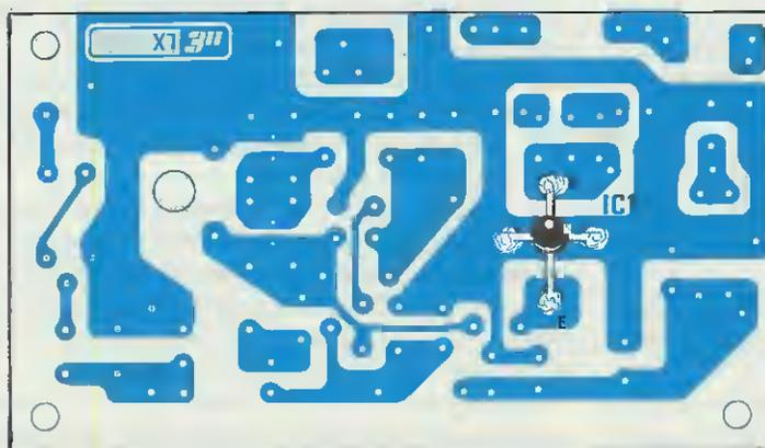
Fig.11 L'integrato MAV11 va saldato direttamente sulle piste in rame dello stampato, rivolgendo il terminale con il PALLINO di riferimento verso l'alto, cioè verso le piste che fanno capo ai condensatori C15-C17-C18 (vedi fig.10).
