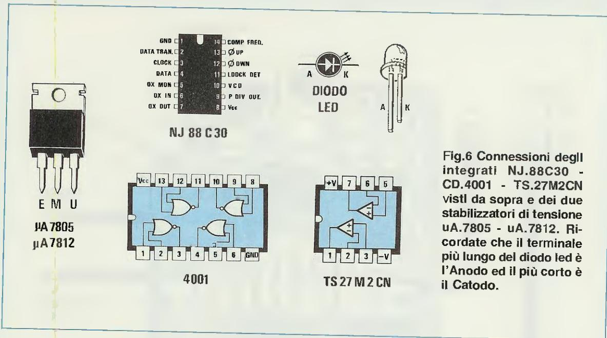
Fig.6 Connessioni degli integrati NJ.88C30 - CD.4001 - TS.27M2CN visti da sopra e dei due stabilizzatori di tensione uA.7805 - uA.7812. Ricordate che il terminale più lungo del diodo led è l'Anodo ed il più corto è il Catodo.
