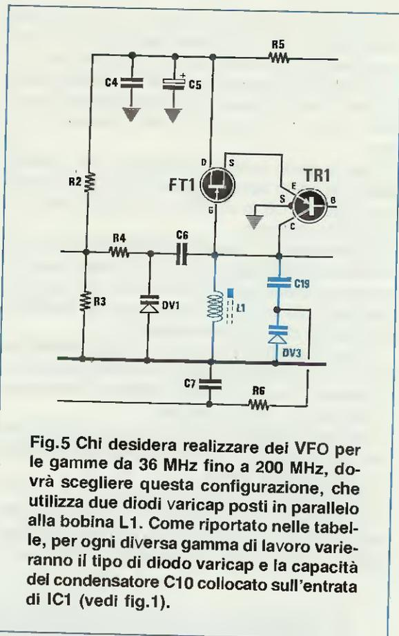
**Fig.5** Chi desidera realizzare dei VFO per le gamme da 36 MHz fino a 200 MHz, dovrà scegliere questa configurazione, che utilizza due diodi varicap posti in parallelo alla bobina L1. Come riportato nelle tabelle, per ogni diversa gamma di lavoro varieranno il tipo di diodo varicap e la capacità del condensatore C10 collocato sull'entrata di IC1 (vedi fig.1).
