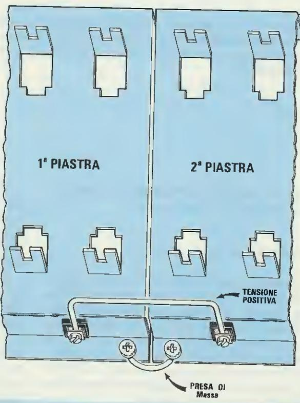
Fig.374 Quando collegate assieme due piastre di sostegno (vedi fig.371), non dimenticate di unire con un filo le due MASSE metalliche e con un altro le due morsettiere della tensione positiva.
