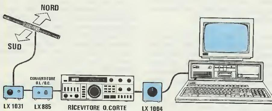
Fig.25 Coloro che dispongono di un solo ricevitore per Onde Corte in SSB, oltre ai kit LX.1030 - LX.1031 - LX.1004 dovranno montare il convertitore Onde Lunghe/Onde Corte LX.885 pubblicato nella rivista n.123. Con questo convertitore le Onde Lunghe verranno convertite sulla frequenza di 28 MHz.
