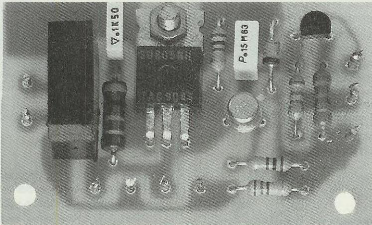
**Fig.5** Foto notevolmente ingrandita di un progetto montato. Si noti il diodo SCR fissato sullo stampato con una vite più dado.
