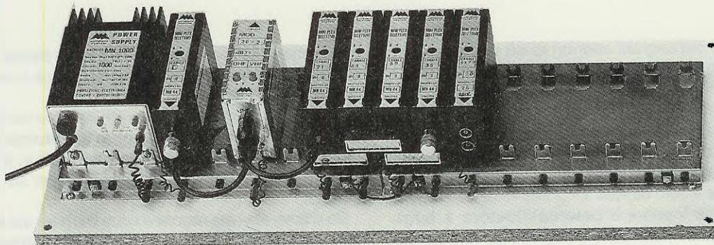
**Fig.371** Foto di una centralina da noi montata. Da sinistra verso destra potete vedere lo stadio di alimentazione, 1 filtro VHF, 1 finale di potenza con i due ingressi VHF-UHF separati (vedi figg.370), infine 4 filtri UHF ed 1 preamplificatore a larga banda.
