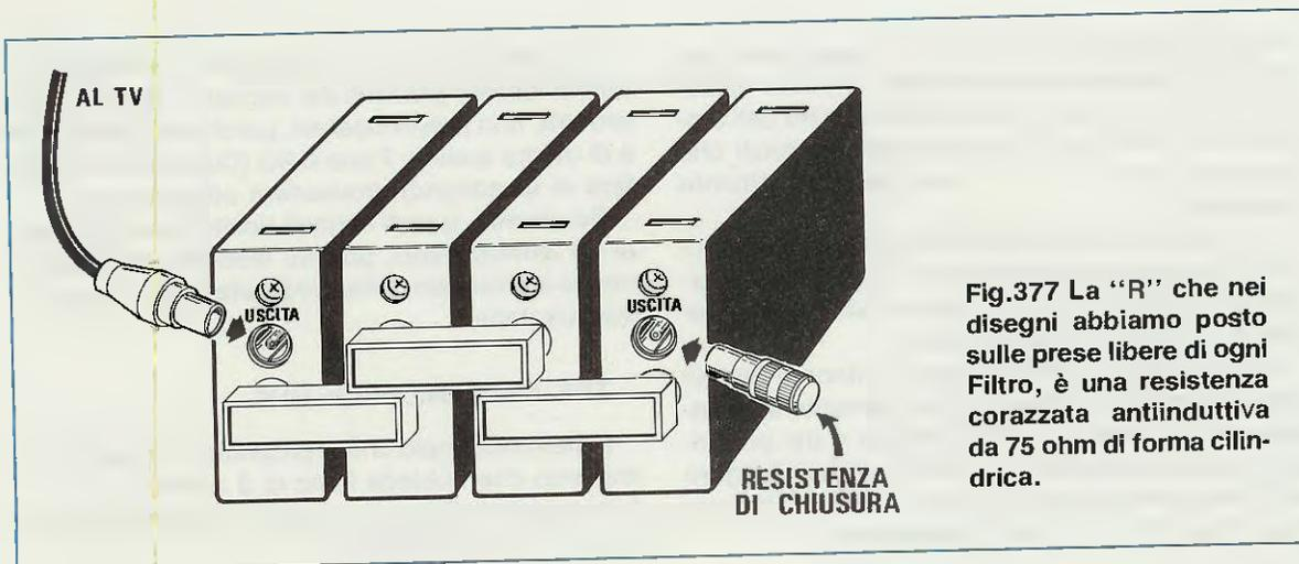
Fig.377 La "R" che nei disegni abbiamo posto sulle prese libere di ogni Filtro, è una resistenza corazzata antiinduttiva da 75 ohm di forma cilindrica.
