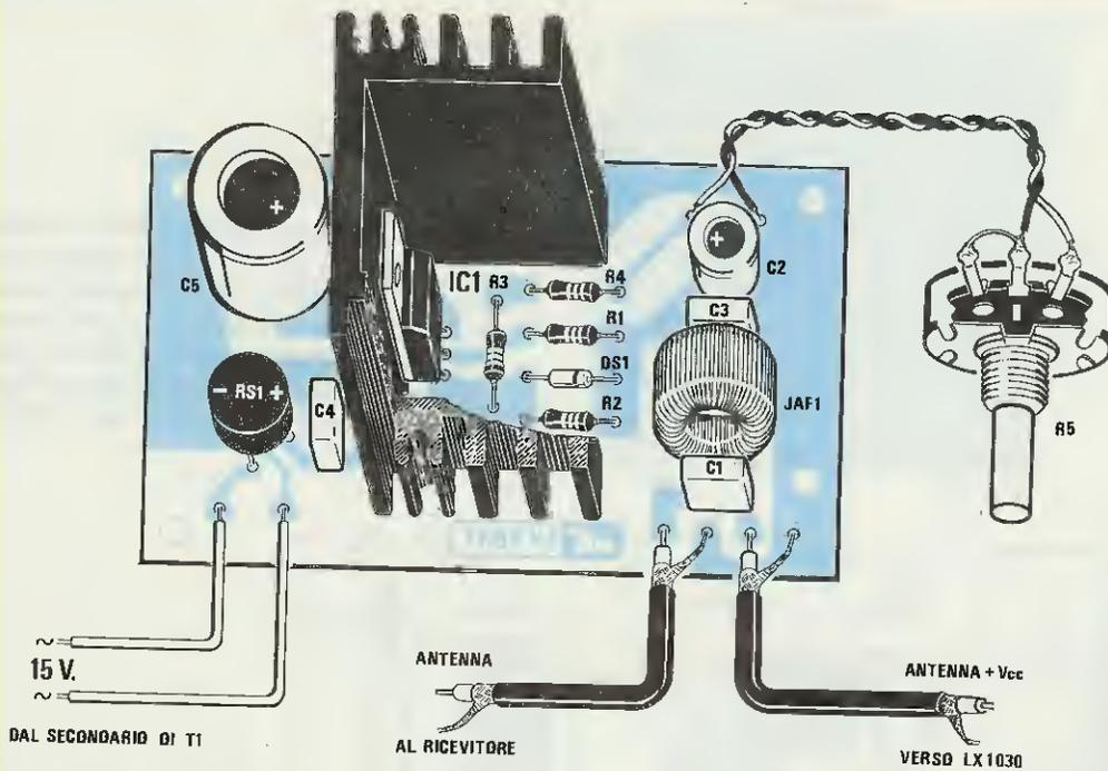
**Fig. 18** Schema pratico di montaggio dello stadio di alimentazione siglato LX.1031. Contrassegna- te con una etichetta il BNC "senza tensione" che andrà collegato al- l'ingresso del ricevitore, onde evitare di applica- re su questo la tensione continua dei 15 volt.
