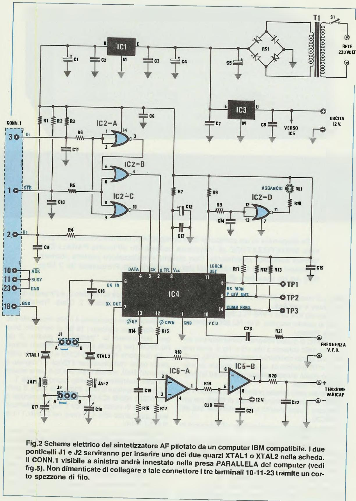
Fig.2 Schema elettrico del sintetizzatore AF pilotato da un computer IBM compatibile. I due ponticelli J1 e J2 serviranno per inserire uno dei due quarzi XTAL1 o XTAL2 nella scheda. Il CONN.1 visibile a sinistra andrà innestato nella presa PARALLELA del computer (vedi fig.5). Non dimenticate di collegare a tale connettore i tre terminali 10-11-23 tramite un corto spezzone di filo.
