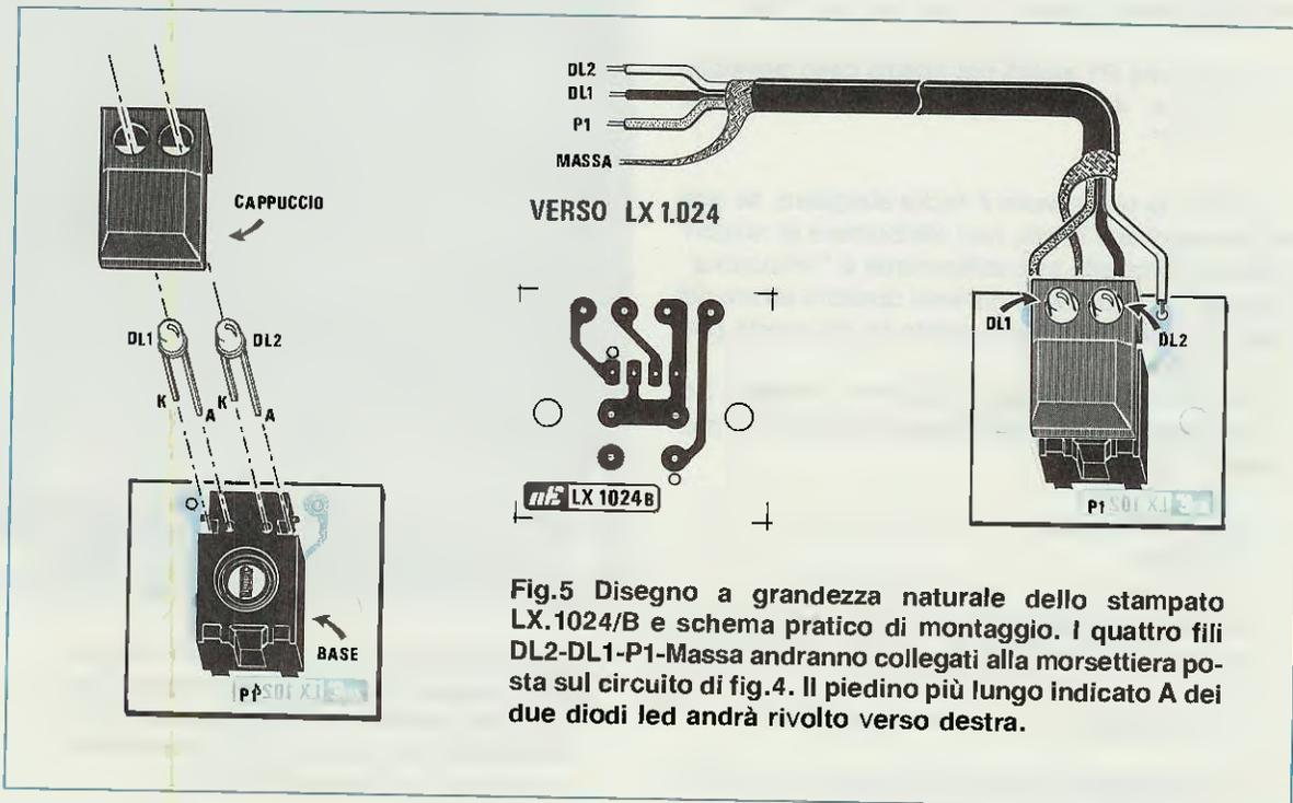
Fig.5 Disegno a grandezza naturale dello stampato LX.1024/B e schema pratico di montaggio. I quattro fili DL2-DL1-P1-Massa andranno collegati alla morsettiera posta sul circuito di fig.4. Il piedino più lungo indicato A dei due diodi led andrà rivolto verso destra.
