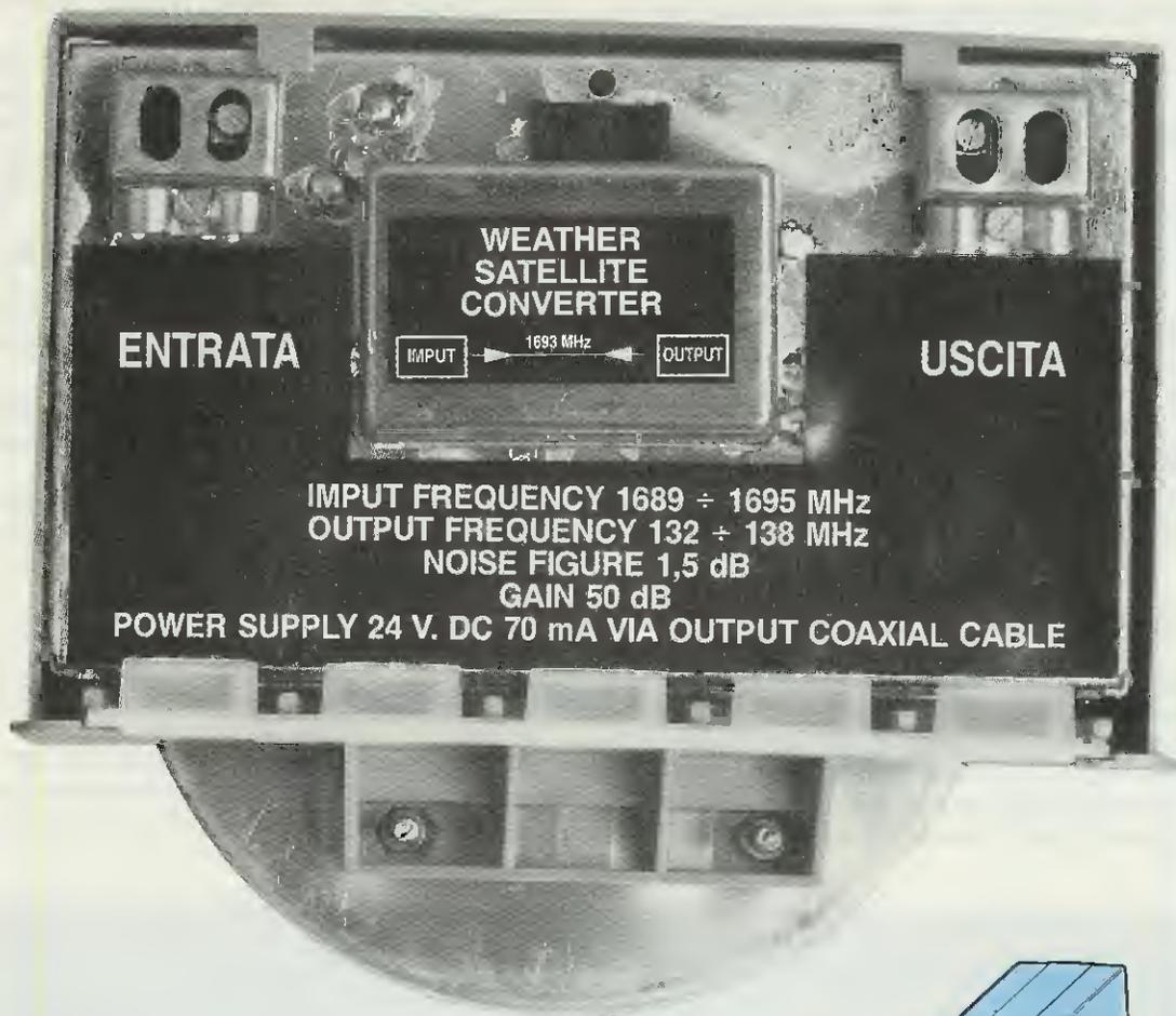
**Fig.2** Sollevando il coperchio plastico, vi apparirà il contenitore metallico del convertitore con due sole morsettiere, una per l'ENTRATA antenna ed una per l'USCITA del segnale verso il ricevitore. La tensione di alimentazione dei 24 volt giunge al convertitore tramite il cavo coassiale di discesa.
