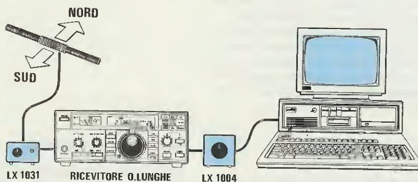
Fig.24 Chi dispone già di un ricevitore per Onde Lunghe in SSB dovrà soltanto collegare all'ingresso "antenna" il segnale prelevato dall'alimentatore LX.1031 e all'uscita BF il convertitore Fax LX.1004 presentato nella rivista n.142. Così facendo potrete visualizzare sul monitor tutte le immagini trasmesse.
