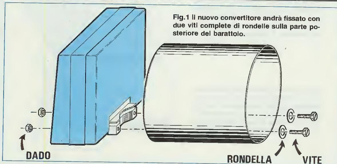
Fig.1 Il nuovo convertitore andrà fissato con due viti complete di rondelle sulla parte posteriore del barattolo.
