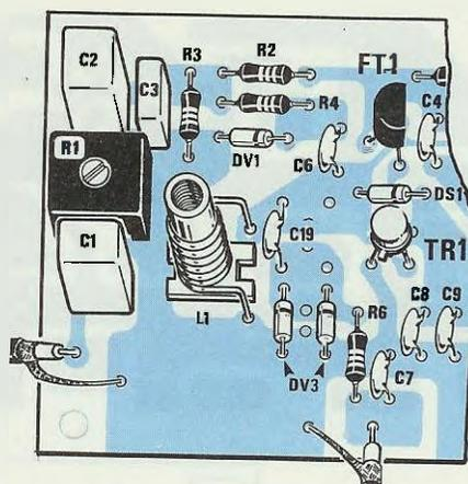
Fig.13 Chi realizzerà questo VFO per le gamme che richiedono due diodi varicap in parallelo come visibile in fig.6, dovrà rivolgere le fasce colorate verso C19. Questo condensatore ceramico posto in serie ai due diodi varicap deve risultare da 1.000 pF.
