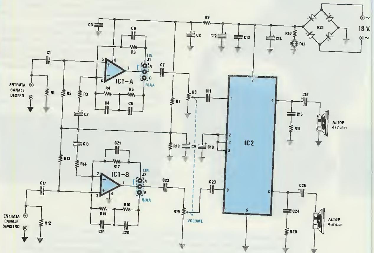
Fig.3 Schema elettrico dell'amplificatore Stereo da 7+7 Watt. Ai capi del ponte RS1 andranno collegati i 18 volt 2 amper erogati dal secondario del trasformatore T1. I capi del ponte RS1 servono per predisporre i due operazionali IC1/A e IC1/B per preamplificare segnali prelevati da testine piezo o magnetiche (vedi RIAA).
