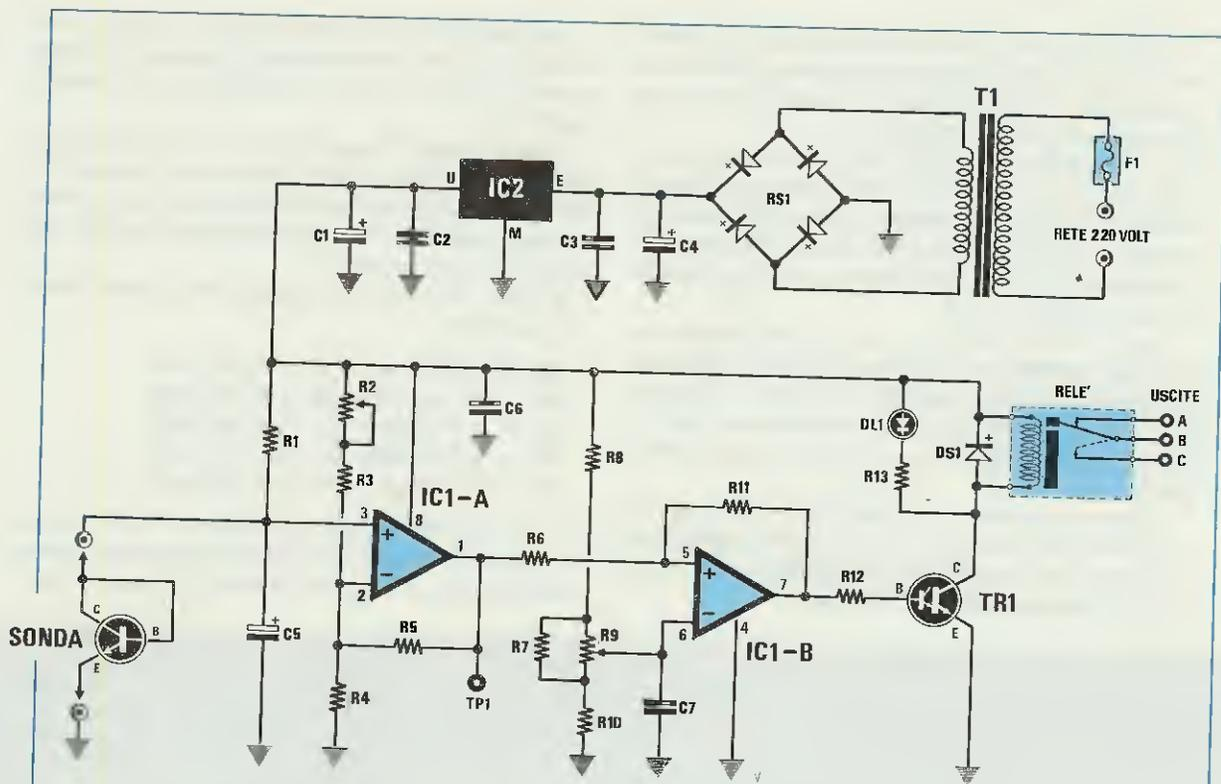
Fig.2 Schema elettrico del termostato. Posto il potenziometro R9 a metà corsa, dovrete regolare il trimmer R2 fino a leggere sul terminale TP1 una tensione di 6 volt.
