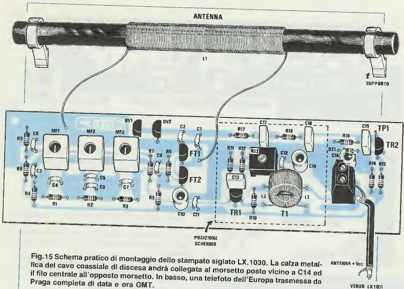
Fig. 15 Schema pratico di montaggio dello stampato siglato LX.1030. La calza metallica del cavo coassiale di discesa andrà collegata al morsetto posto vicino a C14 ed il filo centrale all'opposto morsetto. In basso, una telefoto dell'Europa trasmessa da Praga completa di data e ora GMT.
