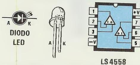
Fig. Connessioni viste da sopra dell'integrato LS.4558 e del diodo a led utilizzato come spia di alimentazione. Vi ricordiamo che il terminale più lungo di questo diodo (vedi A) andrà rivolto verso la resistenza R10.
