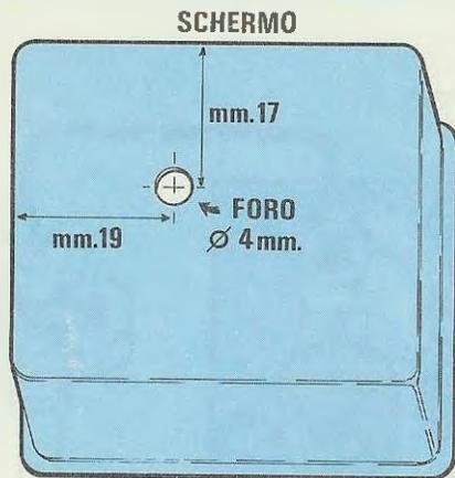
Fig.16 La semiscatola di lamiera stagnata che troverete nel kit, andrà posta sullo stampato LX.1030 nella posizione tratteggiata, in modo da schermare tutti i componenti sottostanti. I quattro terminali posti su tale perimetro serviranno per collegare alla massa dello stampato questo schermo metallico.
