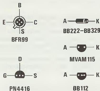
**Fig.15** Connessioni viste da sotto del fet PN4416, del transistor BFR99 e dei diodi varicap. I diodi varicap BB.222 e BB.329 hanno un corpo cilindrico, mentre il diodo varicap BB.112 (equivalente al MVAM.115) ha il corpo della stessa forma di un transistor.
