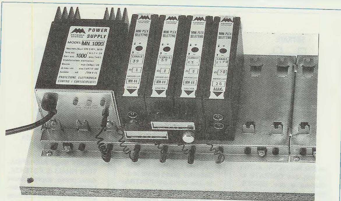
**Fig.362** Per realizzare una centralina, dovrete innestare in una piastra metallica completa di gancio di fissaggio tutti i **FILTRI ATTIVI** richiesti. Una volta innestati, dovrete serrare la vite presente in ciascun Filtro non solo per bloccarli, ma anche per far giungere ad essi il negativo della tensione di alimentazione.
