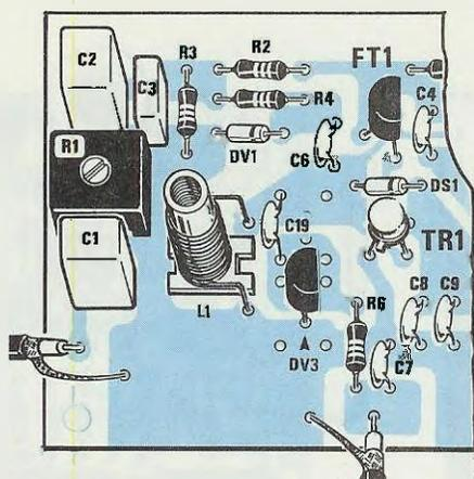
**Fig.14** Chi realizzerà questo VFO per le gamme che richiedono un solo diodo tipo BB.112, dovrà rivolgere la parte piatta del suo corpo verso il transistor TR1. Anche in questo caso il condensatore ceramico C19 posto in serie al varicap è da 1.000 pF.
