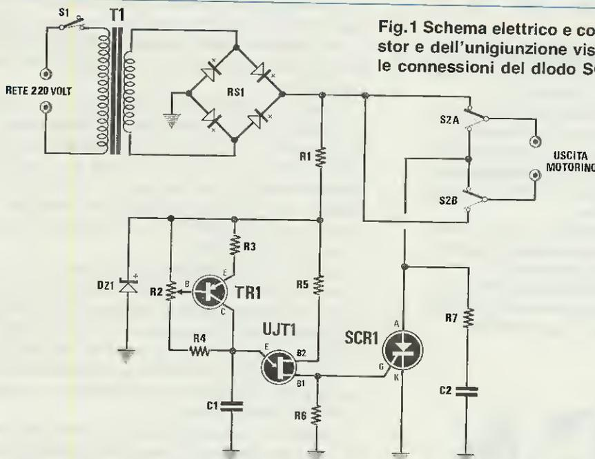
Fig.1 Schema elettrico e connessioni del transistor e dell'unigiunzione visti da sotto. In basso le connessioni del diodo SCR.
