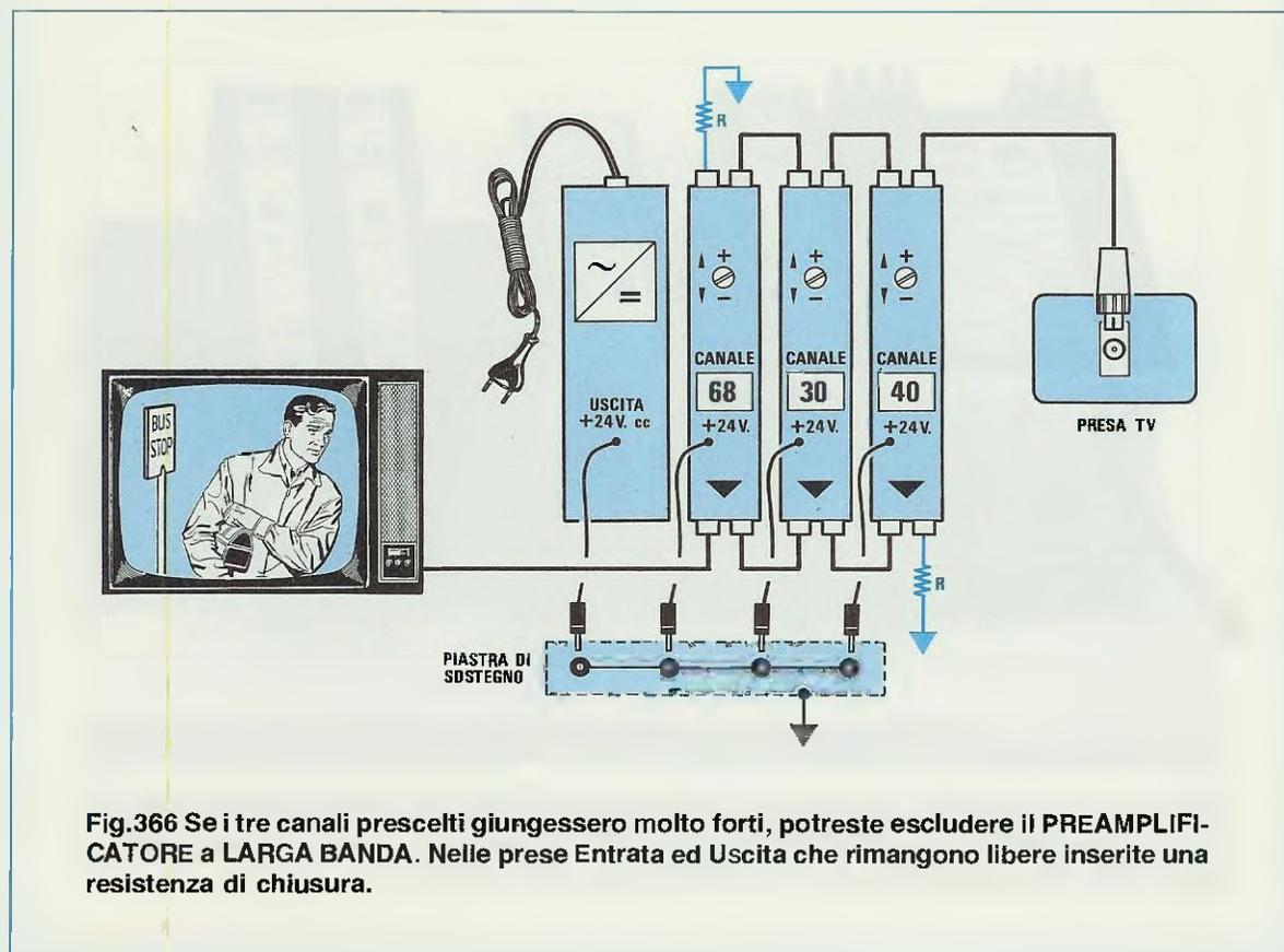
Fig.366 Se i tre canali prescelti giungessero molto forti, potreste escludere il PREAMPLIFICATORE a LARGA BANDA. Nelle prese Entrata ed Uscita che rimangono libere inserite una resistenza di chiusura.
