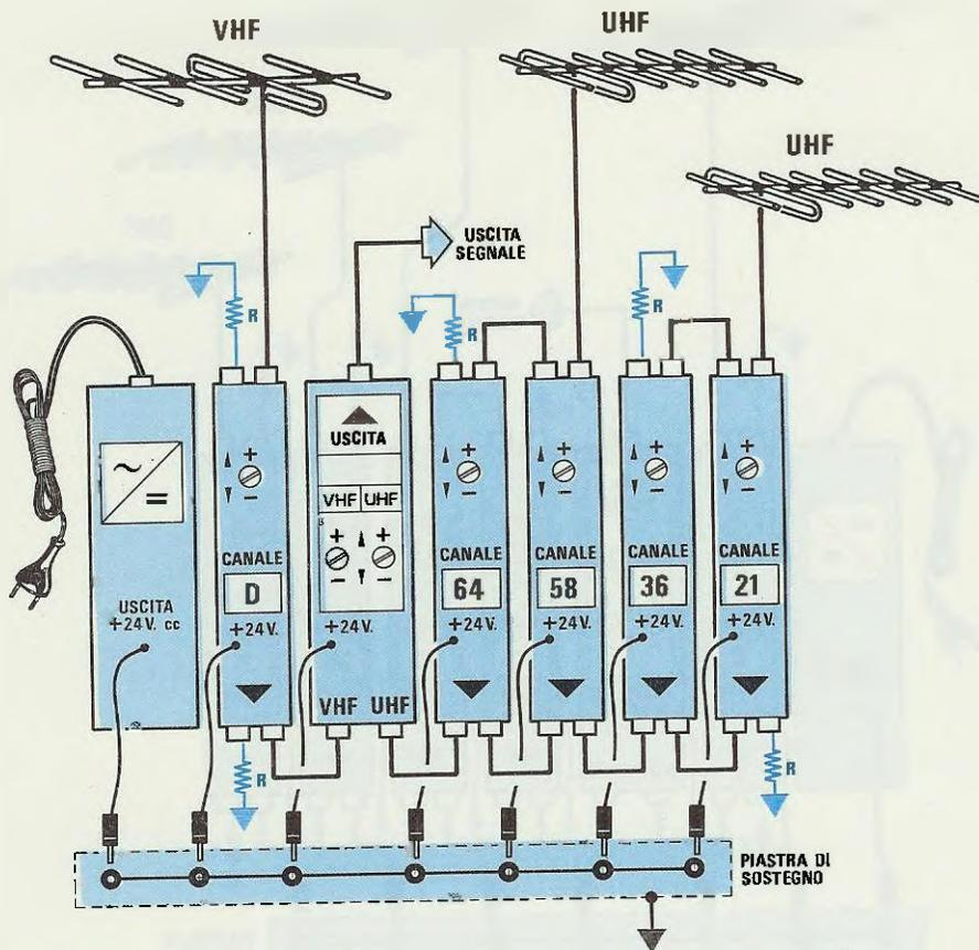
**Fig.370** Se da una direzione giungeranno i segnali dei canali 21-36 e da un'altra direzione i segnali dei canali 58-64, dovreste installare due antenne. Come potete vedere in questo disegno, nelle prese di ciascun Filtro che rimarranno "libere" dovreste inserire una resistenza di carico da 75 ohm.
