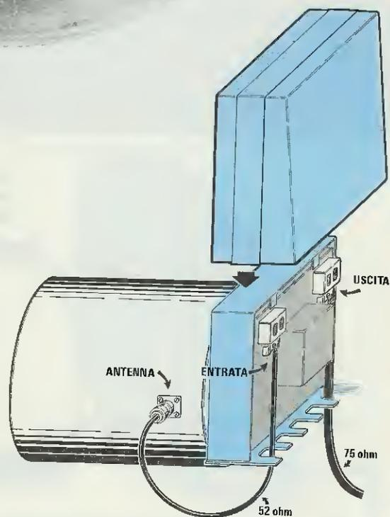
**Fig.3** Il cavetto coassiale da 52 ohm collegato all'antenna posta all'interno del barattolo, andrà collegato alla morsettiere ENTRATA. Dalla morsettiere USCITA si scenderà verso il ricevitore con una cavo coassiale per TV da 75 ohm.
