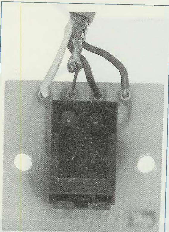
**Fig.2** Foto notevolmente ingrandita del pulsante che ci permetterà, come spiegato nell'articolo, di comporre la combinazione per eccitare o diseccitare il relè. In tale pulsante dovreste applicare due diodi led come visibile in fig.5.
