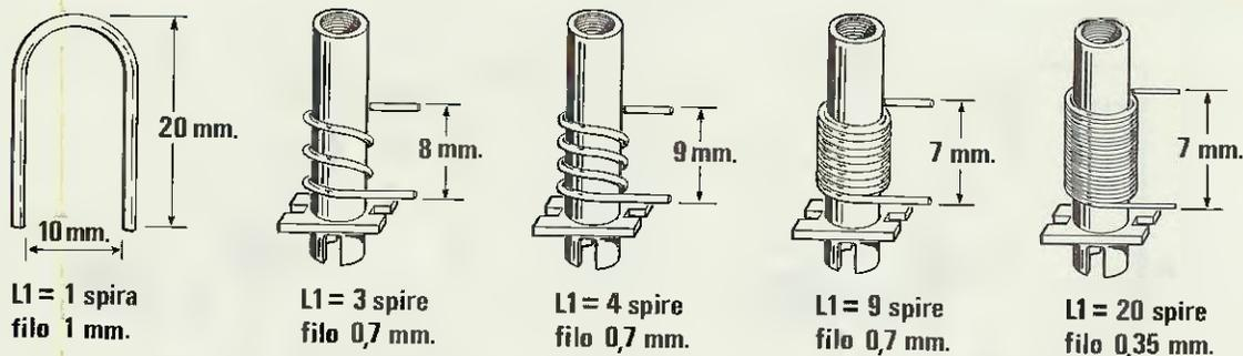
**Fig. 8** Per la sola gamma che copre da 179-220 MHz dovreste utilizzare, per la bobina L1, una spira a U (nel disegno sono riportate le dimensioni), mentre per le altre gamme dovreste avvolgere sul supporto plastico fornito nel kit, il numero di spire indicato nelle tabelle, servendovi del filo di rame smaltato del diametro richiesto. Consigliamo di bloccare le spire con una goccia di cera o collante per impedire vibrazioni meccaniche.
