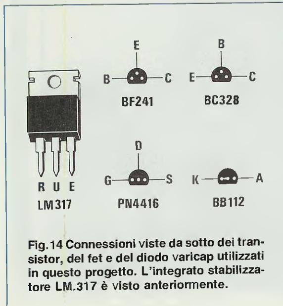
Fig.14 Connessioni viste da sotto dei transistor, del fet e del diodo varicap utilizzati in questo progetto. L'integrato stabilizzatore LM.317 è visto anteriormente.
