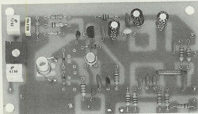
**Fig.3** Foto del VFO visto dal lato dei componenti. Come abbiamo spiegato nell'articolo, la bobina **L1**, i diodi varicap ed il condensatore **C10** andranno scelti in funzione della gamma di frequenze alla quale si desidera operare.
