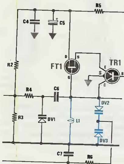
Fig.6 A chi desidera realizzare dei VFO per le gamme da 15 MHz fino a 36 MHz, consigliamo di scegliere questa configurazione che utilizza due diodi varicap BB.329 posti in parallelo. Il condensatore C19 che collega questi due diodi varicap al Collettore di TR1 deve risultare da 1.000 pF ceramico. Per C10 consigliamo una capacità di 22 - 27 picofarad.
