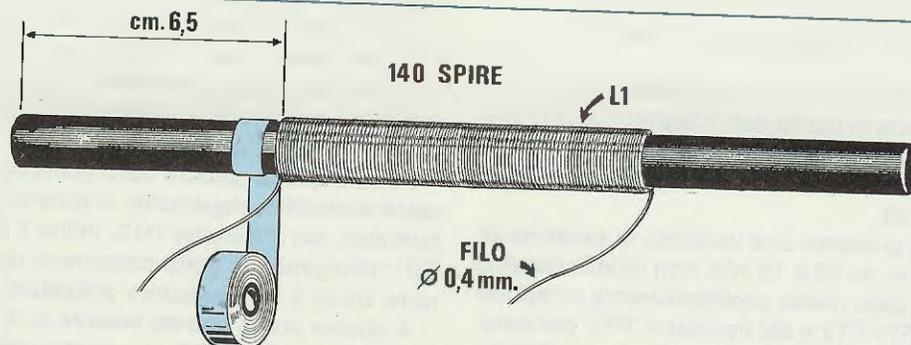
Fig.11 Sul nucleo in ferrite dovreste avvolgere circa 140 spire con filo smaltato da 0,4 mm. Le due estremità di questo avvolgimento andranno bloccate con un giro di nastro adesivo.
