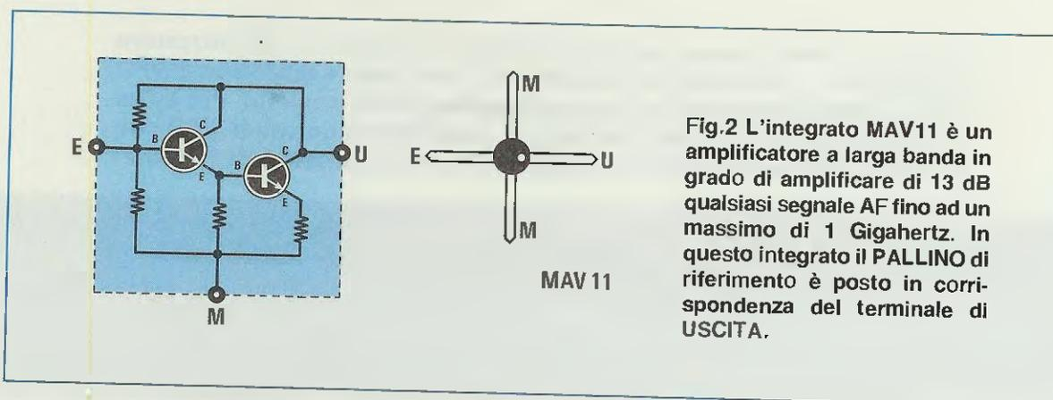
Fig.2 L'integrato MAV11 è un amplificatore a larga banda in grado di amplificare di 13 dB qualsiasi segnale AF fino ad un massimo di 1 Gigahertz. In questo integrato il PALLINO di riferimento è posto in corrispondenza del terminale di USCITA.
