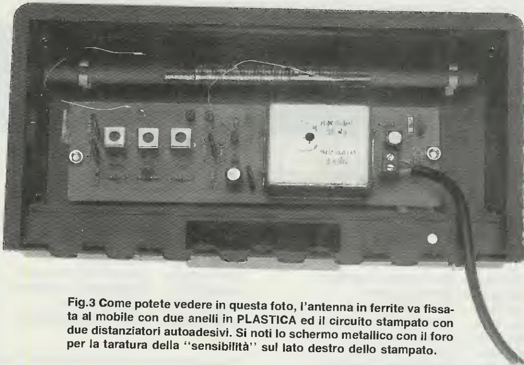
**Fig.3** Come potete vedere in questa foto, l'antenna in ferrite va fissata al mobile con due anelli in PLASTICA ed il circuito stampato con due distanziatori autoadesivi. Si noti lo schermo metallico con il foro per la taratura della "sensibilità" sul lato destro dello stampato.
