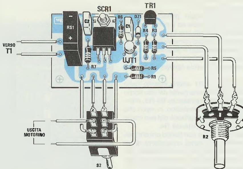
**Fig.4** Schema pratico di montaggio del variatore di tensione in continua. Si notino le connessioni del deviatore S2 utilizzato per invertire la marcia del trenino. L'interruttore S1, come rappresentato in fig.1, andrà collegato alla rete di alimentazione.
