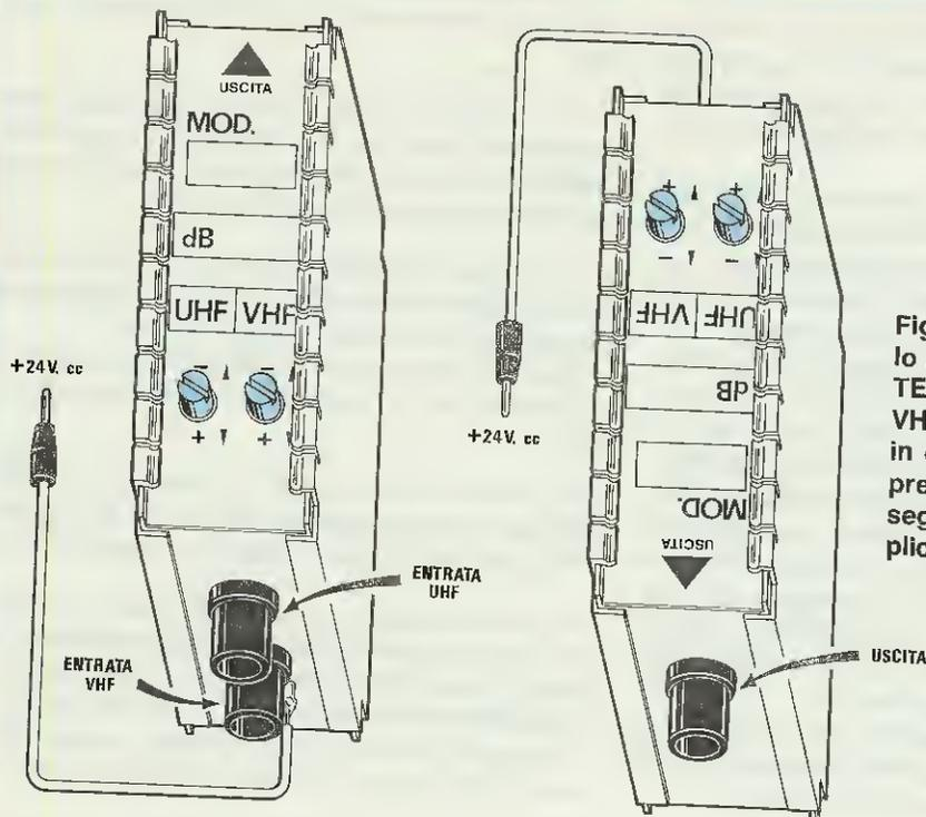
Fig.367 Disegno del modulo AMPLIFICATORE di POTENZA con i due ingressi VHF-UHF separati. Dal lato in cui è presente una sola presa dovreste prelevare il segnale amplificato da applicare alla linea di discesa.
