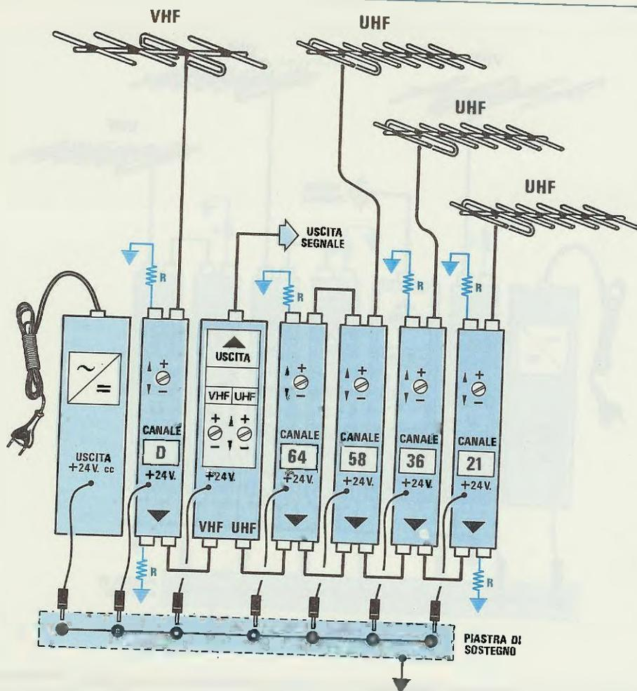
Fig.372 Se da una direzione giungeranno i segnali dei soli canali 58-64, da un'altra ancora il solo canale 21, vi serviranno 3 antenne UHF. Notate come nei filtri ai quali giunge un solo canale, la seconda presa d'ingresso viene chiusa con una R da 75 ohm.
