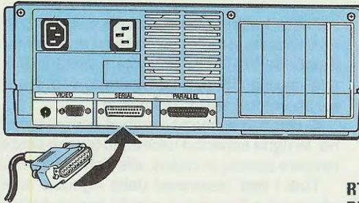
Fig.7 Il connettore a 25 poli andrà innestato nella presa "seriale" posta sul retro di ogni computer. Se mancasse tale connettore, ne troverete uno a 9 poli (vedi fig.9).
