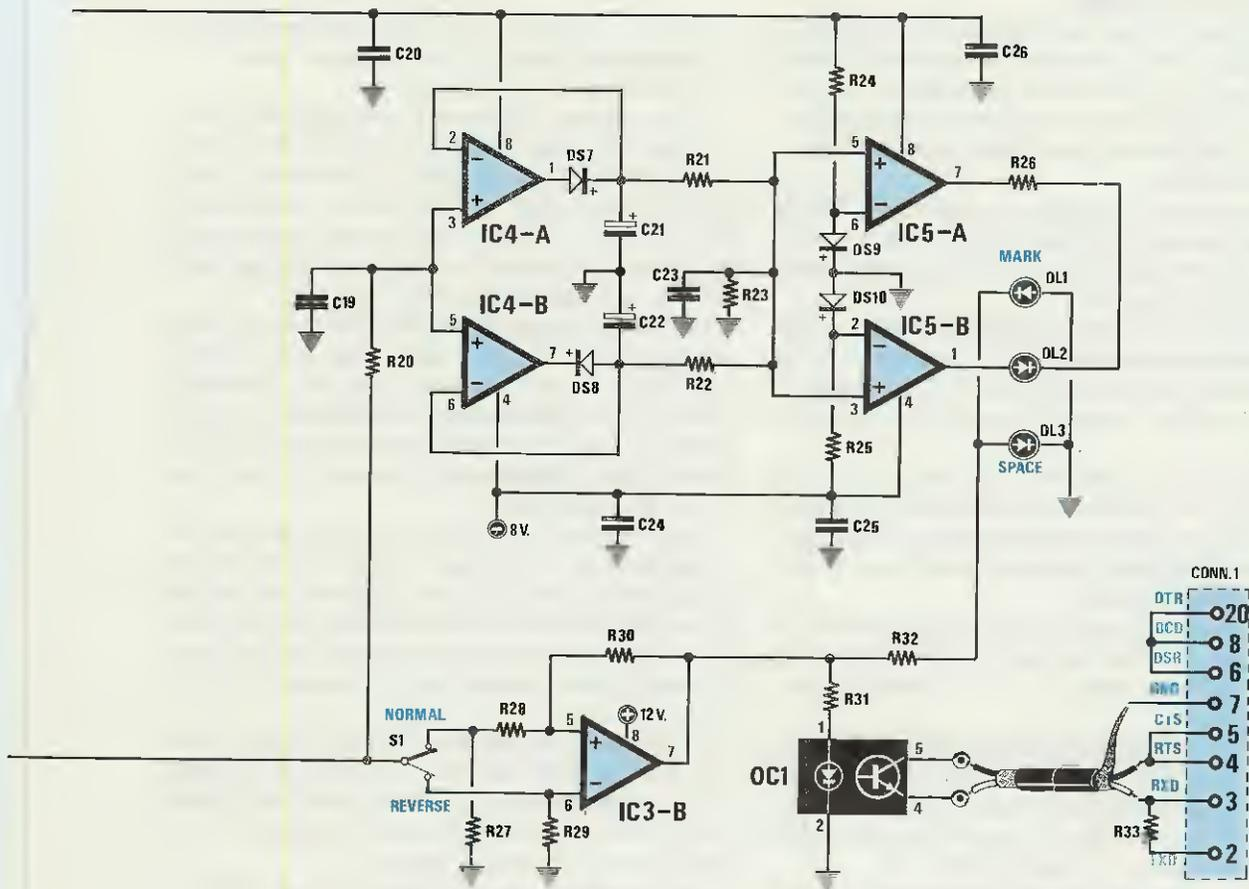
I numeri riportati sul CONN1 visibile in basso a destra, si riferiscono a quelli di un connettore a 25 poli (vedi fig.8). Se nel vostro computer è presente un connettore a 9 poli, prendete come riferimento le sigle DTR-DCD-DSR-GND-CTS-RTS-RXD-TXD (vedi fig.9).
