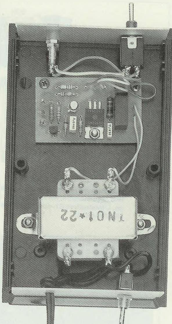
Fig.6 Ecco come abbiamo predisposto all'interno del mobile il circuito stampato ed il relativo trasformatore di alimentazione. Il potenziometro R2 andrà fissato sul coperchio (vedi foto inizio articolo).
