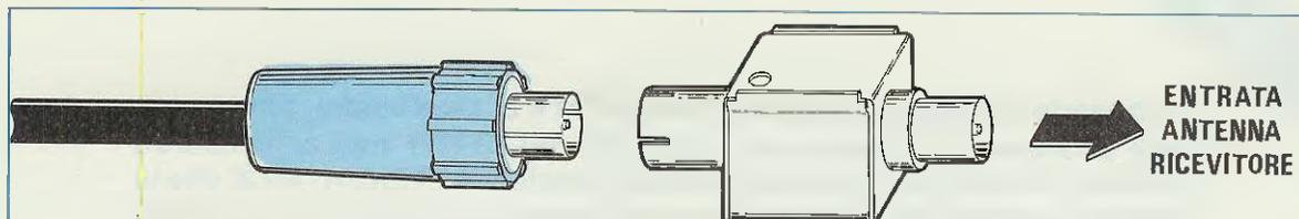
**Fig.4** Poichè questo nuovo convertitore ha un guadagno di 50 dB, cioè molto elevato, se avete una linea di discesa piuttosto corta, vi consigliamo di applicare tra lo spinotto terminale del cavo e l'ingresso "antenna" del ricevitore, l'ATTENUATORE da 15 dB visibile in figura. Se avete una discesa molto lunga, o un ricevitore poco sensibile, tale attenuatore lo potrete escludere.
