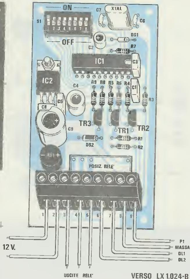
**piedini 3-4-5** = questi piedini sono le uscite del relè. Se utilizzerete i terminali 3-4, il **contatto** risulterà chiuso a relè diseccitato e aperto a relè eccitato. Se userete i terminali 4-5, il **contatto** risulterà aperto a relè diseccitato e chiuso a relè eccitato.
