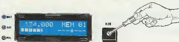
Fig.35 Ruotate il trimmer R28 a metà corsa, poi il nucleo della MF3 fino a portare la "barra" dell'AFC al centro scala.
