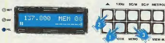
Fig. 55 Pigiando il tasto 100K e i tasti P1 e P2 ci sintonizzeremo sulla nuova frequenza e poi pigieremo il tasto MEM.
