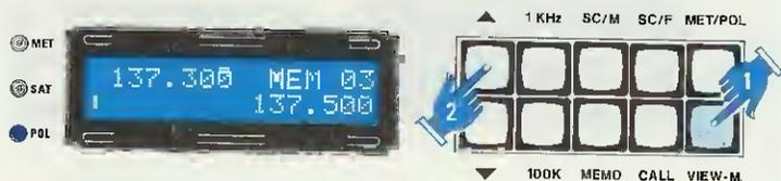
Fig. 59 A questo punto dovremo pigiare il tasto CALL ed il ricevitore si sintonizzerà sul canale richiesto.
