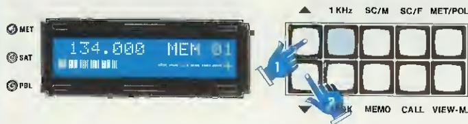
Fig.34 Per tarare la MF3 dovrete pigiare i tasti P1 - P2 fino a far deviare verso il suo massimo le "barre" dell'S-Meter.
