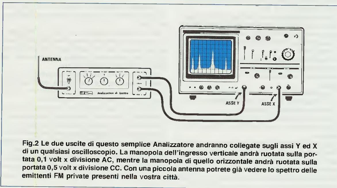
**Fig.2** Le due uscite di questo semplice Analizzatore andranno collegate sugli assi Y ed X di un qualsiasi oscilloscopio. La manopola dell'ingresso verticale andrà ruotata sulla portata **0,1 volt x divisione AC**, mentre la manopola di quello orizzontale andrà ruotata sulla portata **0,5 volt x divisione CC**. Con una piccola antenna potrete già vedere lo spettro delle emittenti FM private presenti nella vostra città.
