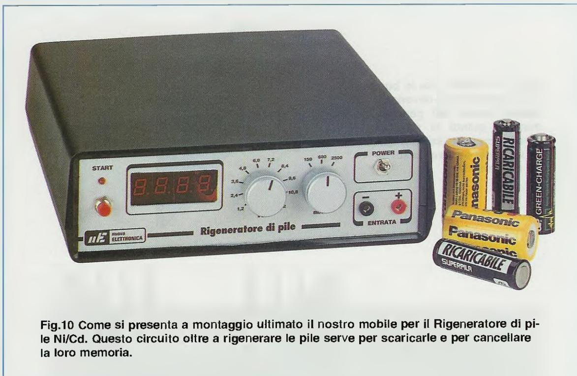
**Fig.10** Come si presenta a montaggio ultimato il nostro mobile per il Rigeneratore di pile Ni/Cd. Questo circuito oltre a rigenerare le pile serve per scaricarle e per cancellare la loro memoria.
