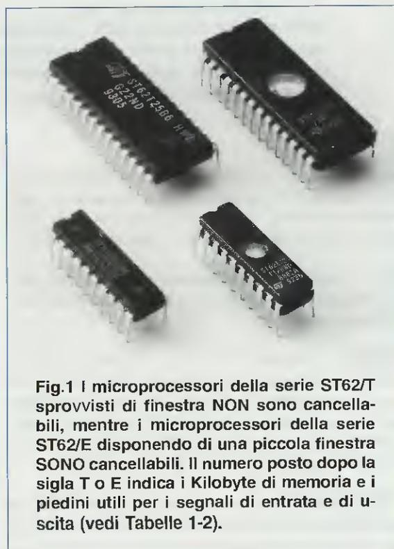
**Fig.1** I microprocessori della serie **ST62/T** sprovvisti di finestra **NON** sono cancellabili, mentre i microprocessori della serie **ST62/E** disponendo di una piccola finestra **SONO** cancellabili. Il numero posto dopo la sigla **T** o **E** indica i **Kilobyte** di memoria e i piedini utili per i segnali di entrata e di uscita (vedi Tabelle 1-2).
