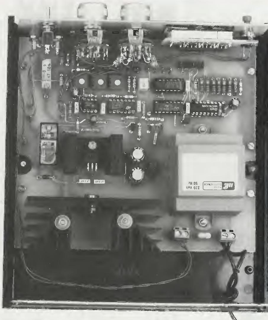
Fig.2 In questa foto vedete l'interno del mobile plastico con inserito lo stampato. Sul pannello frontale sono fissati l'interruttore d'accensione S3, i due commutatori S1-S2, il pulsante di start e le due bocche per la pila.
