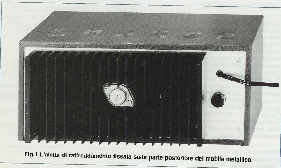
Fig.1 L'aletta di raffreddamento fissata sulla parte posteriore del mobile metallico.
