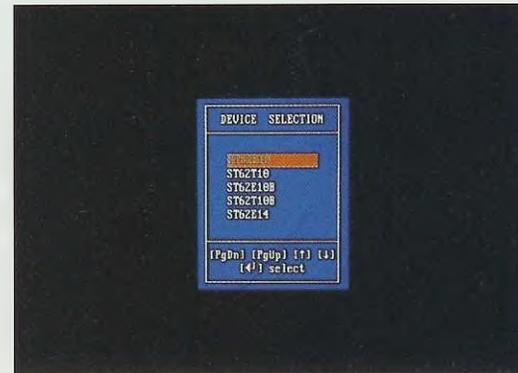
Fig.19 Sullo schermo apparirà una lista con tutti i tipi di ST6 che potete programmare e che sono circa 20. Per selezionare la sigla del vostro microprocessore usate i tasti freccia su e giù.
