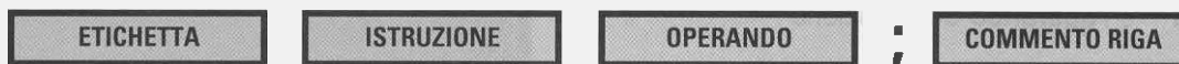
Fig.7 Dovrete sempre ricordare che ogni "riga" di programma è composta da quattro blocchi principali: Etichetta - Istruzione - Operando - Commento. I primi tre blocchi andranno tenuti separati tra loro da uno o più SPAZI (o ancora meglio usate il tasto TAB della tastiera), mentre l'ultimo blocco del COMMENTO dovrà essere separato da un punto e virgola. Se non userete l'ETICHETTA dovete comunque lasciare uno o più spazi, mentre se non scriverete il COMMENTO non dovrete mettere il punto e virgola.
