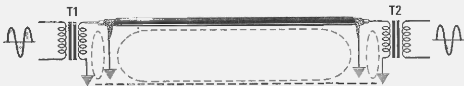
Fig.2 Utilizzando un filo "schermato" per trasferire il segnale dal secondario di T1 al primario di T2, non riuscirete sempre ad evitare che questo capti del ronzio, perché se collegate la calza di schermo su due punti di "massa" molto distanti tra loro, creerete delle invisibili "spire" capaci di captare del ronzio per via induttiva.
