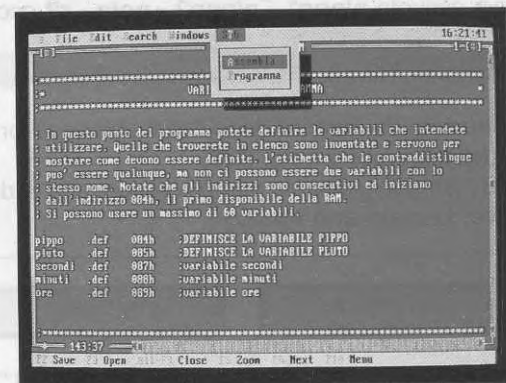
Fig.6 Una volta completato il programma prima di memorizzarlo nell' ST6 lo dovete Assemblare . Premete quindi i tasti ALT+T poi il tasto A . Se avete commesso un errore nel programma, vi verrà segnalato.
