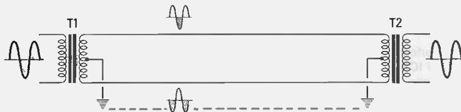
Fig.5 Se il secondario del trasformatore T1 ed il primario di T2 disponessero di una presa "centrale", si avrebbero due fili percorsi da un segnale BF in OPPOSIZIONE di FASE. Così anche se la calza metallica o i due fili interni captassero del ronzio di alternata, questo entrando sul primario di T2 in fase verrebbe automaticamente annullato.
