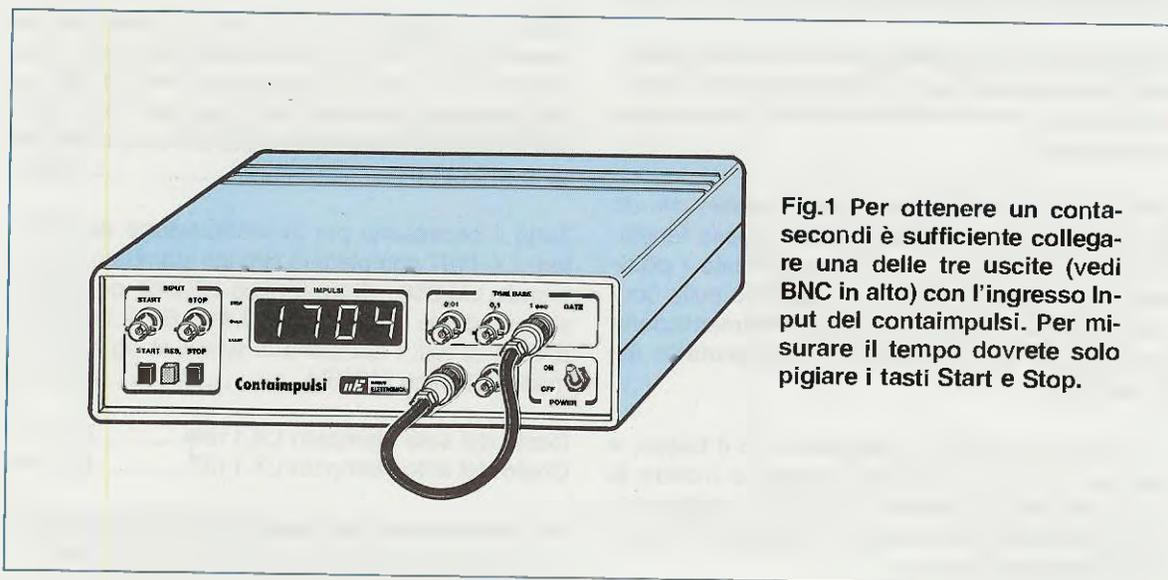
Fig.1 Per ottenere un **contasecondi** è sufficiente collegare una delle tre uscite (vedi **BNC** in alto) con l'ingresso **Input** del contaimpuls. Per misurare il tempo dovrete solo pigiare i tasti **Start** e **Stop**.
