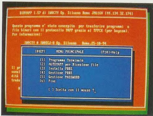
Fig.9 La maschera della fig.8 rimane sullo schermo per pochi secondi, dopodiché appare sullo schermo il MENU principale con la lista delle istruzioni del Binyapp.
