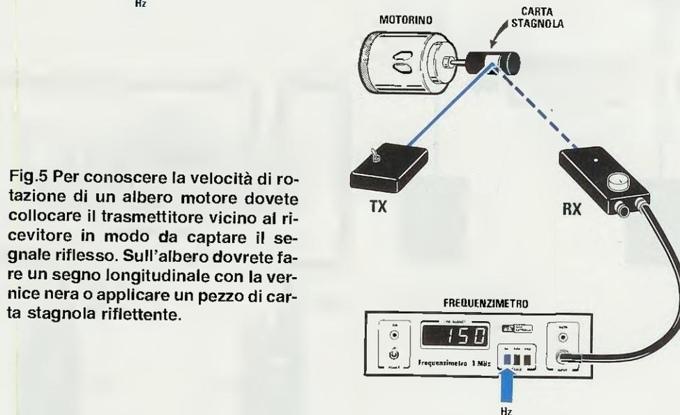
Fig.5 Per conoscere la velocità di rotazione di un albero motore dovete collocare il trasmettore vicino al ricevitore in modo da captare il segnale riflesso. Sull'albero dovete fare un segno longitudinale con la vernice nera o applicare un pezzo di carta stagnola riflettente.
