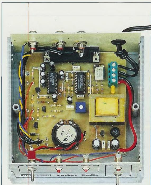
Fig.1 Qui sopra la foto del circuito LX.1184 montato all'interno del suo mobile, e nella pagina in alto a sinistra presentano la parte frontale e quella posteriore del mobile plastico complete di mascherine, che vi forniremo già forate e serigrafate.
