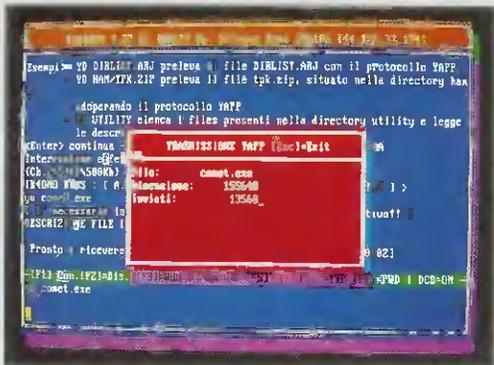
Fig.16 Durante la trasmissione appare questa finestra con il nome del file, la sua dimensione in byte e quanti byte sono già stati trasmessi al vostro corrispondente.
