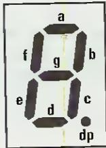
Fig.1 Sul piedino 22 dell'integrato M.5450 giunge un primo bit di Start. A questo seguono 32 bit per accendere i segmenti del display, 2 bit per accendere i led e 2 bit di fine caricamento. I sette segmenti del display sono identificati da una lettera (vedi A-B-C-D-E-F-G) quindi per visualizzare il numero 7 dovrete alimentare i segmenti A-B-C e per visualizzare il numero 3 dovrete alimentare i segmenti A-B-G-C-D.
