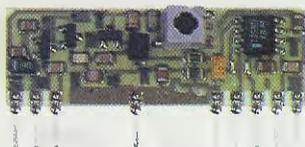
**Fig.2** Questo modulo in SMD, utilizzato nello stadio ricevente, è un sensibile superrigenerativo accordato sulla gamma dei 434 MHz. Sull'ingresso di questo modulo è presente uno stadio preamplificatore cascode.
