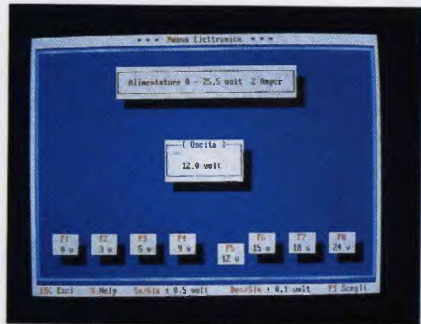
Fig.15 Se ad esempio volete ottenere in uscita una tensione di 12 volt, sarà sufficiente premere il tasto funzione F5.
