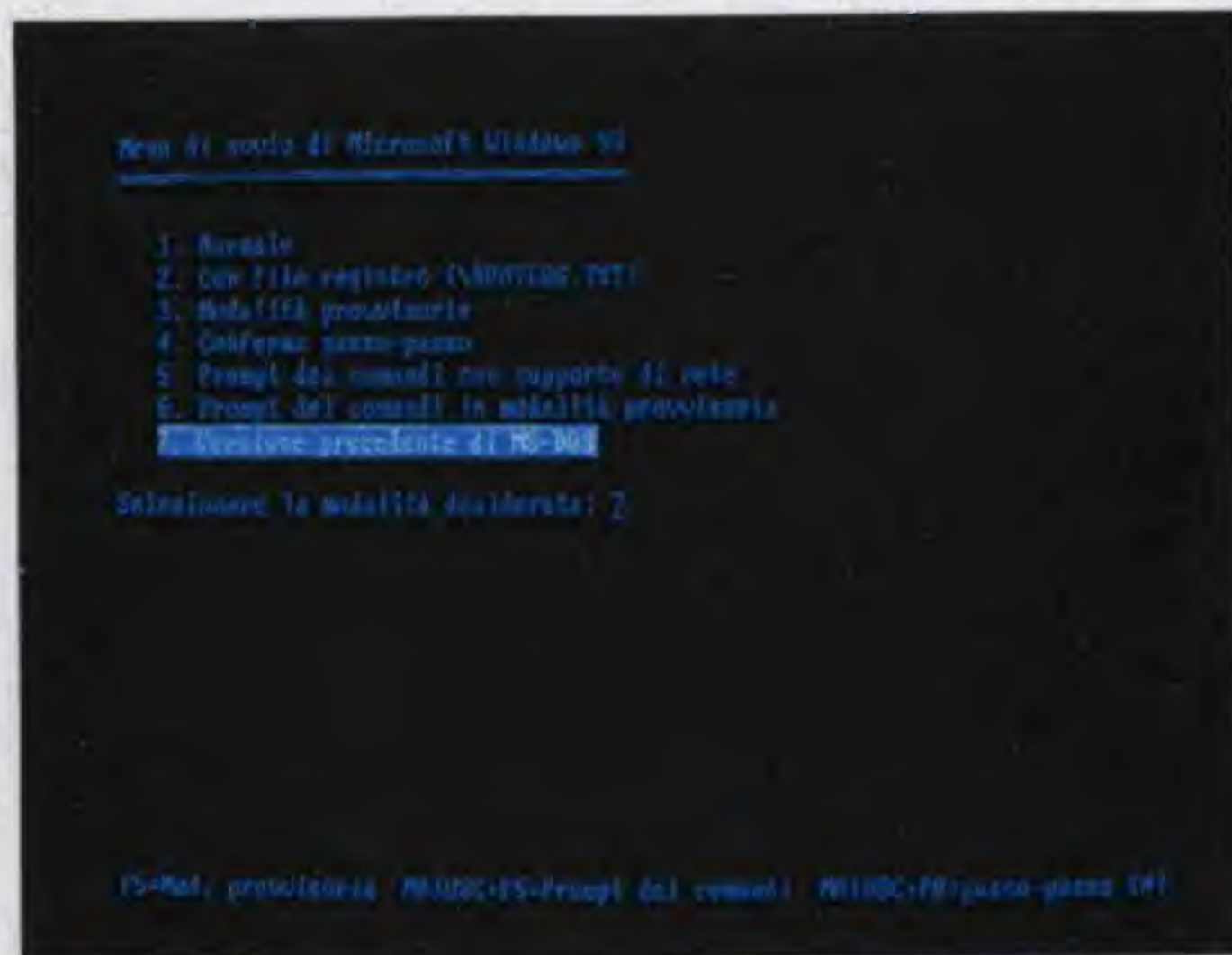
Fig.3 In questa finestra portate il cursore nella riga 7 poi pigiate Enter in modo da caricare nel computer l'MS-DOS 6.2.
