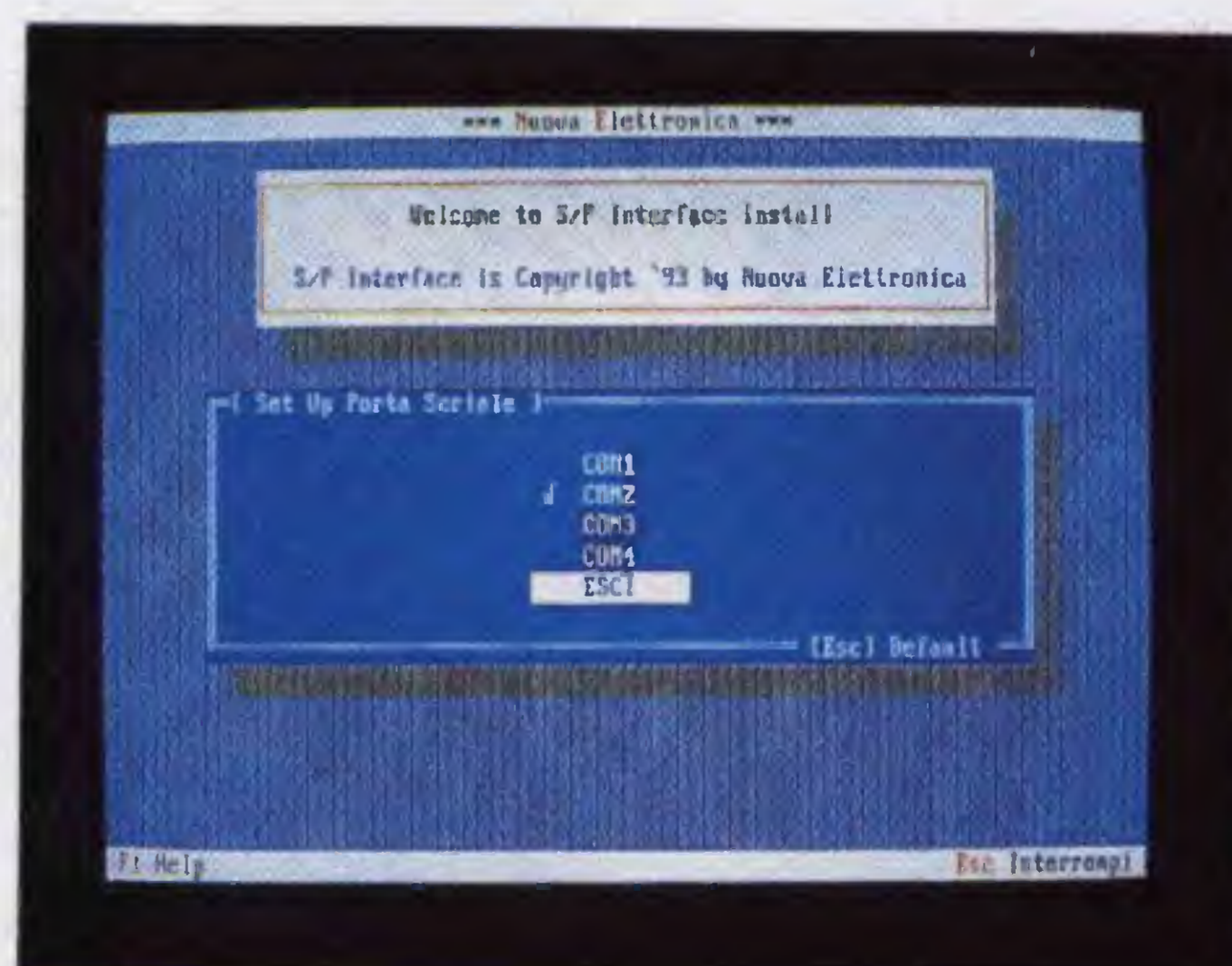
Fig.12 Dopo aver selezionato la COM d'ingresso portate il cursore sulla scritta ESC1, poi premete Enter per la conferma.
