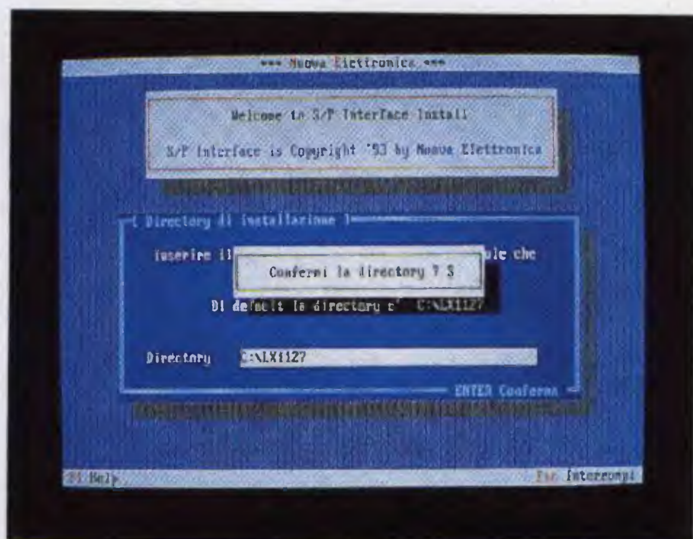
Fig.9 Quando sul monitor appare questa scritta, per confermare questa directory potete premere il tasto S oppure Enter.
