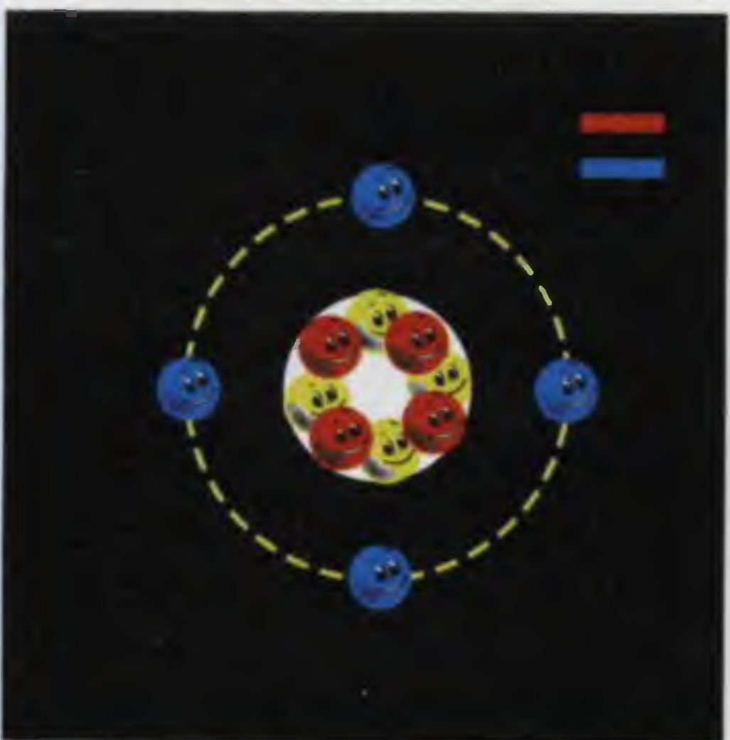
Fig.6 Quando il numero degli Elettroni è equivalente al numero dei Protoni la carica è Neutra.
