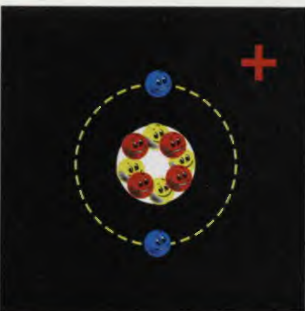
Fig.7 Se in un atomo si tolgono degli Elettroni questo assume una carica elettrica Positiva.
