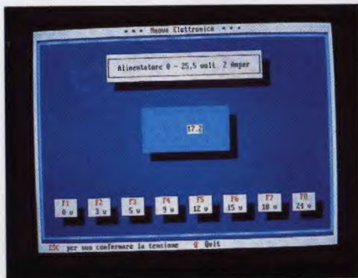
Fig.21 Il valore della tensione deve essere di 3 cifre: per avere 9,5 volt scrivete 095, per avere 17,2 volt scrivete 172.
