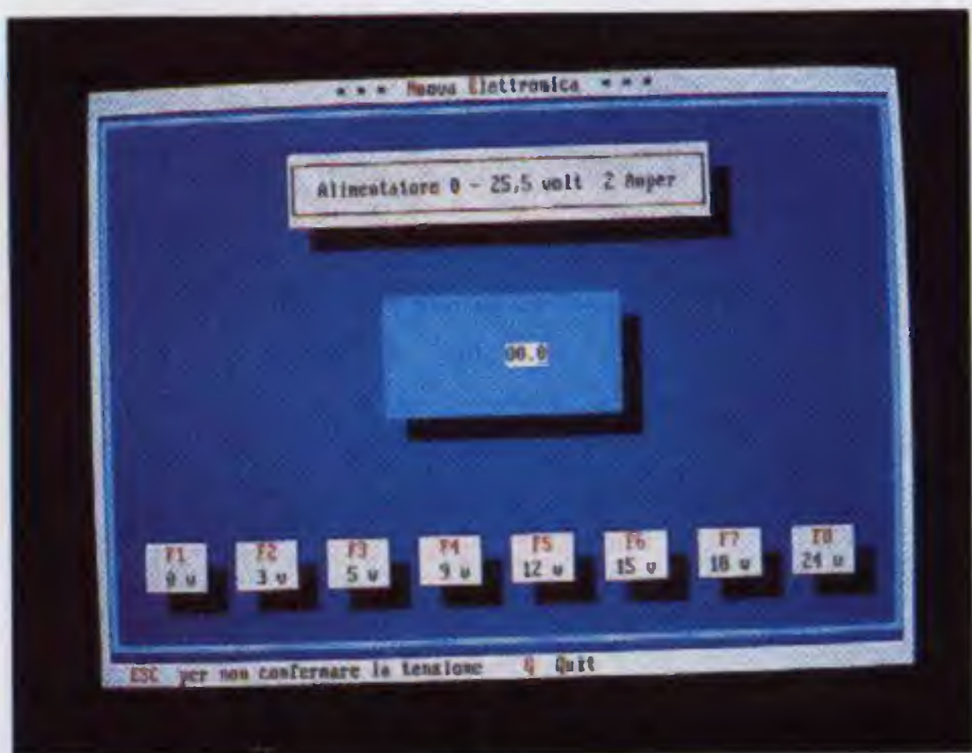
Fig.20 Per ottenere una tensione diversa dalle otto da noi prefissate, premete F9, poi scrivete il nuovo valore prescelto.
