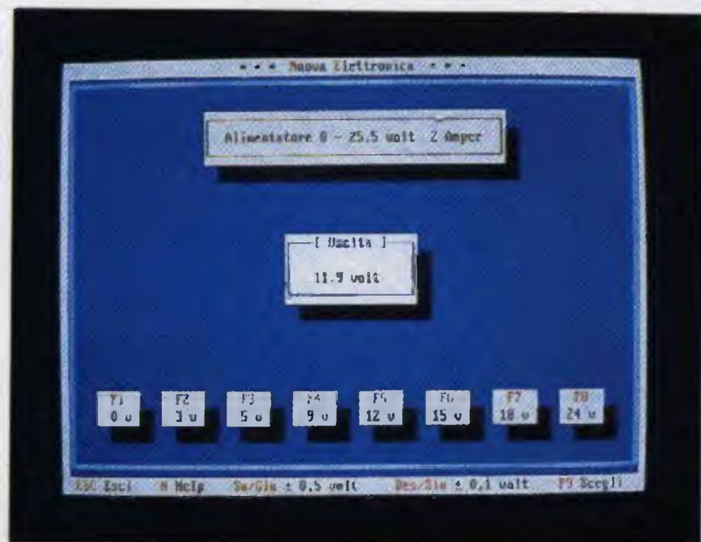
Fig.17 Se volete ridurre la tensione sempre con passi di 0,1 volt, dovrete premere il tasto freccia Sinistra.
