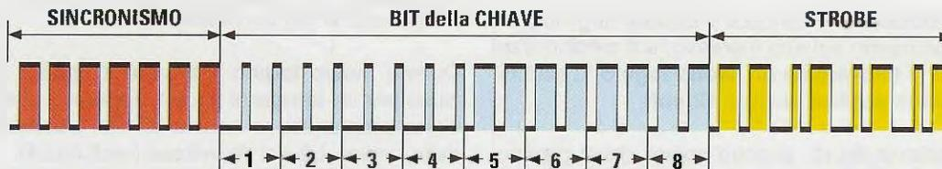
**Fig.8** In questo disegno, la forma degli impulsi codificati (vedi colore Blu) che escono dal piedino 17 dell'Encoder HT.6014 (vedi fig.2) dopo aver posizionato le prime 4 levette del dip-switch sul + e le ultime 4 levette sul - (vedi fig.4). I primi impulsi di colore Rosso sono quelli del Sincronismo e gli ultimi, di colore Giallo, sono quelli dello Strobe.
