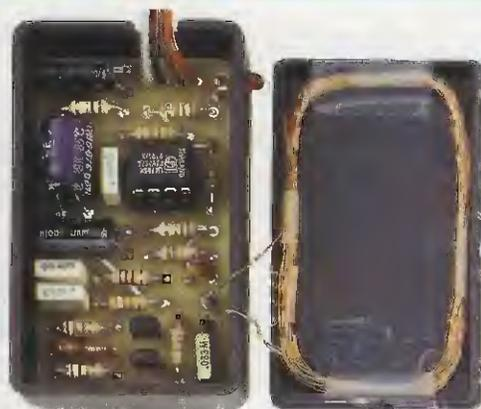
**Fig.20** Stadio RX-Decoder LX.1528/B (vedi fig.15 in alto a sinistra), che utilizzerete come “serratura” per riconoscere il codice “chiave” che la bobina L1 del TX-Encoder invierà sulla bobina L2. Troverete la bobina L2 già incollata sul coperchio del mobile plastico utilizzato per accogliere il circuito stampato LX.1528/B. Vi ricordiamo nuovamente di posizionare le 8 levette del dip-switch dello stadio trasmittente nello stesso modo in cui sono posizionate le levette dello stadio ricevente.
