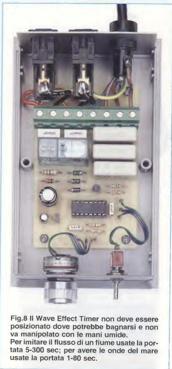
**Fig.8 Il Wave Effect Timer non deve essere posizionato dove potrebbe bagnarsi e non va manipolato con le mani umide. Per imitare il flusso di un fiume usate la portata 5-300 sec; per avere le onde del mare usate la portata 1-80 sec.**
