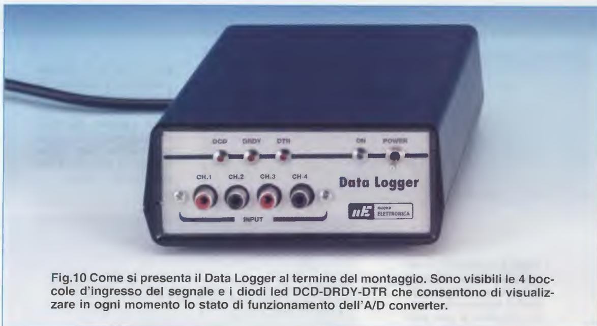
Fig.10 Come si presenta il Data Logger al termine del montaggio. Sono visibili le 4 boccole d'ingresso del segnale e i diodi led DCD-DRDY-DTR che consentono di visualizzare in ogni momento lo stato di funzionamento dell'A/D converter.
