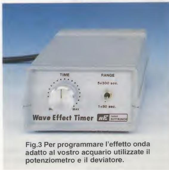
Fig.3 Per programmare l'effetto onda adatto al vostro acquario utilizzate il potenziometro e il deviatore.
