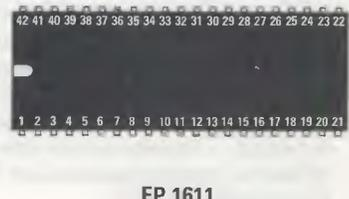
Fig.5 In figura sono riprodotte le connessioni degli integrati 4066-AD232-AD7715-EP1611 viste da sopra e la rispettiva tacca di riferimento. Come potete notare il terminale più lungo del diodo led è l'anodo mentre il terminale più corto è il catodo.
