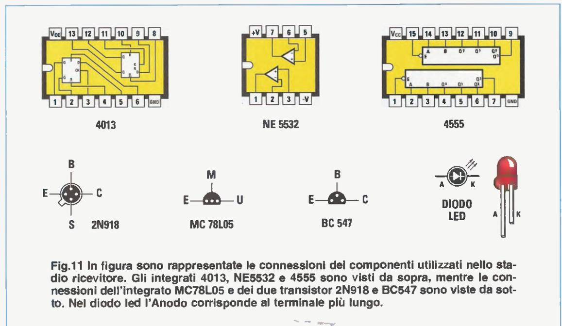
Fig.11 In figura sono rappresentate le connessioni dei componenti utilizzati nello stadio ricevitore. Gli integrati 4013, NE5532 e 4555 sono visti da sopra, mentre le connessioni dell'integrato MC78L05 e dei due transistor 2N918 e BC547 sono viste da sotto. Nel diodo led l'Anodo corrisponde al terminale più lungo.
