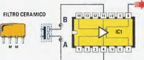
**Fig.13** Per conoscere la frequenza di lavoro di un Filtro Ceramico provvisto di 4 piedini, basterà collegare i due terminali esterni agli ingressi A-B e ruotare la sintonia del Generatore RF fino a quando non incontrerete la sua frequenza di accordo, che farà bruscamente salire la sua ampiezza da 0,5 quadretti a circa 7 quadretti.
