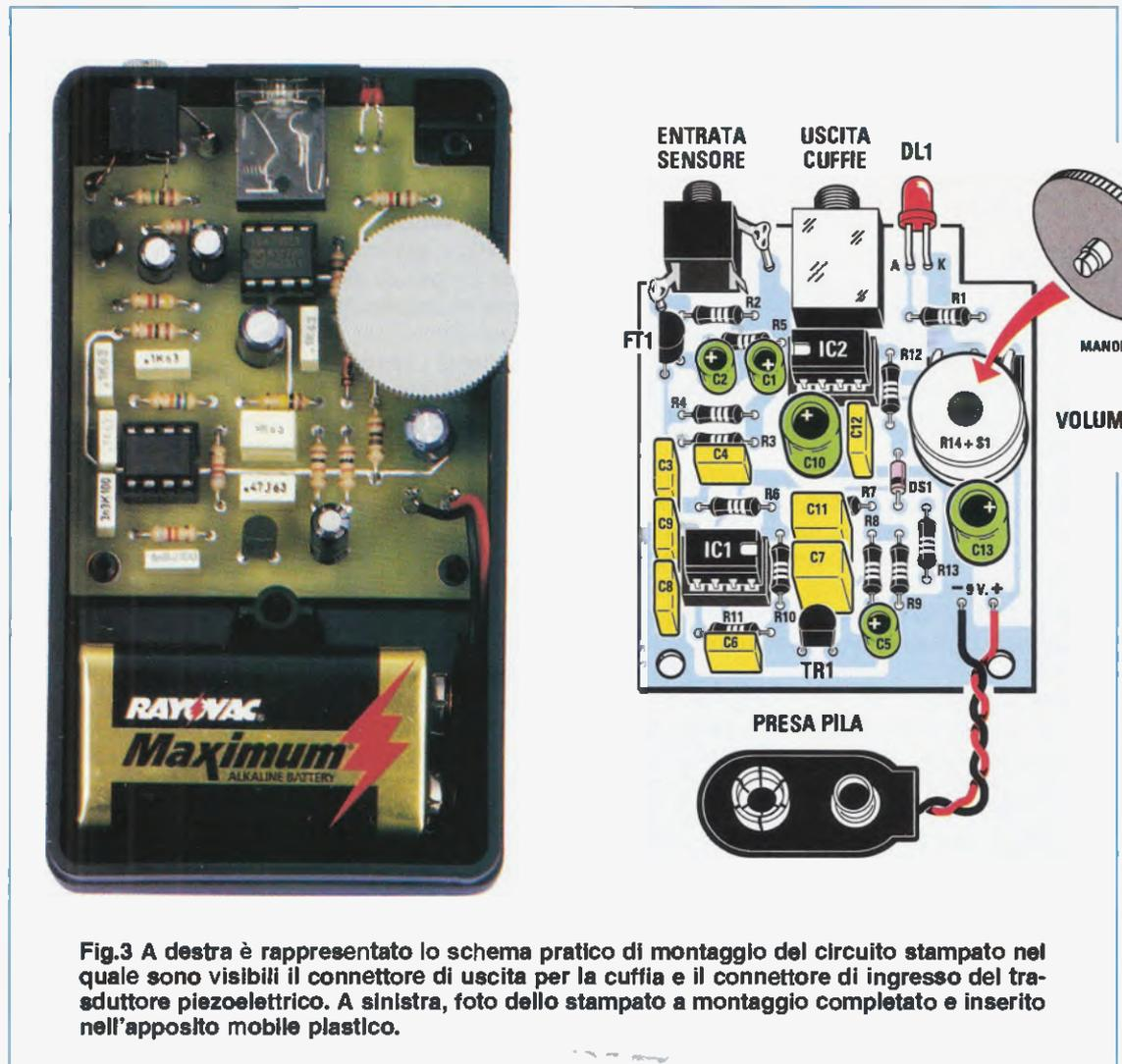
Fig.3 A destra è rappresentato lo schema pratico di montaggio del circuito stampato nel quale sono visibili il connettore di uscita per la cuffia e il connettore di ingresso del trasduttore piezoelettrico. A sinistra, foto dello stampato a montaggio completato e inserito nell'apposito mobile plastico.
