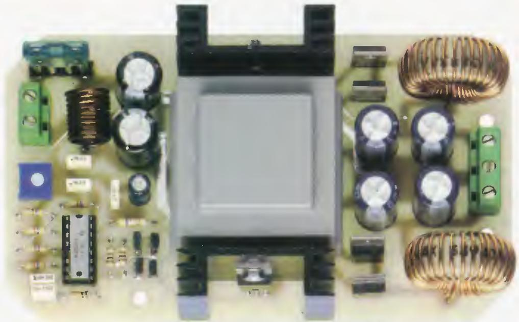
**Fig.6** Come si presenta il circuito dell'alimentatore a montaggio concluso. Come potete notare dalla fotografia, abbiamo potuto contenere le dimensioni delle alette di raffreddamento sulle quali sono avvitate i mosfet, perché, lavorando questi in commutazione, generano pochissimo calore e quindi non devono dissipare elevate potenze.
