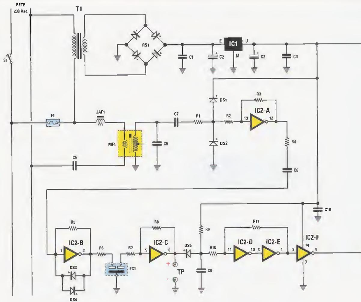
Fig.6 Schema elettrico del modulo ricevitore. Qui sopra è ben visibile il test point TP sul quale occorre prelevare il segnale da utilizzare nella procedura di taratura. Vi consigliamo di leggere in proposito il relativo paragrafo.
