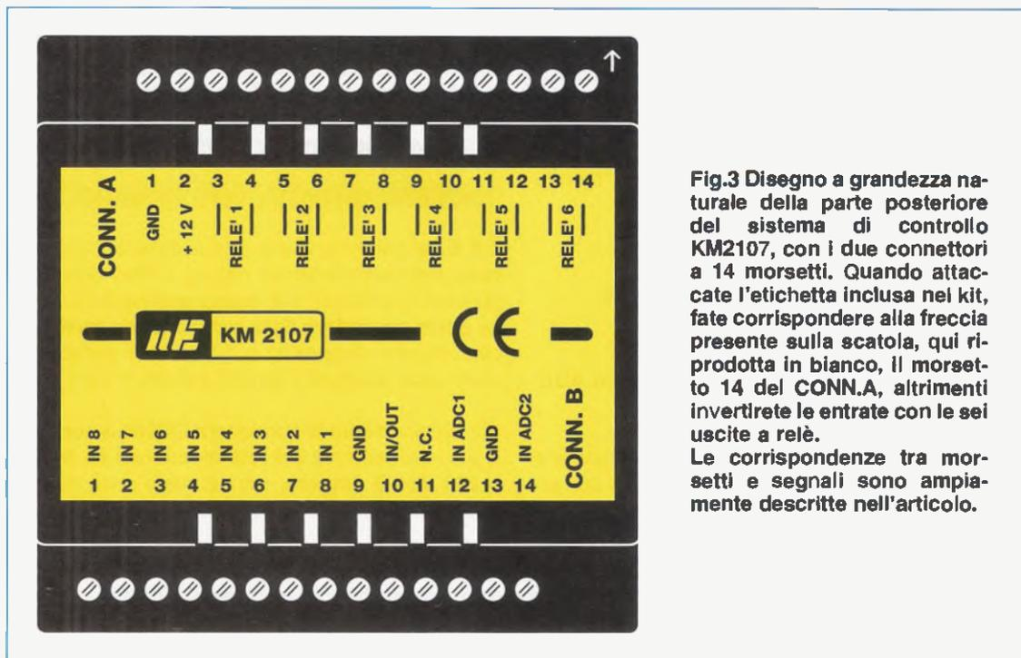
Fig.3 Disegno a grandezza naturale della parte posteriore del sistema di controllo KM2107, con i due connettori a 14 morsetti. Quando attaccate l'etichetta inclusa nel kit, fate corrispondere alla freccia presente sulla scatola, qui riprodotta in bianco, il morsetto 14 del CONN.A, altrimenti invertirete le entrate con le sei uscite a relè. Le corrispondenze tra morsetti e segnali sono ampiamente descritte nell'articolo.
