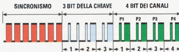
**Fig.2** Il segnale codificato dal trasmettitore è formato dai 7 bit di sincronismo, seguiti dai 3 bit della chiave e dai 4 bit dei pulsanti. I bit della chiave vengono programmati tramite i ponticelli J1-J2-J3 posti sul trasmettitore e sul ricevitore.
