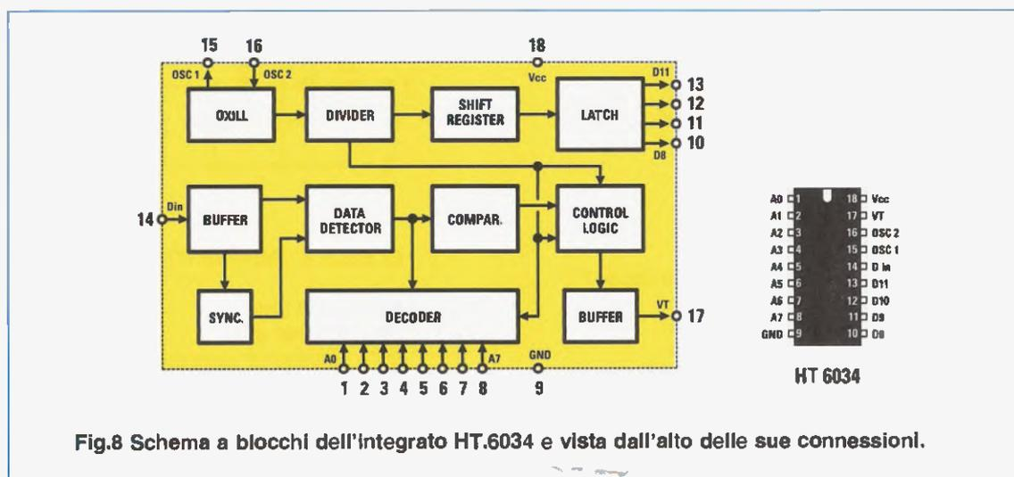
Fig.8 Schema a blocchi dell'integrato HT.6034 e vista dall'alto delle sue connessioni.
