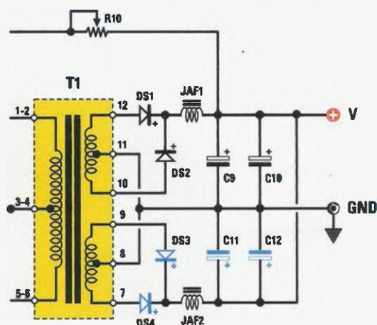
**Fig.8** Per adattare l'alimentatore **switching** di fig.3 in modo che fornisca in uscita una **tensione singola** compresa tra 5 e 32 volt, basta **invertire la polarità** dei componenti disegnati in **blu**: **DS3-DS4** e **C11-C12**.
