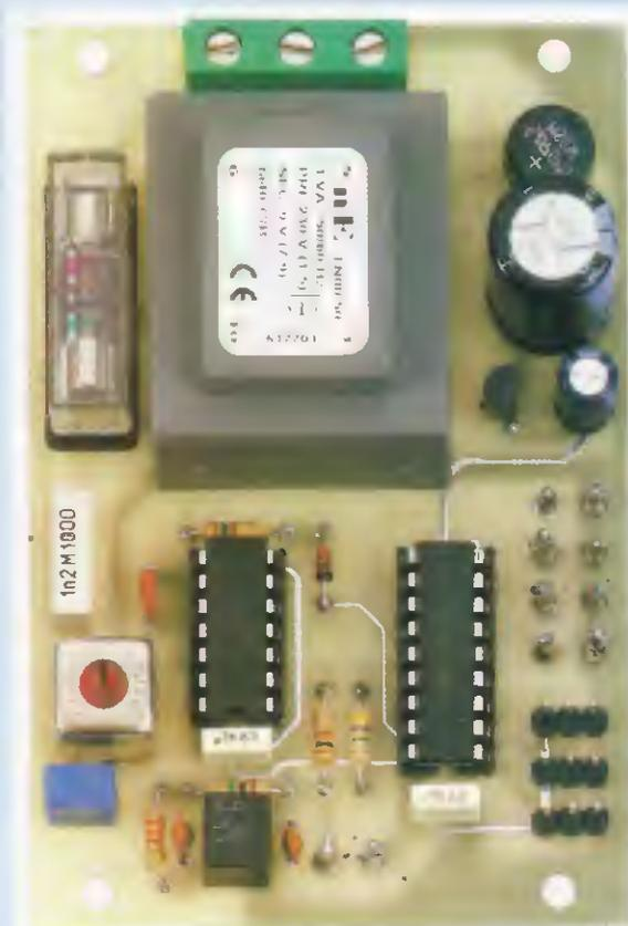
**Fig.10** Foto del circuito stampato del trasmettitore. A destra sono ben visibili gli 8 terminali predisposti per il collegamento con i 4 pulsanti P1-P2-P3-P4.
