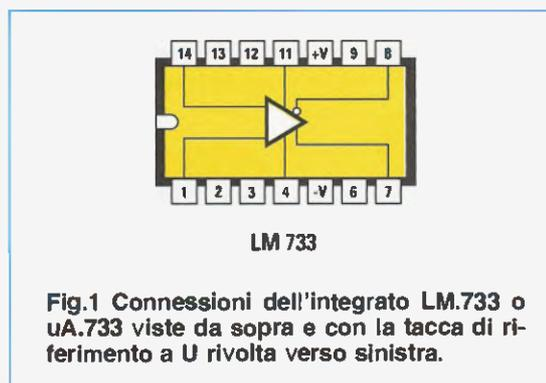
Fig.1 Connessioni dell'integrato LM.733 o uA.733 viste da sopra e con la tacca di riferimento a U rivolta verso sinistra.
