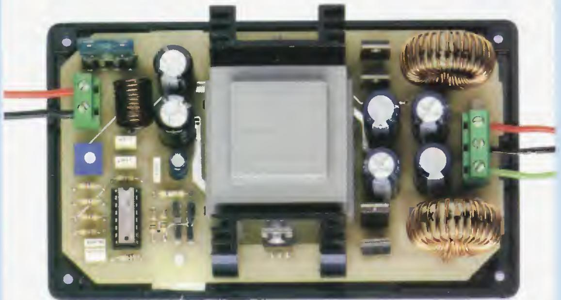
**Fig.7** Il mobile di plastica nera che vi segnaliamo è perfettamente dimensionato per contenere l'alimentatore switching. Il circuito va bloccato sul fondo adoperando i quattro distanziatori plastici con base autoadesiva inclusi nel kit. Prima di chiuderlo, dovete eseguire dei fori sul coperchio e sui flanchi per assicurare la ventilazione (vedi fig.10).
