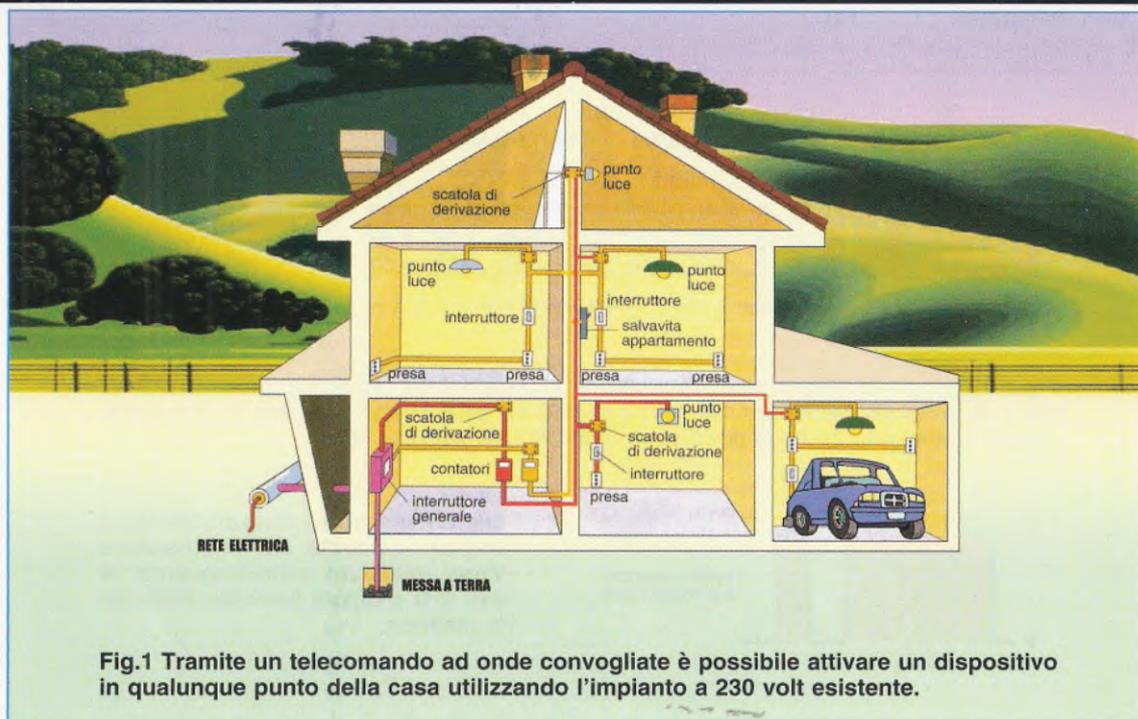
Fig.1 Tramite un telecomando ad onde convogliate è possibile attivare un dispositivo in qualunque punto della casa utilizzando l'impianto a 230 volt esistente.
