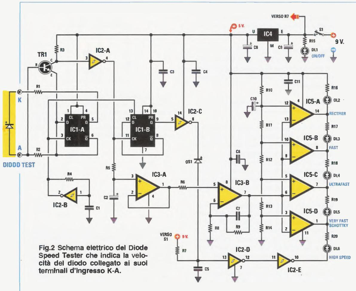
**Fig.2** Schema elettrico del **Diode Speed Tester** che indica la velocità del diodo collegato ai suoi terminali d'Ingresso **K-A**.
