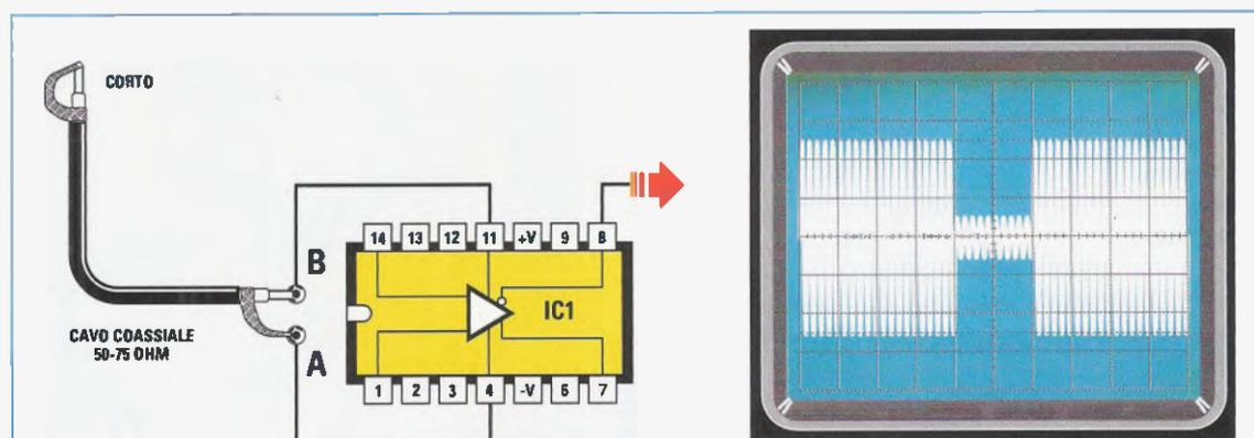
**Fig.22** Se cortocirciterete l'estremità del cavo coassiale noterete che variando la frequenza del Generatore RF dal suo minimo al suo massimo, si ottengono delle evidenti variazioni d'ampiezza su frequenze diverse, che da un massimo di 5 quadretti scenderanno bruscamente fino ad 1 quadretto.
