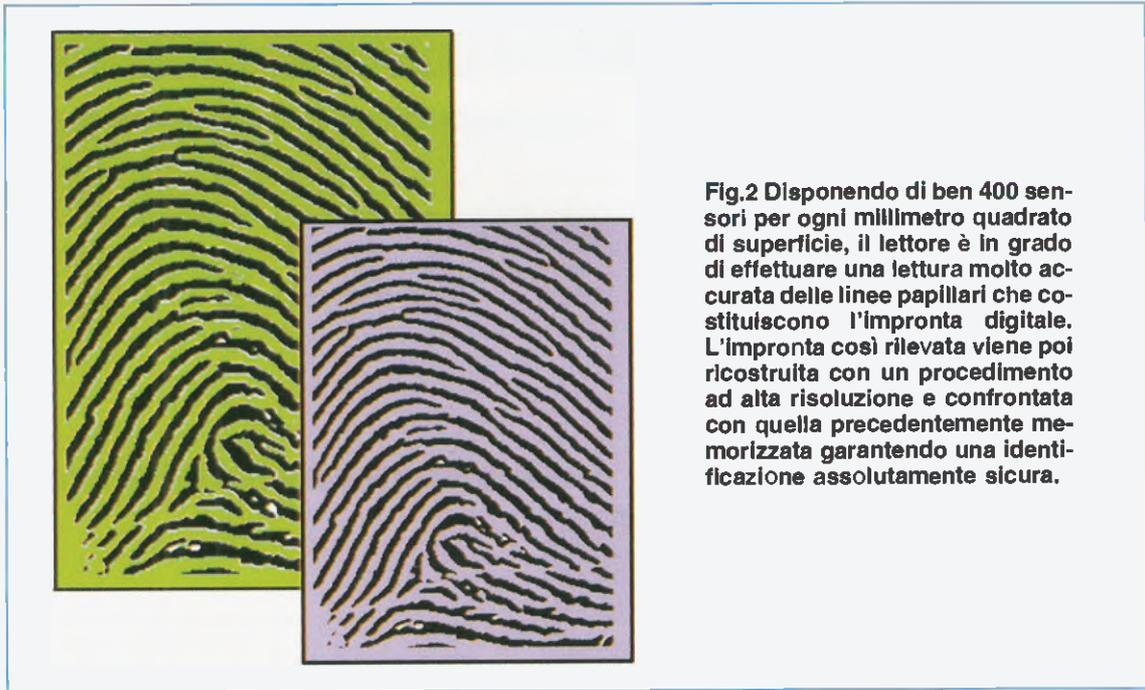
**Fig.2** Disponendo di ben 400 sensori per ogni millimetro quadrato di superficie, il lettore è in grado di effettuare una lettura molto accurata delle linee papillari che costituiscono l'impronta digitale. L'impronta così rilevata viene poi ricostruita con un procedimento ad alta risoluzione e confrontata con quella precedentemente memorizzata garantendo una identificazione assolutamente sicura.
