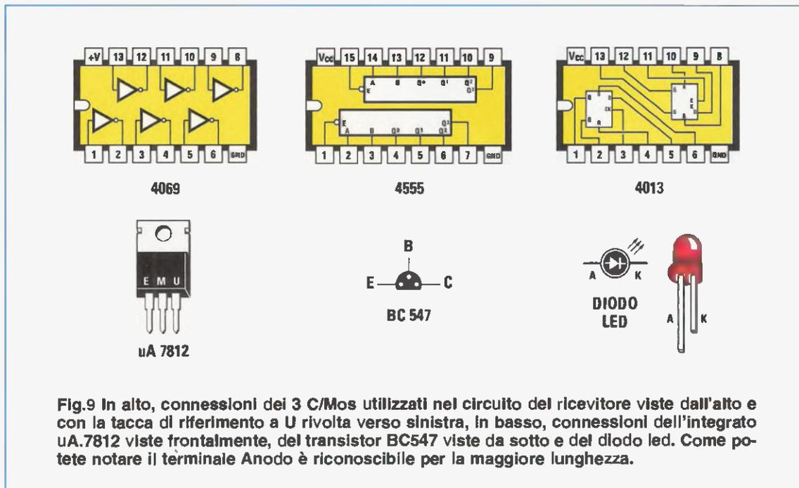
Fig.9 In alto, connessioni dei 3 C/Mos utilizzati nel circuito del ricevitore viste dall'alto e con la tacca di riferimento a U rivolta verso sinistra, in basso, connessioni dell'integrato uA.7812 viste frontalmente, del transistor BC547 viste da sotto e del diodo led. Come potete notare il terminale Anodo è riconoscibile per la maggiore lunghezza.
