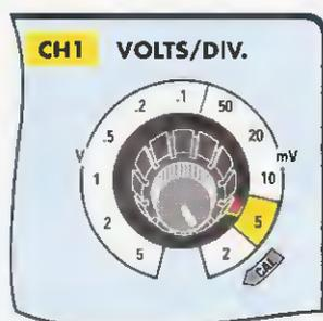
Fig.15 Quando testerete dei circuiti che introducono delle elevate attenuazioni noterete che la massima ampiezza non riuscirà a raggiungere i 6-7 quadretti in verticale. Per ottenere questa condizione dovreste ruotare la manopola dei Volts/Div. sulla portata dei 10-5 millivolt.
