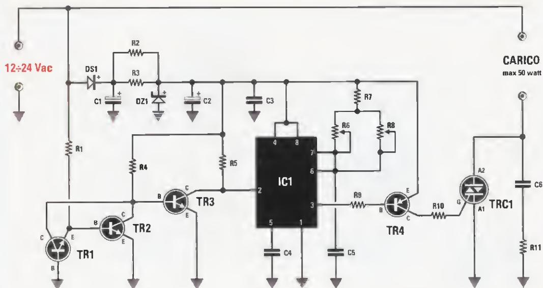
Fig.3 Schema elettrico del dimmer. In basso sono riprodotte le connessioni dell'integrato NE555 viste da sopra e con la tacca di riferimento orientata a sinistra, quelle dei transistor NPN siglati BC547 e del transistor PNP siglato BC.557 viste da sotto e quelle del triac BT.137/500 viste di fronte.
