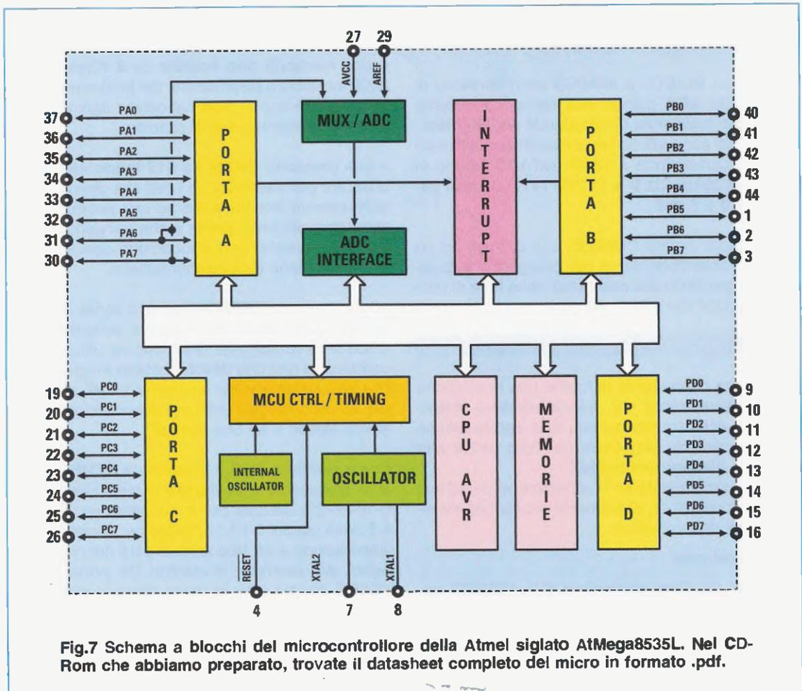
Fig.7 Schema a blocchi del microcontrollore della Atmel siglato Atmega8535L. Nel CD-Rom che abbiamo preparato, trovate il datasheet completo del micro in formato .pdf.
