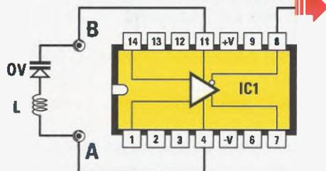
**Fig.19** Se desiderate conoscere la capacità di un diodo Varicap, basterà collegarlo in serie ad una Induttanza L di valore conosciuto e poi procedere come se fosse un circuito L-C (vedi fig.18).
