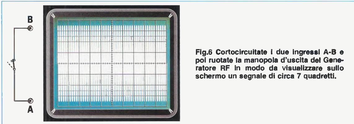
**Fig.6** Cortocircuitate i due ingressi A-B e poi ruotate la manopola d'uscita del Generatore RF in modo da visualizzare sullo schermo un segnale di circa 7 quadretti.
