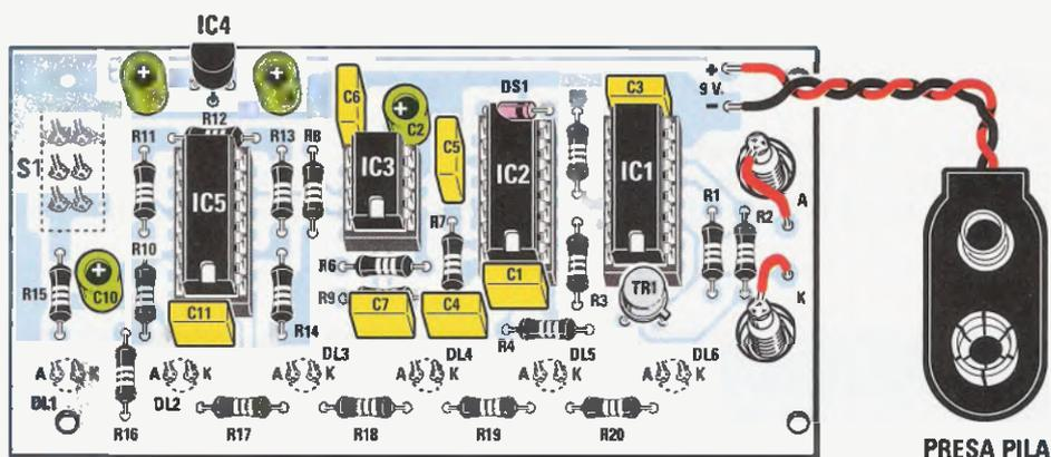
Fig.8 Disegno dello schema pratico di montaggio del nostro Diode Speed Tester visto dal lato componenti. Tale montaggio non presenta nessuna difficoltà e una volta terminato funzionerà non appena lo alimenterete. Si notino i corti spezzi di filo di collegamento tra il circuito stampato e le boccole d'uscita A-K.
