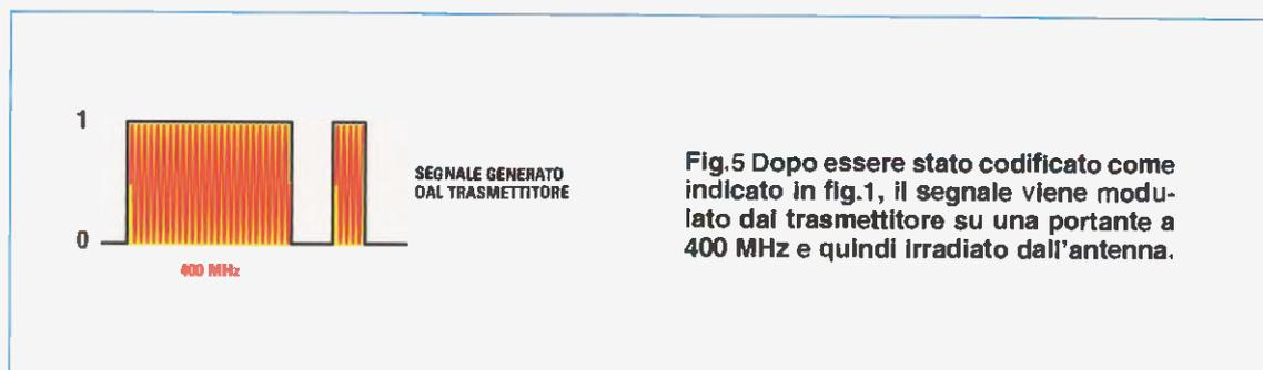
Fig.5 Dopo essere stato codificato come indicato in fig.1, il segnale viene modulato dal trasmettitore su una portante a 400 MHz e quindi irradiato dall'antenna.
