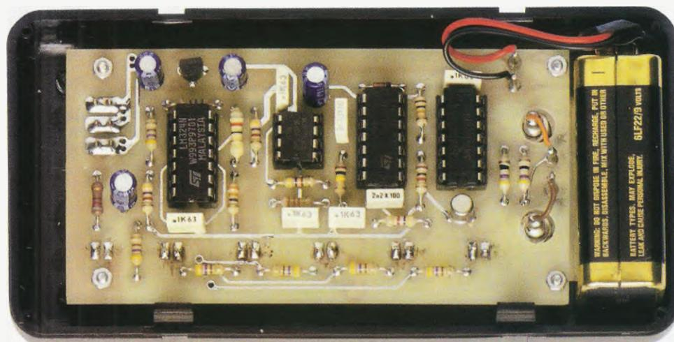
**Fig.7** In questa foto potete vedere come si presenta il **Diode Speed Tester** a montaggio ultimato. La pila di alimentazione viene posta nello spazio disponibile sul lato destro. Nota: il disegno serigrafico dei componenti viene realizzato sul circuito stampato solo dopo che questo è stato completamente forato.
