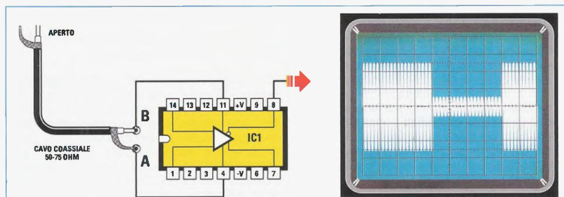
**Fig.23** Se lascerete "aperte" le estremità del cavo coassiale, variando la frequenza del Generatore RF dal suo minimo al suo massimo, noterete delle variazioni d'ampiezza su frequenze diverse. Il segnale RF non rimarrà più costante sui 3 quadretti (vedi fig.21), ma varierà da un massimo di 5 quadretti fino ad un minimo di 1 quadretto.
