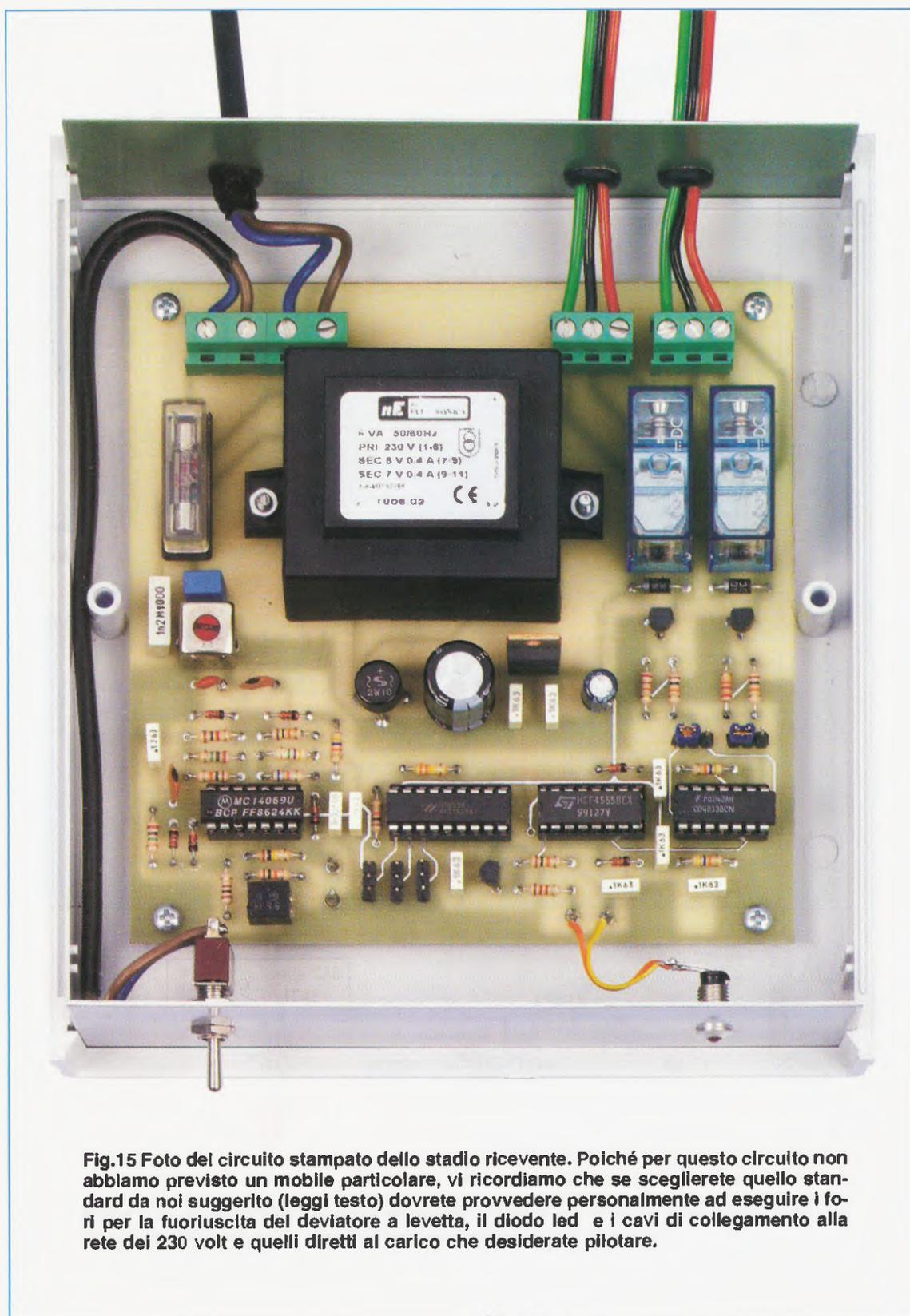
**Fig.15** Foto del circuito stampato dello stadio ricevente. Poiché per questo circuito non abbiamo previsto un mobile particolare, vi ricordiamo che se sceglierete quello standard da noi suggerito (leggi testo) dovrete provvedere personalmente ad eseguire i fori per la fuoriuscita del deviatore a levetta, il diodo led e i cavi di collegamento alla rete dei 230 volt e quelli diretti al carico che desiderate pilotare.
