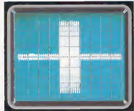
**Fig.12** Per conoscere la frequenza di lavoro di un Filtro Ceramico provvisto di 3 piedini, dovrete collegare i due terminali esterni agli ingressi A-B e ruotare la sintonia del Generatore RF fino a quando incontrerete la sua frequenza di accordo che farà salire bruscamente la sua ampiezza da 0,5 quadretti a circa 7 quadretti.
