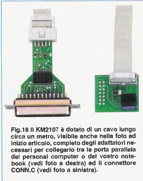
Fig.18 Il KM2107 è dotato di un cavo lungo circa un metro, visibile anche nella foto ad inizio articolo, completo degli adattatori necessari per collegarlo tra la porta parallela del personal computer o del vostro notebook (vedi foto a destra) ed il connettore CONN.C (vedi foto a sinistra).
