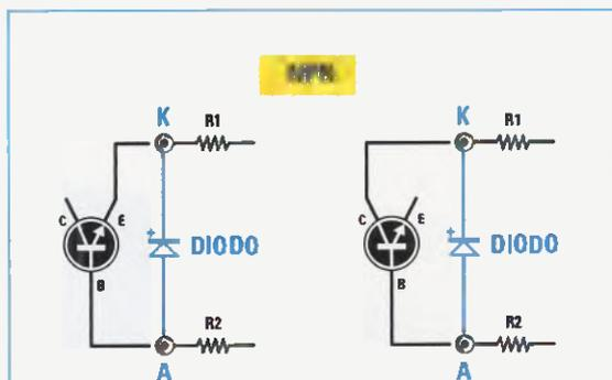
**Fig.18** Per controllare la velocità "trr" di un transistor NPN dovete collegare la Base alla boccola A e il terminale Emittitore o Collettore alla boccola K.
