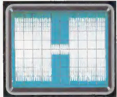
**Fig.11** Per conoscere la frequenza di accordo di una MF, dovrete collegare il suo secondario agli ingressi A-B e poi ruotare la sintonia del Generatore RF fino a quando incontrerete una frequenza la cui ampiezza da 7 quadretti scenderà bruscamente a 1 quadretto.
