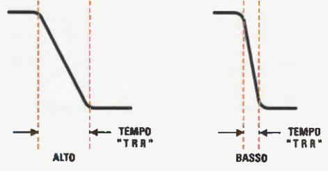
Fig.6 Il valore di "trr" corrisponde al tempo che occorre alla "capacità di giunzione" del diodo per scaricarsi completamente. Quindi un diodo con un "alto valore di trr" impiegherà, rispetto ad un diodo con un "basso valore di trr", molto più tempo per passare dalla massima tensione (livello logico 1) al livello logico "0".
