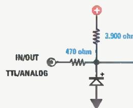
**Fig.5** Il morsetto 10 del **CONN.B**, che corrisponde all'entrata-uscita di tipo **Analog/TTL**, è connesso tramite questa rete al piedino 37 della porta **A** (cioè, come visibile in **fig.7**, al piedino **PA0**).
