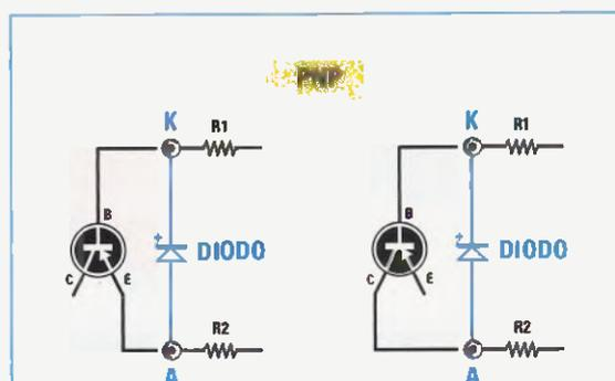
**Fig.19** Per controllare la velocità "trr" di un transistor PNP dovete collegare la Base alla boccola K e il terminale Emittitore o Collettore alla boccola A.
