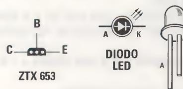
**Fig.3** Il transistor NPN siglato **ZTX.653**, di cui riportiamo le connessioni viste da sotto, è particolarmente adatto per applicazioni switching a bassa tensione, perché ha una **VCE di saturazione** molto bassa. Il terminale Anodo 'A' del led, che va collegato al positivo, si riconosce facilmente, perché più lungo del terminale Catodo 'K'.
