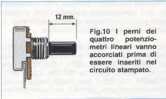
**Fig.10 I perni dei quattro potenziometri lineari vanno accorciati prima di essere inseriti nel circuito stampato.**
