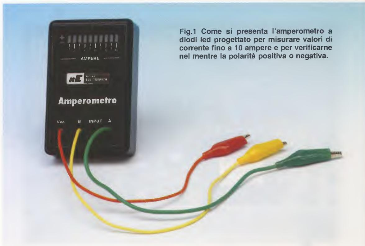
Fig.1 Come si presenta l'amperometro a diodi led progettato per misurare valori di corrente fino a 10 ampere e per verificarne nel mentre la polarità positiva o negativa.
