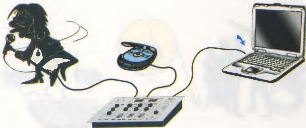
**Fig.3** Se siete appassionati di karaoke, collegando l'ingresso del mixer ad un lettore MP3 contenente una base preregistrata e la sua uscita alla scheda audio del personal computer, sarete in grado non solo di curare la realizzazione delle vostre esecuzioni ma anche di crearvi una vostra personale compilation su CD-Rom.
