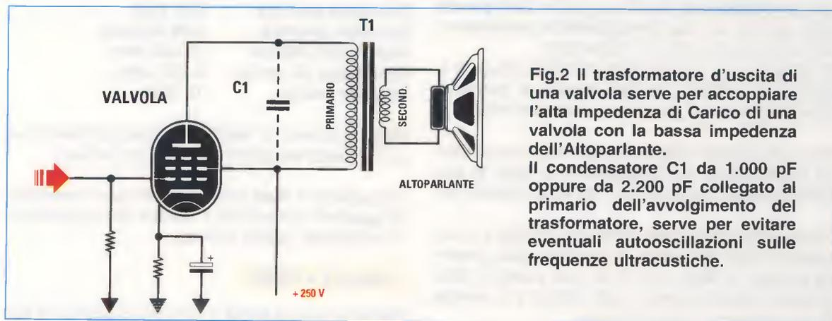
**Fig.2** Il trasformatore d'uscita di una valvola serve per accoppiare l'alta Impedenza di Carico di una valvola con la bassa impedenza dell'Altoparlante.
