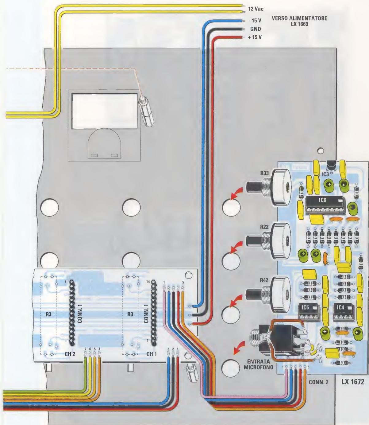
Vi suggeriamo di eseguire dapprima il fissaggio sulla mascherina della scheda LX.1670 e di procedere poi da sinistra a destra con le altre schede, seguendo le indicazioni delle frecce per l'inserimento dei perni dei potenziometri, dei tasti del commutatore e delle due prese jack. Per la buona riuscita di questa operazione, vi raccomandiamo di rispettare la sequenza dei colori dei fili del cablaggio come indicato in figura.
