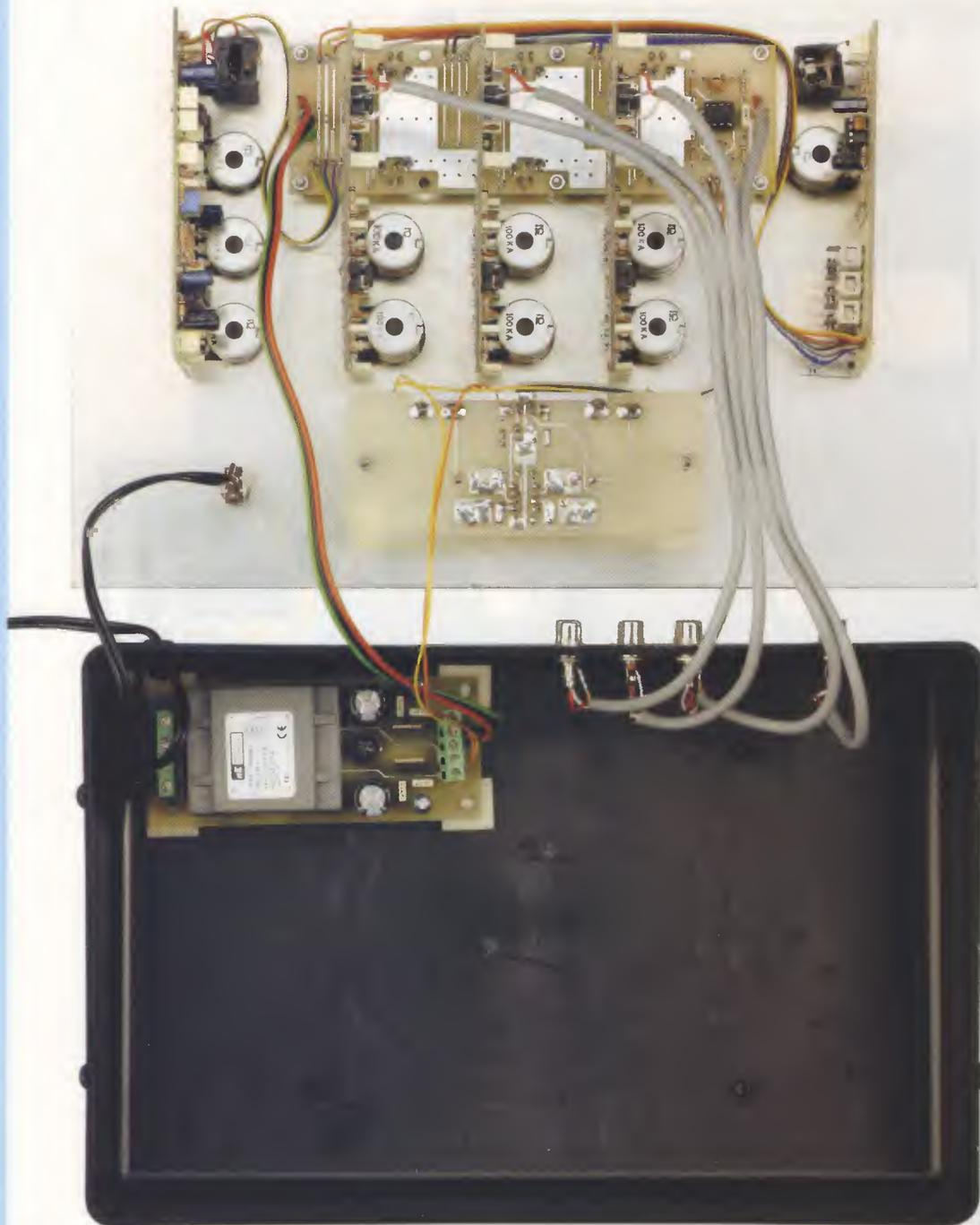
**Fig.28** Questa foto, insieme ai disegni precedenti di figg.26-27, vi aiuterà a portare a termine con successo la fase del cablaggio tra le diverse schede di cui si compone questo progetto. Come potete notare, tutti gli stampati sono fissati sul lato interno della mascherina del mobile, eccezion fatta per quello dell'alimentatore LX.1669 che va fissato per mezzo di quattro clips adesive direttamente sulla base del mobile.
