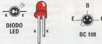
Fig.2 Connessioni viste da sotto del transistor **BC.108** sostituibile con altri transistor equivalenti, anche se plastici.
