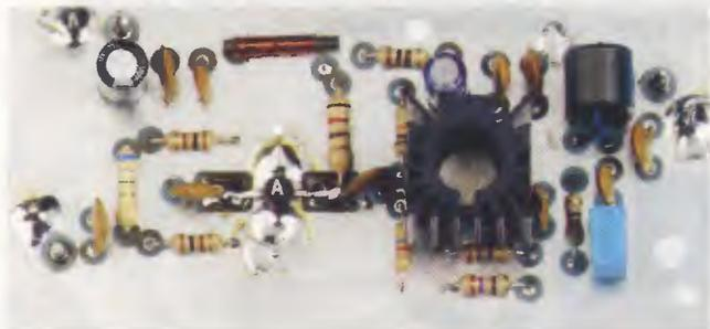
Fig.5 Foto di come si presenta l'Amplificatore RF a Larga Banda a montaggio ultimato.
