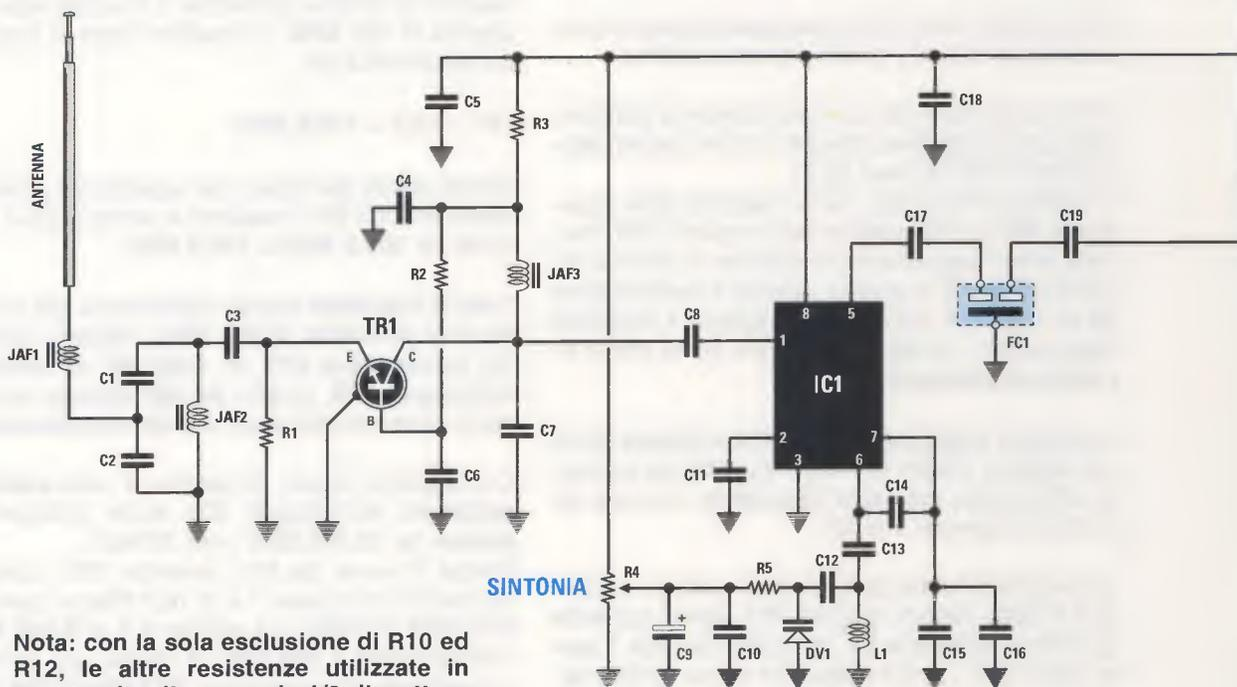
**Nota:** con la sola esclusione di R10 ed R12, le altre resistenze utilizzate in questo circuito sono da 1/8 di watt.
