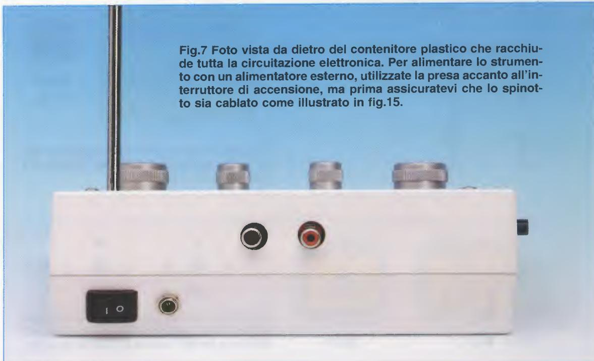
**Fig.7** Foto vista da dietro del contenitore plastico che racchiude tutta la circuiteria elettronica. Per alimentare lo strumento con un alimentatore esterno, utilizzate la presa accanto all'interruttore di accensione, ma prima assicuratevi che lo spinotto sia cablato come illustrato in fig.15.
