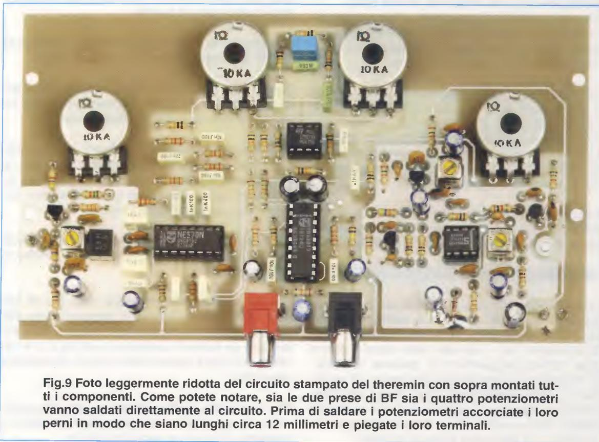
Fig.9 Foto leggermente ridotta del circuito stampato del theremin con sopra montati tutti i componenti. Come potete notare, sia le due prese di BF sia i quattro potenziometri vanno saldati direttamente al circuito. Prima di saldare i potenziometri accorciate i loro perni in modo che siano lunghi circa 12 millimetri e piegate i loro terminali.
