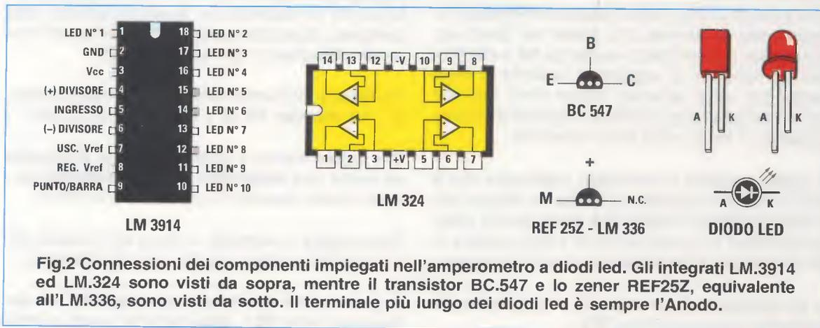
Fig.2 Connessioni dei componenti impiegati nell'amperometro a diodi led. Gli integrati LM.3914 ed LM.324 sono visti da sopra, mentre il transistor BC.547 e lo zener REF25Z, equivalente all'LM.336, sono visti da sotto. Il terminale più lungo dei diodi led è sempre l'Anodo.
