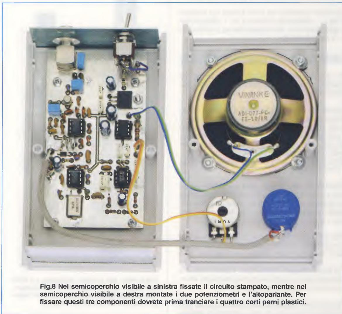
Fig.8 Nel semicoperchio visibile a sinistra fissate il circuito stampato, mentre nel semicoperchio visibile a destra montate i due potenziometri e l'altoparlante. Per fissare questi tre componenti dovrete prima tranciare i quattro corti perni plastici.
