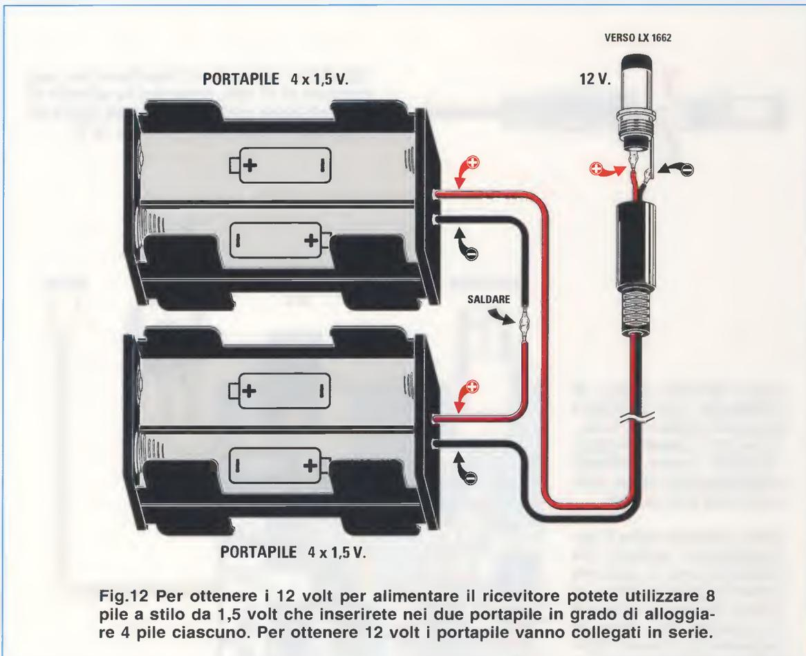
Fig.12 Per ottenere i 12 volt per alimentare il ricevitore potete utilizzare 8 pile a stilo da 1,5 volt che inserirete nei due portapile in grado di alloggiare 4 pile ciascuno. Per ottenere 12 volt i portapile vanno collegati in serie.
