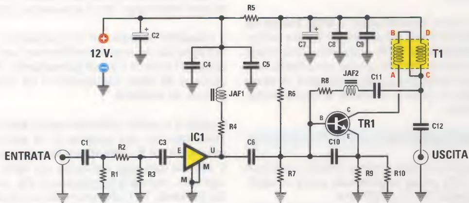
**Fig.3** Schema elettrico dell'Amplificatore a Larga Banda in grado di amplificare di 14 dB (circa 5 volte in tensione) tutti i segnali RF da 0,4 MHz a 120 MHz che vengono applicati sul suo ingresso. Il massimo segnale che si può applicare sul suo ingresso si aggira su 1,5 volt picco/picco pari ad una potenza di 50 milliwatt.
