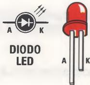
Fig.6 Qui a sinistra le connessioni E.M.U dello stabilizzatore IC2 e quelle del diodo led, il cui terminale più lungo, come saprete, è l'Anodo.
