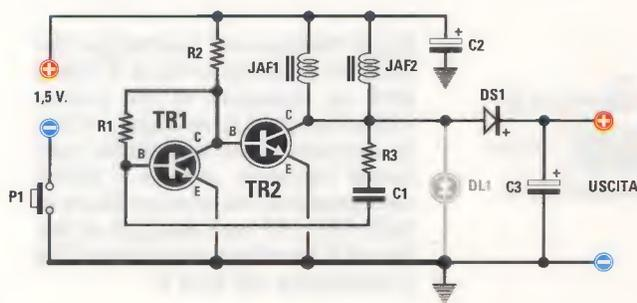
**Fig.4** Il circuito visibile in fig.2 può essere modificato per ottenere, in funzione della corrente prelevata, valori differenti di tensione continua, come indicato nella tabella in questa pagina. Al posto del diodo led inserite:
