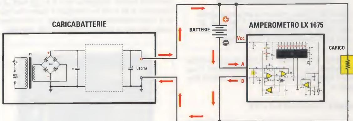
Fig.14 Collegando l'ampmetro ad un caricabatteria e ad una batteria, potremo rilevare il valore della corrente di carica ed il valore della corrente di scarica. Se la corrente è fornita dal caricabatteria alla batteria, la polarità è positiva e si accende il led DL11.
