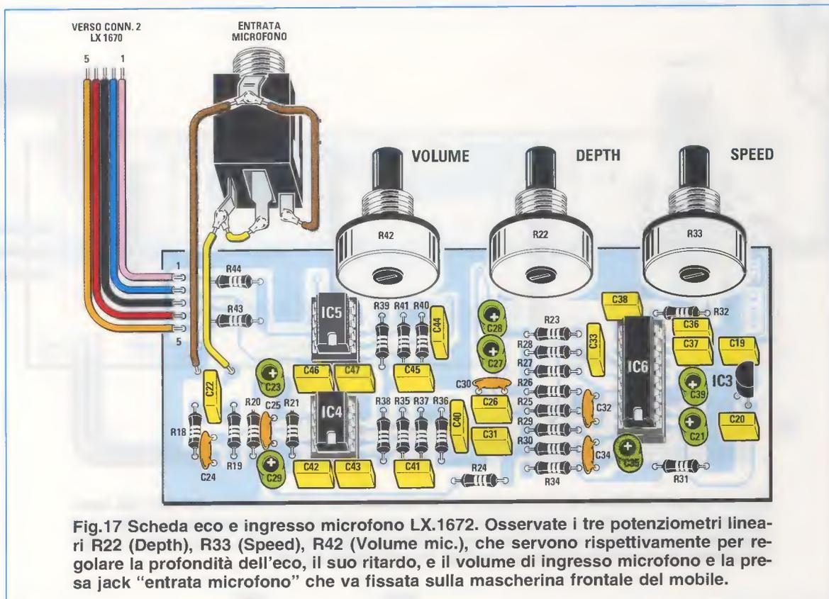
**Fig.17 Scheda eco e ingresso microfono LX.1672.** Osservate i tre potenziometri lineari R22 (Depth), R33 (Speed), R42 (Volume mic.), che servono rispettivamente per regolare la profondità dell'eco, il suo ritardo, e il volume di ingresso microfono e la presa jack "entrata microfono" che va fissata sulla mascherina frontale del mobile.
