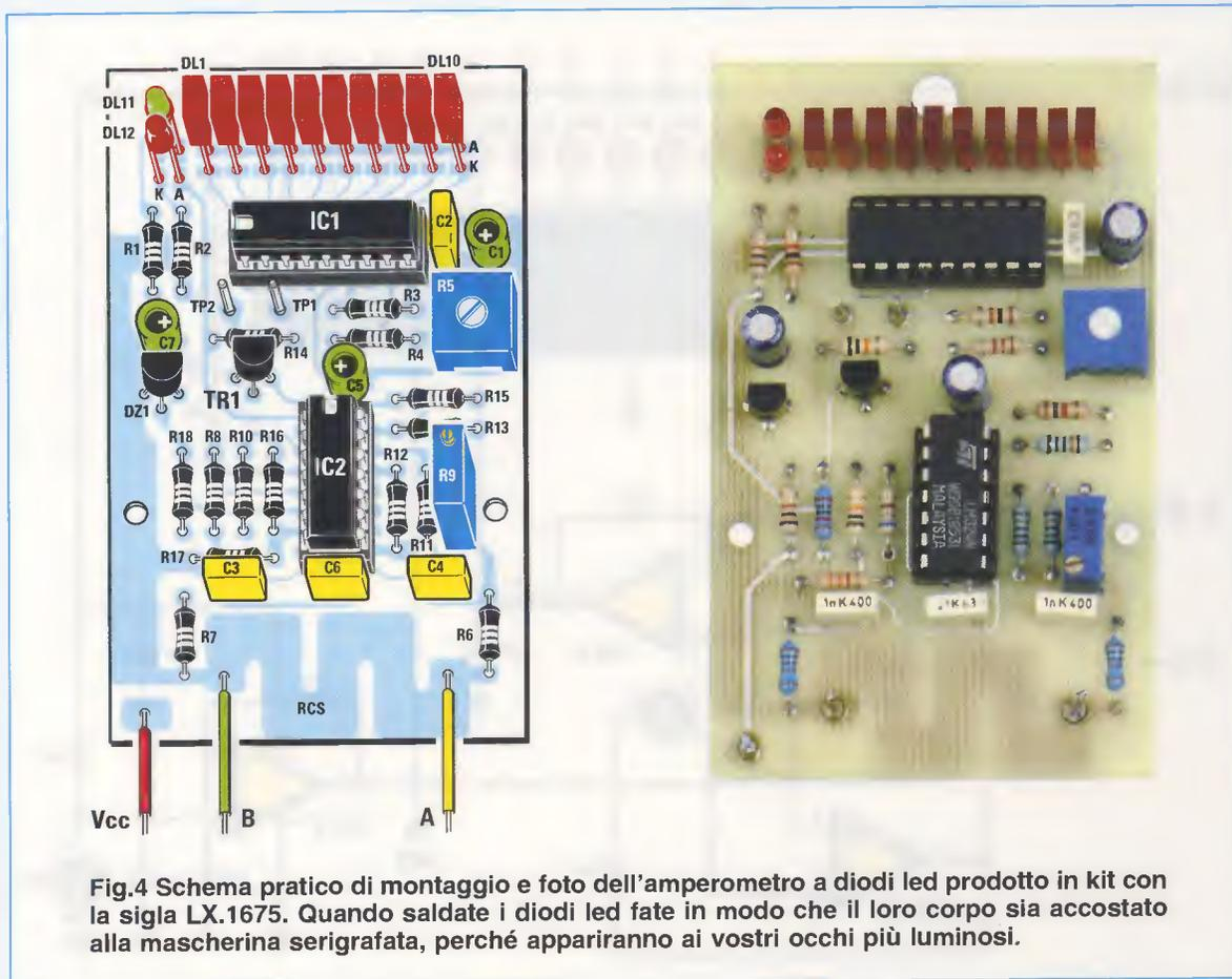
**Fig.4** Schema pratico di montaggio e foto dell'amperometro a diodi led prodotto in kit con la sigla LX.1675. Quando saldate i diodi led fate in modo che il loro corpo sia accostato alla mascherina serigrafata, perché appariranno ai vostri occhi più luminosi.
