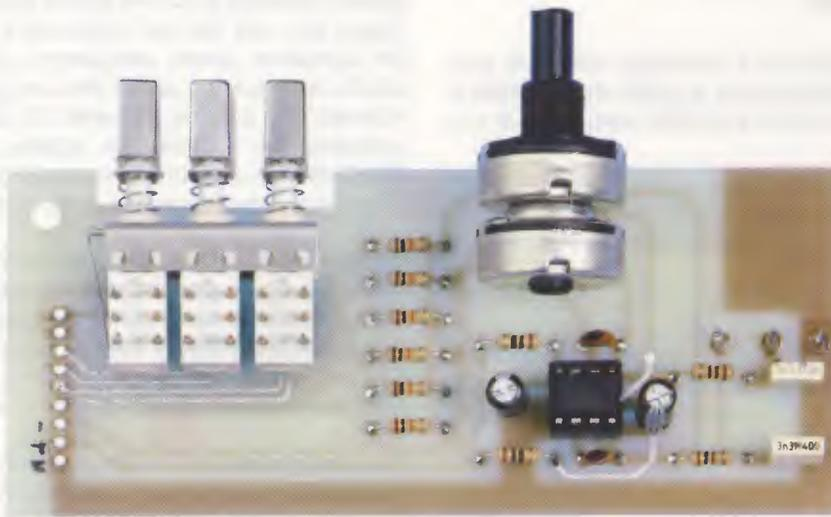
Fig.24 La scheda di preascolto LX.1673. I 3 commutatori, il potenziometro del volume e l'uscita cuffie vanno inseriti sul lato destro della mascherina del mixer (vedi foto di fig.13).
