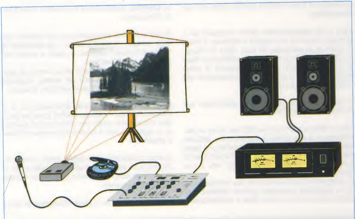
**Fig.2** Collegando un microfono all'ingresso MIC del mixer, un lettore di CD-Rom ad uno degli ingressi e l'uscita del mixer al vostro impianto stereo potrete allietare le proiezioni di filmati e diapositive, sovrapponendo il commento parlato ad un piacevole sottofondo musicale.
