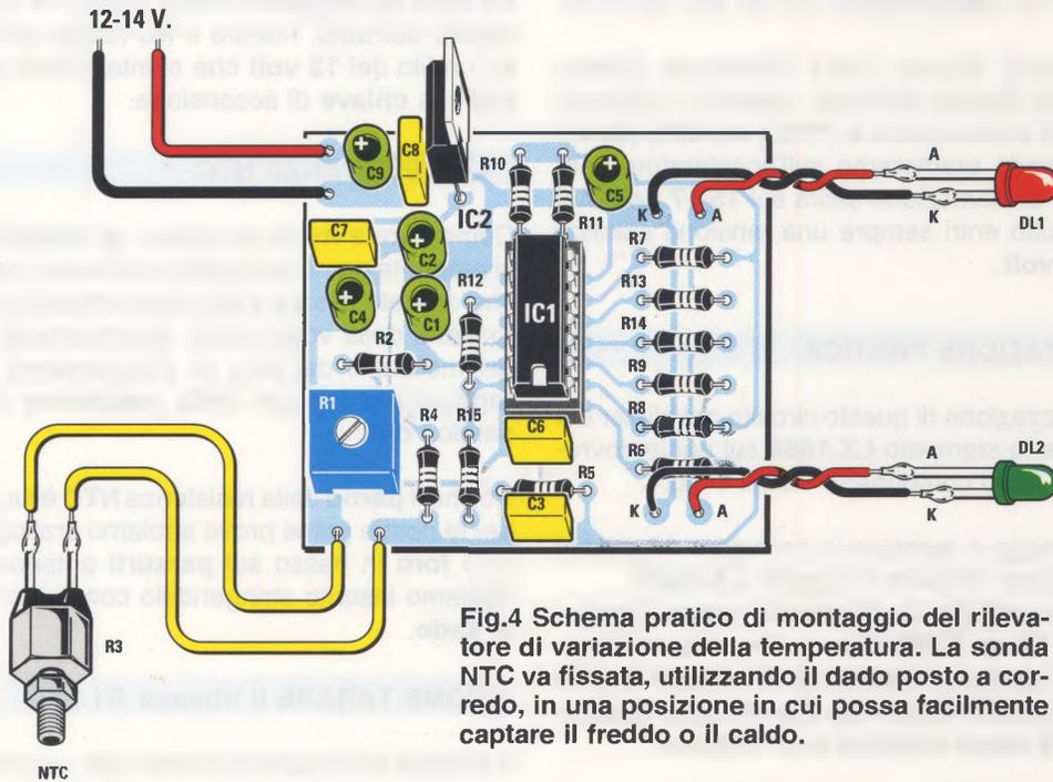
Fig.4 Schema pratico di montaggio del rilevatore di variazione della temperatura. La sonda NTC va fissata, utilizzando il dado posto a corredo, in una posizione in cui possa facilmente captare il freddo o il caldo.
