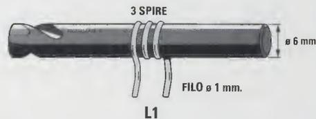
Fig.7 Per realizzare la bobina L1 prendete una punta da trapano da 6 mm e attorno a questa avvolgete 3 spire di filo stagnato o argentato da 1 mm. Dopo aver avvolto queste spire, dovrete spaziarle in modo da ottenere un solenoide lungo circa 5 mm.
