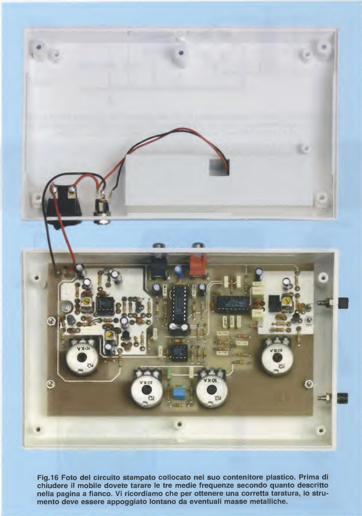
**Fig.16** Foto del circuito stampato collocato nel suo contenitore plastico. Prima di chiudere il mobile dovete tarare le tre medie frequenze secondo quanto descritto nella pagina a fianco. Vi ricordiamo che per ottenere una corretta taratura, lo strumento deve essere appoggiato lontano da eventuali masse metalliche.
