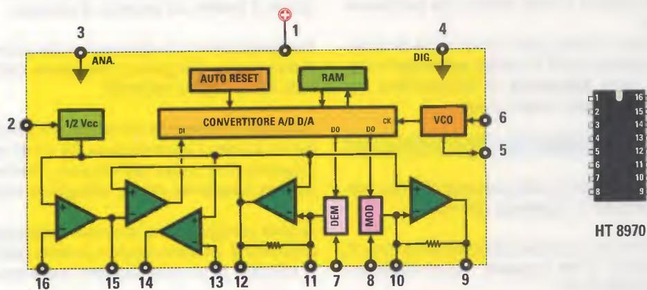
Fig.6 Connessioni dell'integrato HT8970 viste da sopra e con la tacca di riferimento a U rivolta verso l'alto e, a sinistra, il relativo schema a blocchi.
