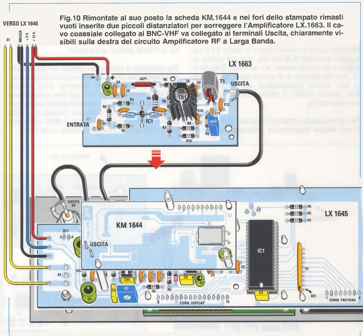
Fig.10 Rimontate al suo posto la scheda KM.1644 e nei fori dello stampato rimasti vuoti inserite due piccoli distanziatori per sorreggere l'Amplificatore LX.1663. Il cavo coassiale collegato al BNC-VHF va collegato ai terminali Uscita, chiaramente visibili sulla destra del circuito Amplificatore RF a Larga Banda.
