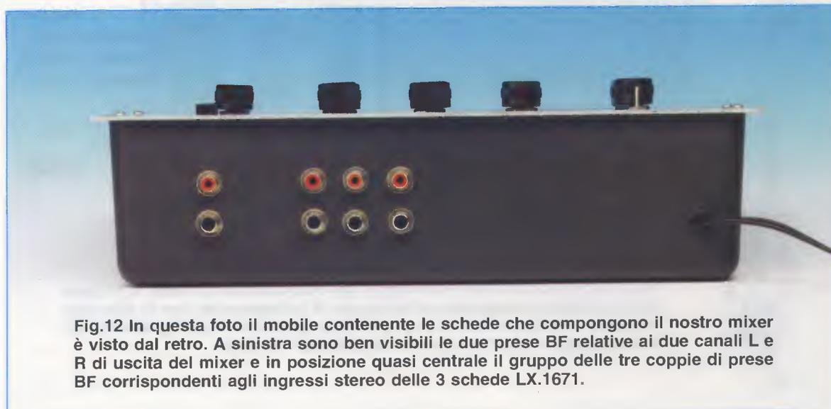
Fig.12 In questa foto il mobile contenente le schede che compongono il nostro mixer è visto dal retro. A sinistra sono ben visibili le due prese BF relative ai due canali L e R di uscita del mixer e in posizione quasi centrale il gruppo delle tre coppie di prese BF corrispondenti agli ingressi stereo delle 3 schede LX.1671.
