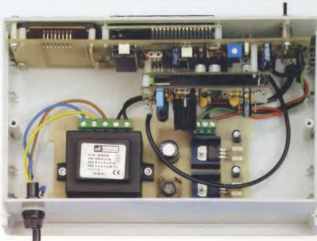
Fig.12 Foto dell'interno del nostro Generatore DDS vista da sopra. Coloro che trovarono complicata la soluzione visibile in fig.11, potranno fissare lo stampato LX.1663 nello spazio disponibile nella parte posteriore destra del mobile.
