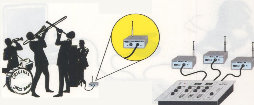
Fig.1 Collegando i canali di ingresso del mixer al nostro ricevitore LX.1491 e abbinando a ciascuno strumento musicale il corrispondente trasmettitore LX.1490 è possibile effettuare via radio il mixaggio di tutti i segnali audio, eliminando la necessità di fastidiosi cavi di collegamento.
