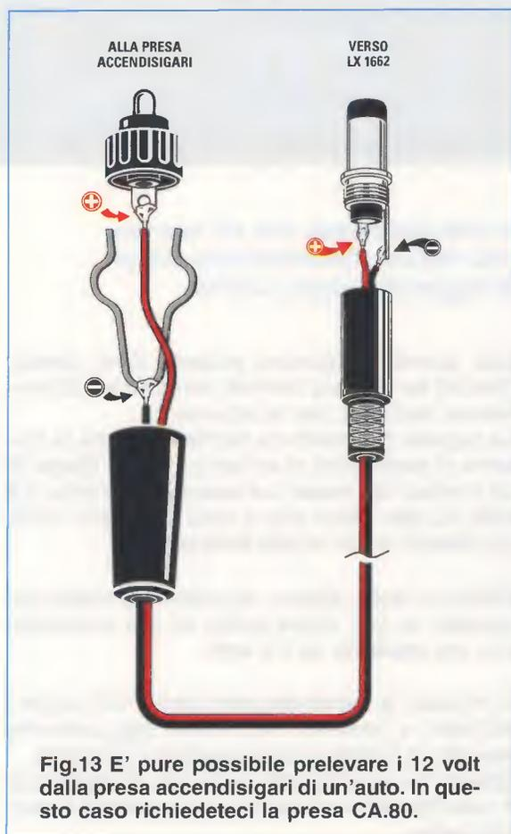
**Fig.13 E' pure possibile prelevare i 12 volt dalla presa accendisigari di un'auto. In questo caso richiedeteci la presa CA.80.**
