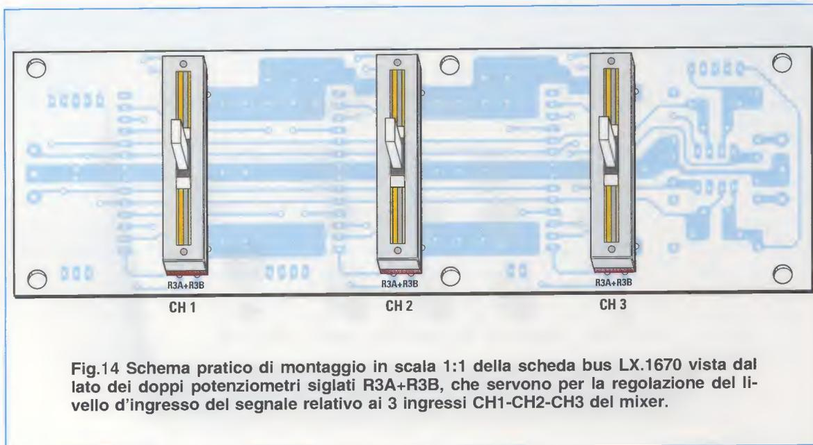
**Fig.14** Schema pratico di montaggio in scala 1:1 della scheda bus LX.1670 vista dal lato dei doppi potenziometri siglati R3A+R3B, che servono per la regolazione del livello d'ingresso del segnale relativo ai 3 ingressi CH1-CH2-CH3 del mixer.
