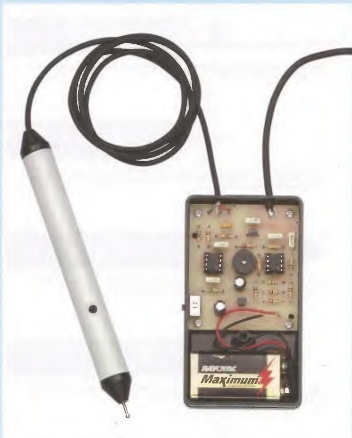
**Fig.10** La foto di uno dei circuiti da noi realizzati per eseguire il collaudo. Sul retro del mobile plastico sono predisposti due fori: in uno di essi va inserito il cavo schermato che fa capo al puntale, saldandone accuratamente i tre terminali sulle apposite piazzole, nell'altro il cavo di collegamento che fa capo al contatto di massa, rappresentato da una piccola ventosa o da una pinza.
