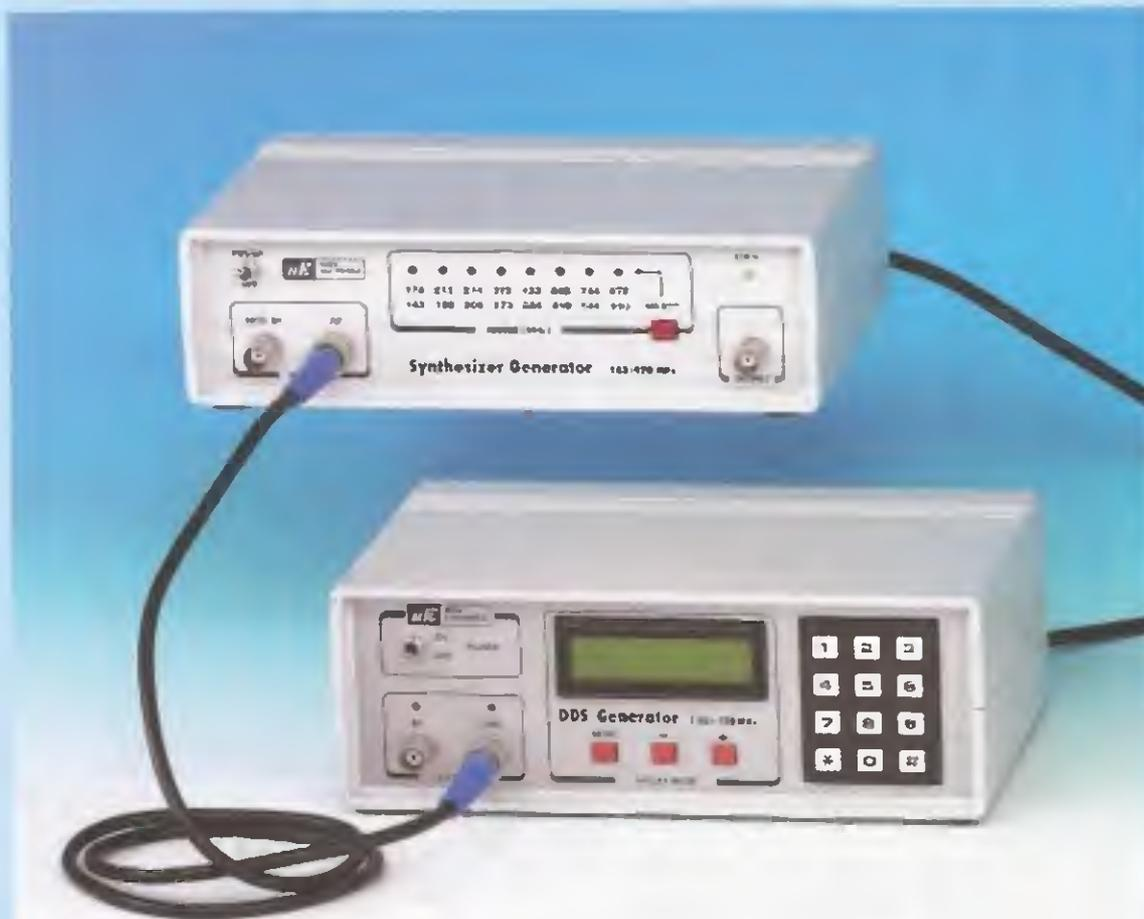
Fig.3 L'uscita VHF del Generatore DDS, che vi abbiamo presentato nella rivista N.226, verrà collegata tramite un cavetto coassiale, al BNC di ingresso del nostro Sintetizzatore. Premendo il tasto Select si accenderà sul pannello frontale il diodo led relativo alla sua gamma di lavoro. Nell'ingresso di questo Sintetizzatore potrete inserire anche il segnale prelevato da un qualsiasi Generatore o VFO purchè generino una frequenza compresa tra 14,3 MHz e 97,0 MHz (vedi Tabella N.1).
