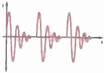
Fig.7 Se spostiamo alternativamente il deviatore dalla posizione A alla posizione B, produrranno nel circuito una serie di onde sinusoidali smorzate che si susseguono come quelle rappresentate in figura.
