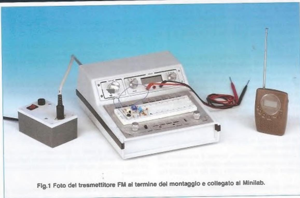
Fig.1 Foto del trasmettitore FM al termine del montaggio e collegato al Minilab.
