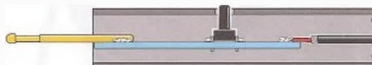
**Fig.6** Inserite il perno del pulsante nel piccolo foro predisposto sul tubo. Se avrete saldato l'elettrodo come indicato in fig.4, noterete che esso fuoriuscirà di circa 23 mm dall'estremità del tubo stesso.
