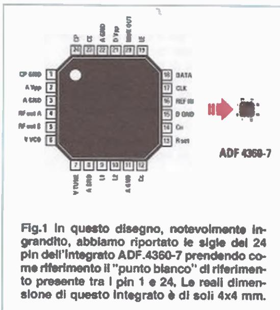
Fig.1 In questo disegno, notevolmente ingrandito, abbiamo riportato le sigle dei 24 pin dell'integrato ADF.4360-7 prendendo come riferimento il "punto bianco" di riferimento presente tra i pin 1 e 24. Le reali dimensioni di questo integrato è di soli 4x4 mm.
