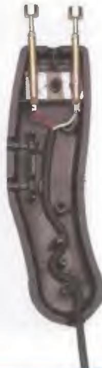
**Fig.7** In questo disegno è rappresentata la sequenza di montaggio dello skin detector all'interno del contenitore plastico.
