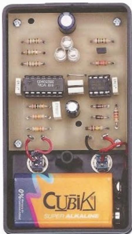
**Fig.5** Foto del mobile plastico al cui interno risultano già fissati il circuito stampato e la pila di alimentazione a 9 Volt.
