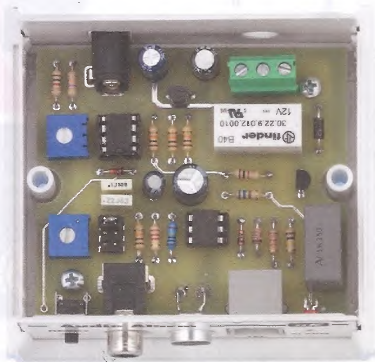
Fig.6 In questa foto potete vedere il circuito del segnalatore LX.1781 montato posto all'interno del mobile plastico appositamente predisposto.
