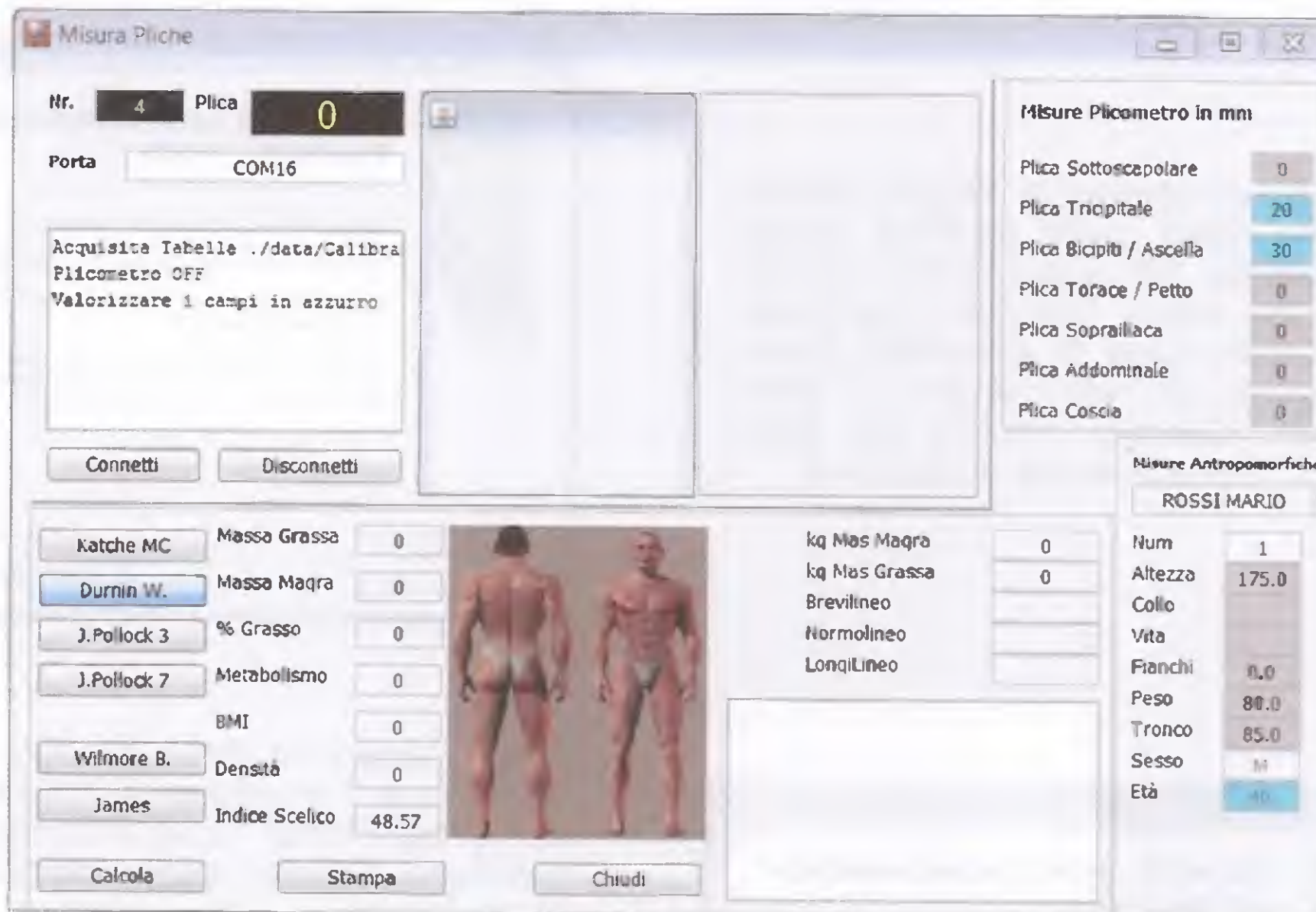
Fig.9 Vi comparirà questa finestra nella quale compaiono i dati anagrafici che avete inserito. Scrivete nell'apposito spazio la porta Com utilizzata. Quindi cliccate sulla casella "Connetti". A seconda dell'equazione che selezionerete (ad esempio quella di Durnin-Womersley), vedrete illuminarsi nel riquadro denominato "Misure plicometro", le caselle relative ai valori delle pliche interessate. Con il pulsante nero (usato come un mouse) cliccate sulla descrizione della plica che desiderate misurare e, presa la plica tra le branche del plicometro, premete il pulsante rosso per memorizzare il dato.
