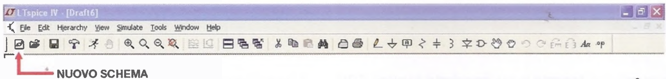
Fig. 1 E' qui riprodotta la barra degli strumenti di LTS. Per iniziare un nuovo schema cliccate su "nuovo schema" e procedete con il disegno.
