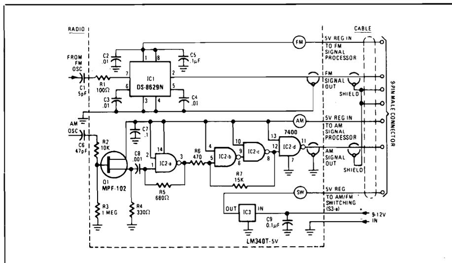
Un altro contatore è utilizzato per misurare la frequenza della sezione AM. Esso legge la frequenza dall'oscillatore locale e vi sottrae il valore di media frequenza (455 kHz): il risultato, che viene visualizzato, è la frequenza di sintonizzazione. L'ultimo contatore opera esattamente come il precedente, ma per la sezione FM, ed è programmato per sottrarre 10,7 MHz (valore di IF). In questa sezione vi è poi l'oscillatore a quarzo per la base dei tempi, l'alimentatore, e il driver per i display.
