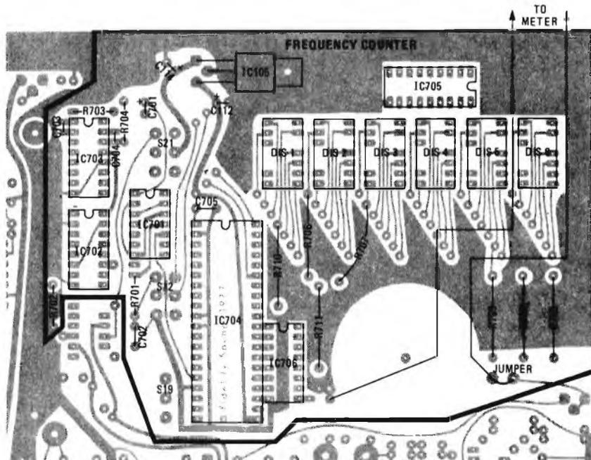
Figura 5 - Dettaglio della parte del circuito stampato nella quale vengono sistemati nel modo illustrato tutti i componenti che costituiscono la sezione frequenzimetrica.
