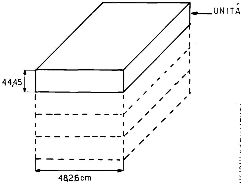
Figura 14 - Misure standard di un'unità rack.
