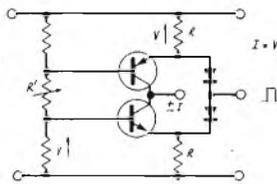
Figura 3-A - Schema di principio di un generatore di segnali di forma d'onda triangolare, basato sull'impiego di una coppia di transistori del tipo « long-tail » e funzionante in modo da modificare la forma d'onda dei segnali rettangolari applicati all'ingresso.
