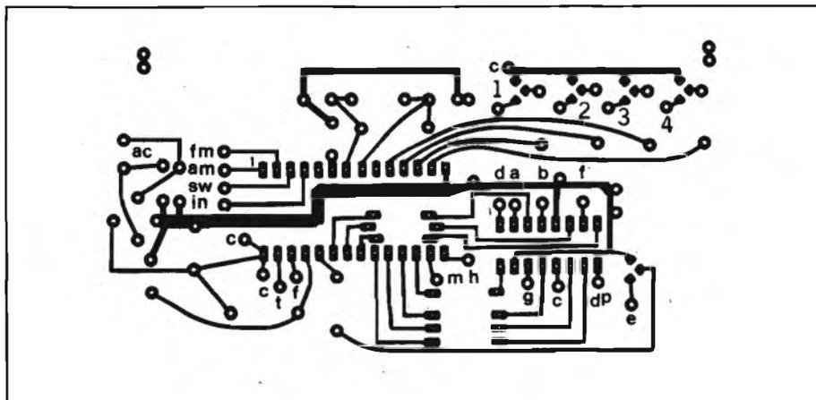
Figura 8 - Circuito stampato sezione principale. Scala 1:1.
