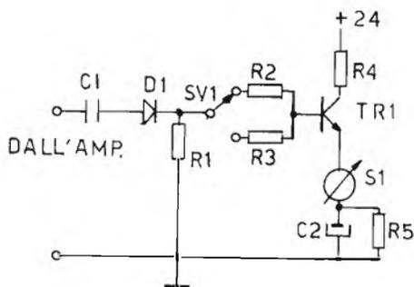
Figura 8 - Schema elettrico Level Meter.
