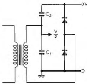
Figura 1-B - Se si desidera ottenere costantemente una tensione di uscita pari al doppio di quella consentita dalla tensione alternata fornita dal trasformatore, è possibile evitare l'impiego del rettificatore a ponte e del commutatore ed adottare questa seconda versione dello schema, la cui componente alternata di uscita presenta un valore di 100 Hz anziché di 50 Hz. Ciò facilita notevolmente l'effetto di livellamento della tensione di uscita.
