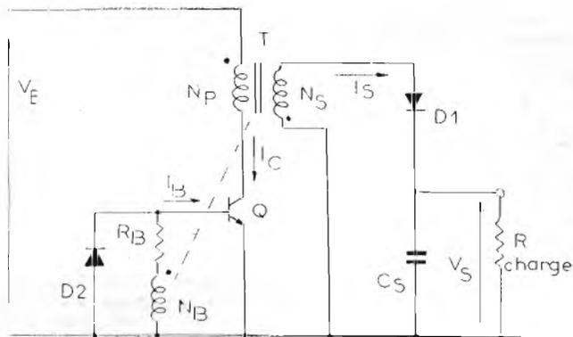
la tensione presente ai capi dell'avvolgimento primario si annulla e si inverte di polarità ai capi dell'avvolgimento secondario. Il diodo  $D$  diventa conduttore e l'energia precedentemente immagazzinata dalla corrente di collettore nell'induttanza primaria viene trasferita attraverso
