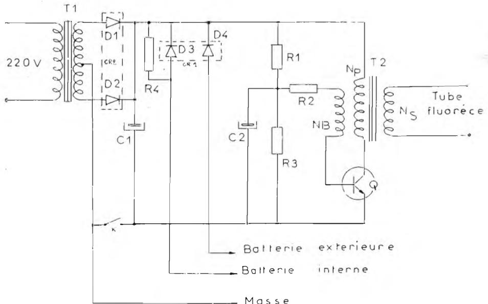
Figura 5 - Schema elettrico del convertitore completo, in grado di funzionare sia con la tensione alternata di rete di 220 V, sia con una batteria che può essere interna al convertitore o esterna (batteria di accumulatori), per ottenere una maggiore autonomia.
