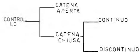
Figura 1 - Schema dei vari tipi di controlli.
