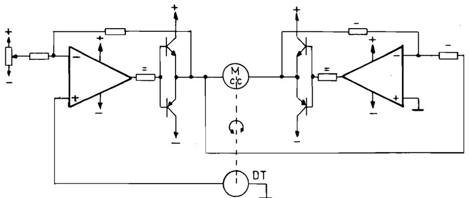
Figura 8 - Schema elettrico di servomeccanismo.
