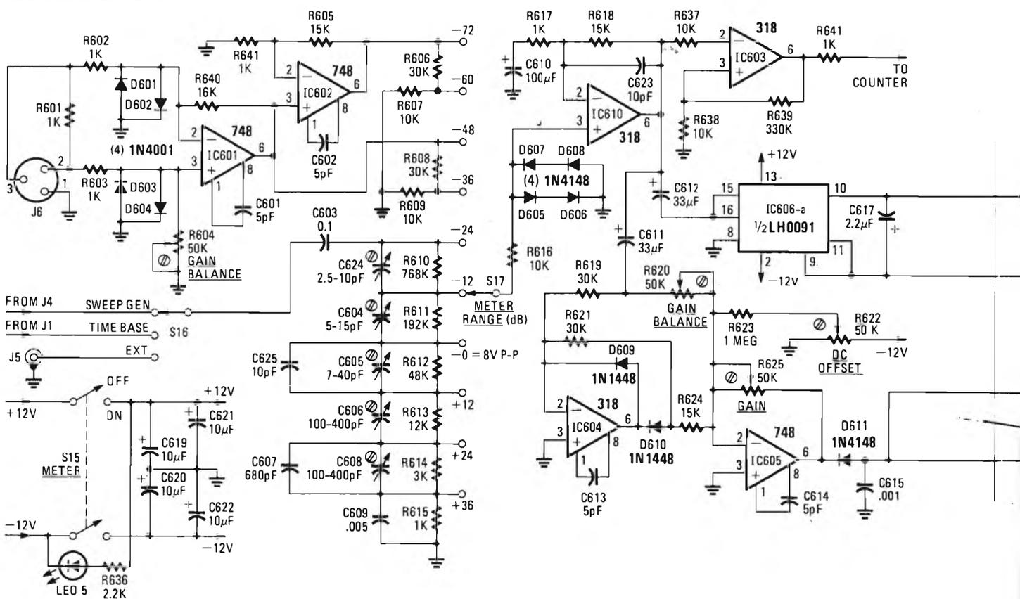
posto che un amplificatore operazionale rappresenta l'unico metodo veramente pratico per realizzare un generatore di onde triangolari. Tuttavia, un risultato molto soddisfacente può essere ottenuto anche impiegando una coppia di transistori del tipo «long-tail» ed uno dei cosiddetti «circuiti specchio».
