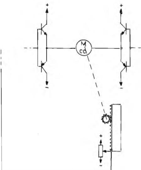
Figura 9 - Trasformazione all'uscita per avere una regolazione della posizione.
