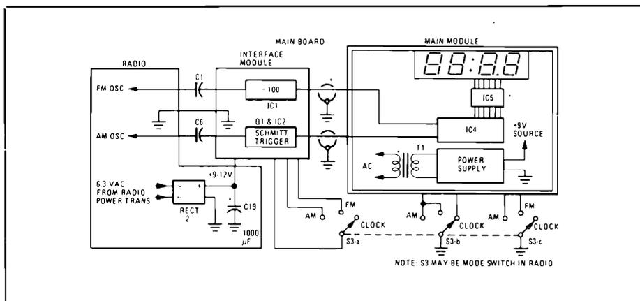
Figura 1 - Schema a blocchi dell'unità orologio/visualizzatore di frequenza.
