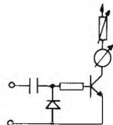
Figura 9 - Configurazione usata normalmente nei Level Meter.
