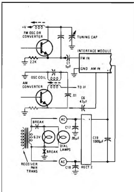
Figura 11 - Collegamento della sezione interfaccia al ricevitore.
