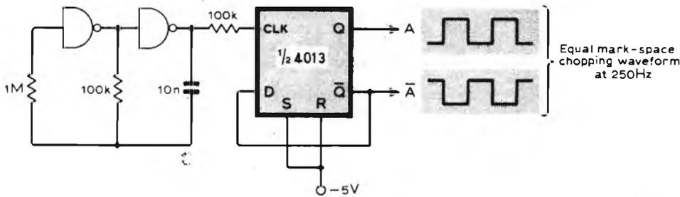
Figura 2-B - Schema del generatore di impulsi con uguale rapporto tra spazio e contrasti, per la frequenza di 250 Hz.
