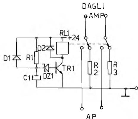
Figura 11 - Schema elettrico della protezione per casse acustiche.
