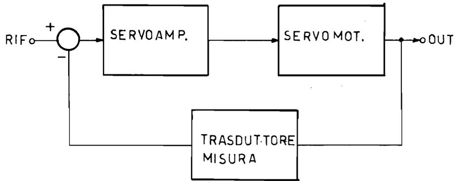
Figura 6 - Schema a blocchi di un servomeccanismo.
