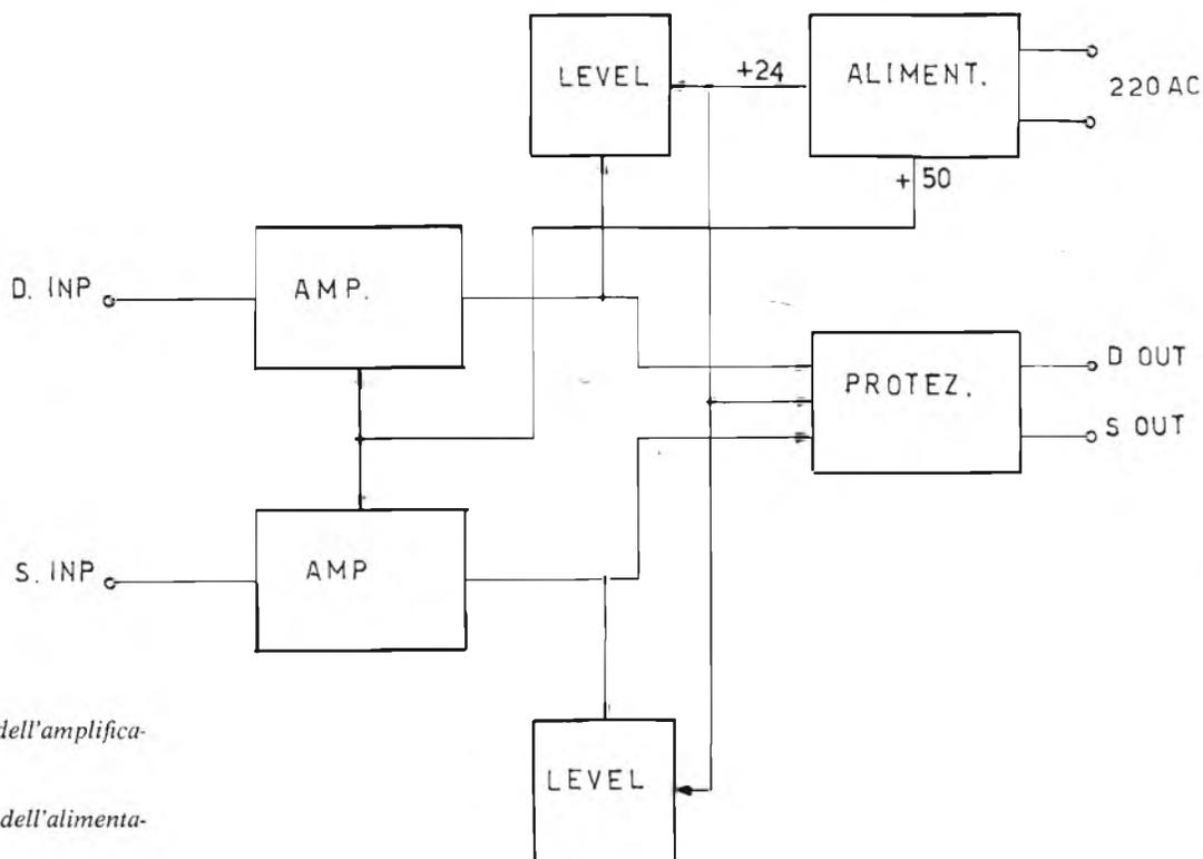
Figura 1 - Schema a blocchi dell'amplificatore Hi-Fi.
