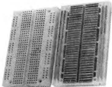
È la versione dell'SK10 ridotta esattamente alla metà. Ha le stesse caratteristiche dell'SK10, con 4 bus di alimentazione anziché 8.
