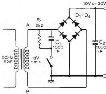
Figura 1-A - Schema di principio di un normale rettificatore a ponte, in grado di fornire in uscita una tensione continua di 10 V. Quando però il commutatore che unisce il gruppo R1-C1 a massa viene chiuso, si ottiene l'effetto particolare descritto nel testo, che determina il raddoppiamento della tensione continua ottenibile in uscita.
