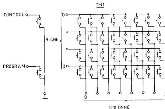
Figura 21 - Schema elettrico della tastiera TM1.
