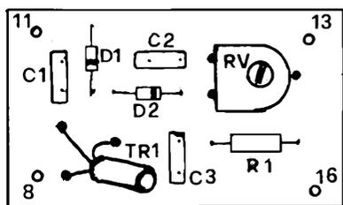
Figura 5 - Circuito stampato della commutazione elettronica.
