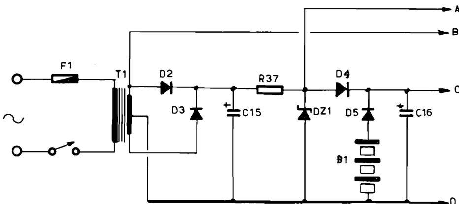
taneamente sia la tensione alternata di rete, sia la tensione di riserva fornita dalla batteria.
