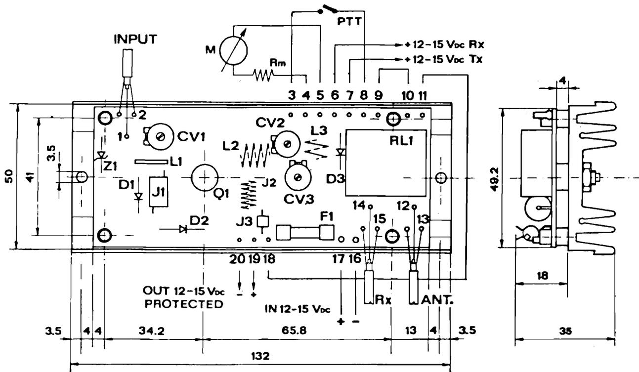
Figura 2 - Disposizione componenti e contatti dell'amplificatore lineare.
