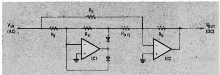
di un circuito denominato di «attacco/caduta», che controlla il funzionamento di un dispositivo che modifica la curva di responso tra l'ingresso e l'uscita. Quest'ultimo dispositivo, a sua volta, fornisce la tensione o la corrente di controllo che viene applicata all'amplificatore a controllo di tensione, alla cui uscita risulta infine disponibile il segnale opportunamente corretto.
