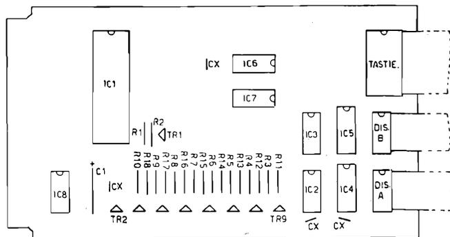
Figura 19 - Montaggio componenti della cartella DTM1.
