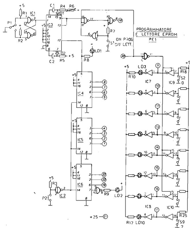
Figura 29 - Schema elettrico del programmatore EPROM PE1.
