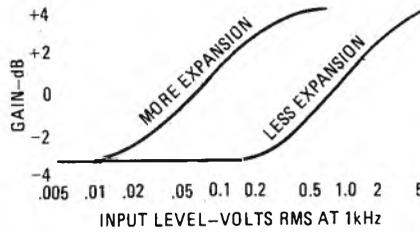
Figura 5 - La pendenza della curva di espansione deve essere contenuta nel minimo possibile, se si desidera evitare repentine e sgradevoli variazioni del volume nel suono riprodotto.
