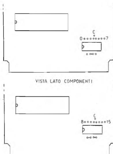
Figura 17 - Vista cavallotti per selezionare codice DTM1.
