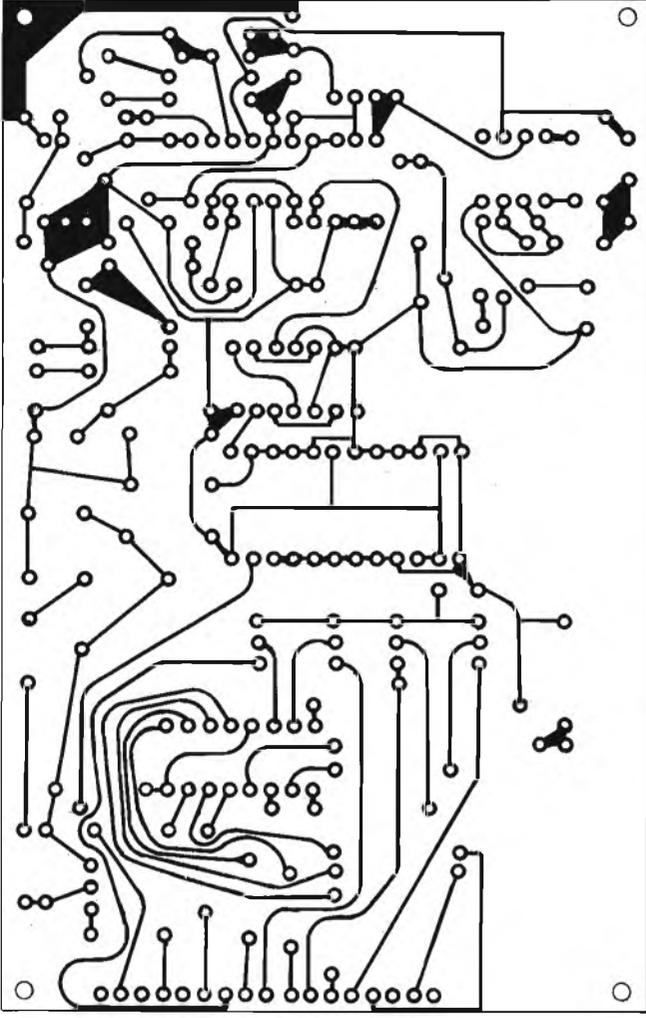
Figura 5 - Lato rame della basetta di supporto a circuito stampato su cui possono essere montati tutti i componenti che costituiscono l'apparecchiatura, con la sola esclusione dell'indicatore numerico IN1. Il puntino nero di riferimento visibile in basso a destra serve per identificare il medesimo angolo sul disegno che illustra la posizione dei componenti nella figura successiva. La basetta può avere indicativamente le dimensioni di mm 150x85.
