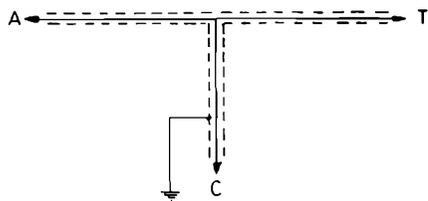
Figura 4 - Indicazione semplificata del metodo di collegamento tra la testina (T) e l'amplificatore (A), prevedendo però una diramazione (C) che fa capo all'ingresso del contatore.
