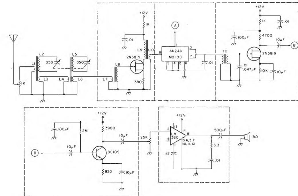
Il miglior tipo di filtro che sia stato possibile usare aveva più o meno il medesimo effetto attribuibile alla capacità C1, nello schema elettrico di figura 3.
