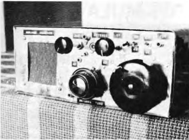
Figura 5 - Parte frontale del ricevitore; i commutatori complementari e gli zoccoli servono per consentire l'interfacciamento con un trasmettitore a doppia banda laterale, da 5 W di potenza nominale.
