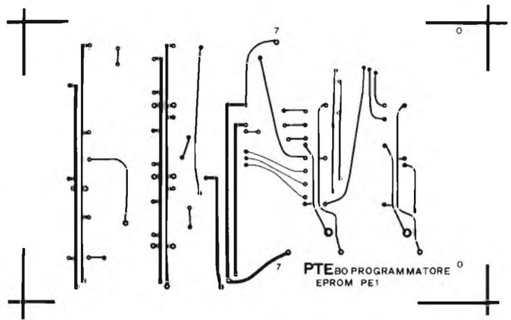
Figura 30 a-b - Disegno del circuito stampato del programmatore EPROM PE1.
