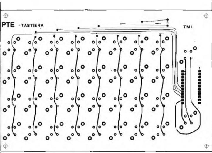
Figura 23 a-b - Disegno del circuito stampato della tastiera TM1.
