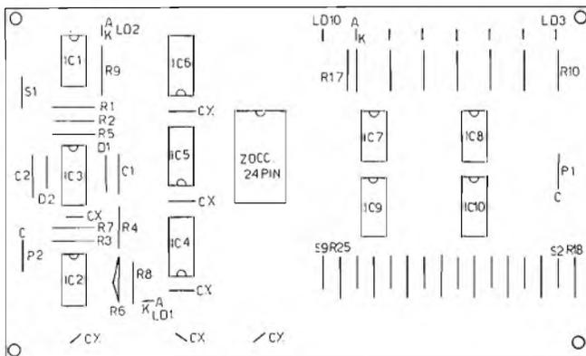
Figura 31 - Montaggio componenti del programmatore EPROM PE1.
