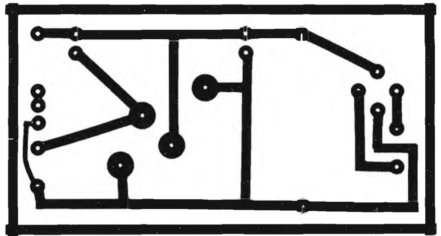
Figura 14 - Circuito stampato dell'alimentatore.
