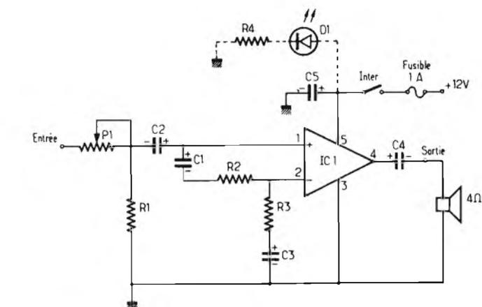
del circuito integrato, e ad esso fa capo anche la capacità C5, che agisce da sistema di disaccoppiamento.
