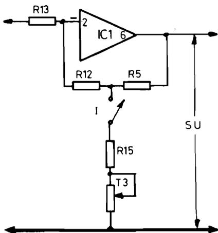
Figura 5 - Rappresentazione schematica dell'integrato impiegato nella fase di compressione.
