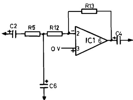
Figura 2 - Schema semplificato dell'integrato, funzionante come compressore.
