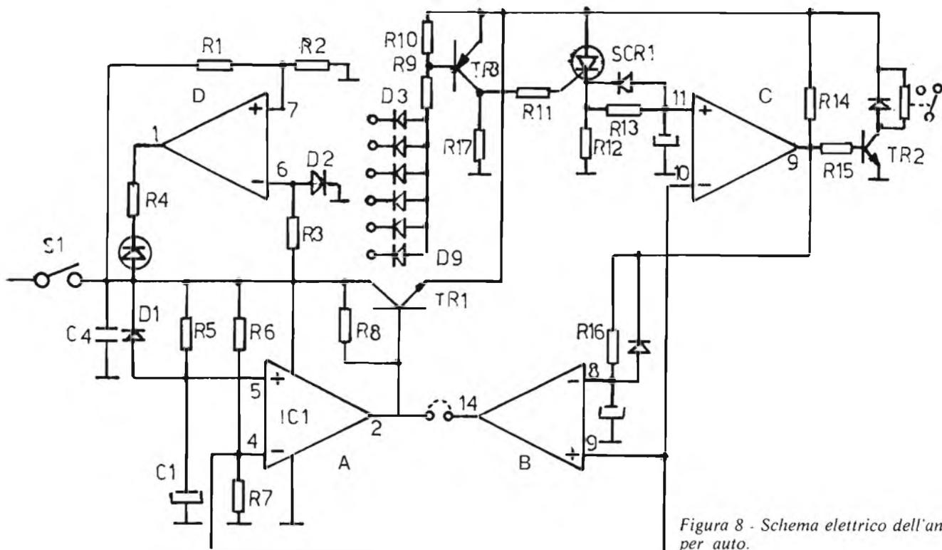
Figura 8 - Schema elettrico dell'antifurto per auto.
