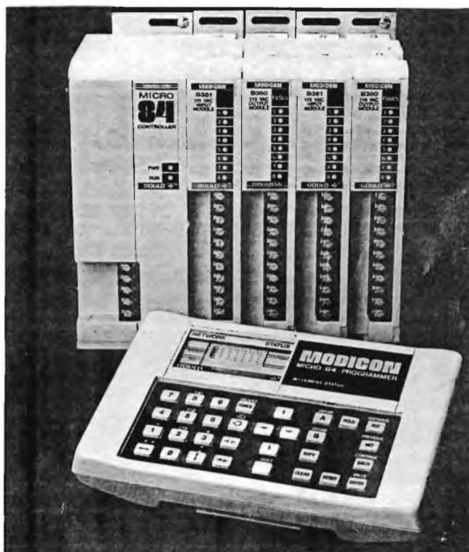
zando anche tasti-chiave definiti dall'utente, è possibile configurare reti fino a sette elementi in serie per quattro rami di parallelo. E' altresì possibile impostare operazioni aritmetiche, visualizzare in maniera dinamica (con indicazione di percorso del flusso di energia) quanto programmato, nonché i valori dei temporizzatori/contatori/variabili interne.
