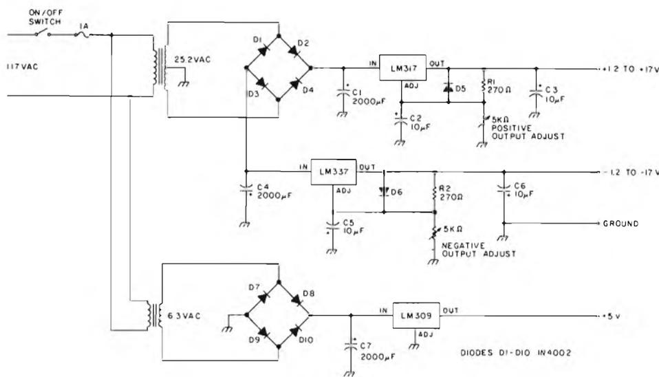
Figura 1 - Schema dell'alimentatore regolato in grado di fornire in uscita tre diversi valori di tensione.
