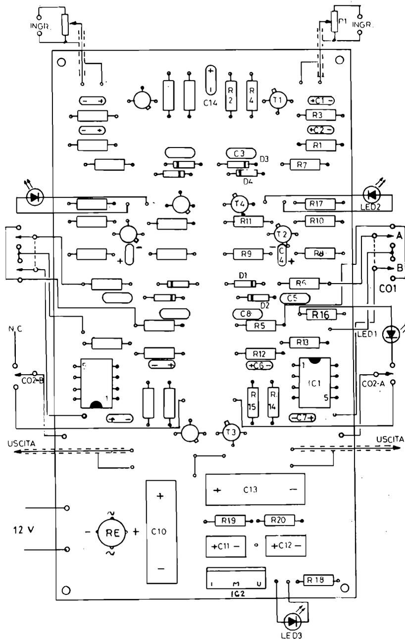
Figura 7 - Riproduzione del lato rame del circuito stampato per l'installazione di entrambe le unità, e della sezione di alimentazione.
