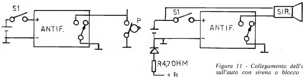
Figura 11 - Collegamento dell'antifurto sull'auto con sirena o blocco puntine.
