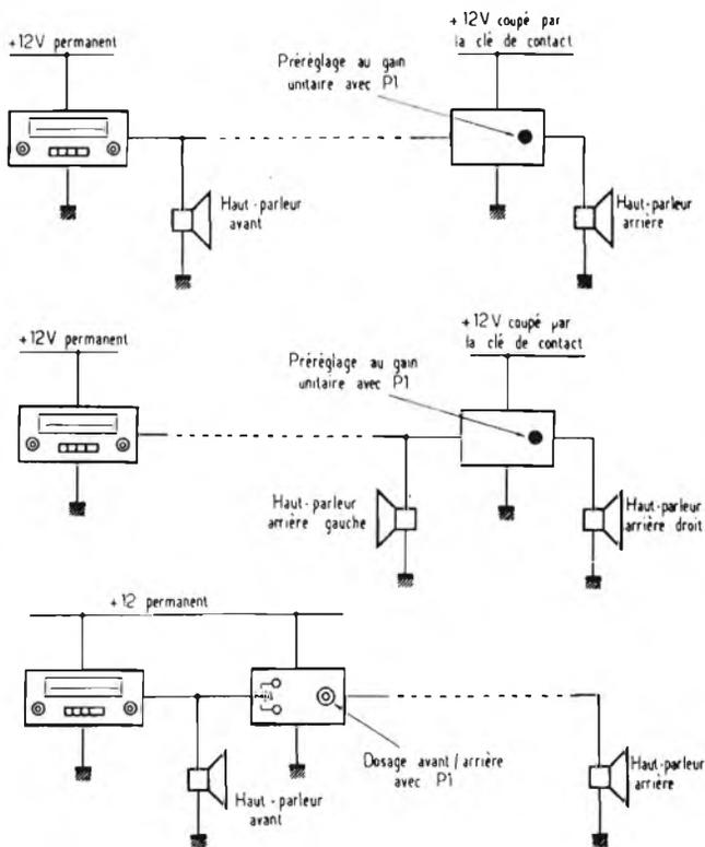
Figura 4 - Tre diverse possibilità di installazione.
