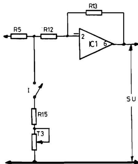
Figura 6 - Riproduzione della parte del circuito quando viene predisposta per il funzionamento come espansore.
