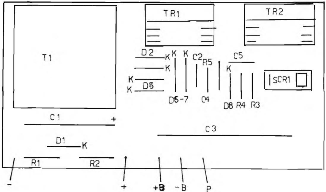
Figura 4 - Montaggio componenti accensione elettronica.
