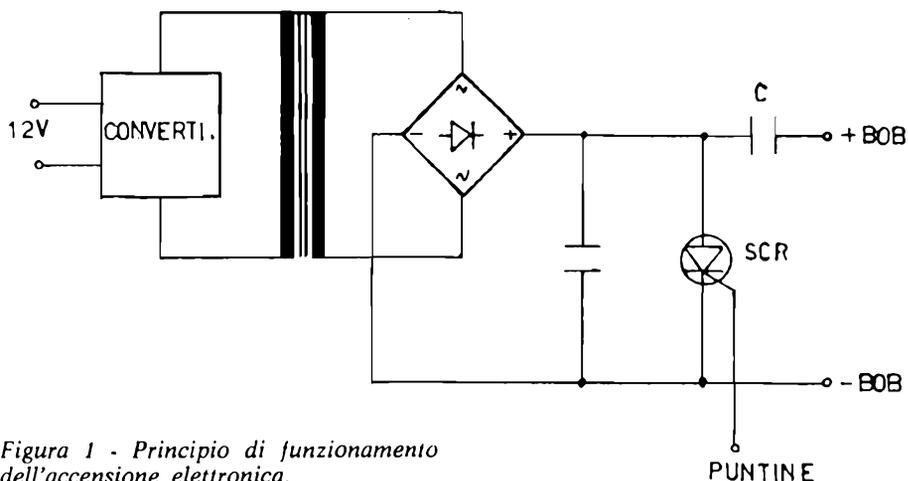
Figura 1 - Principio di funzionamento dell'accensione elettronica.
