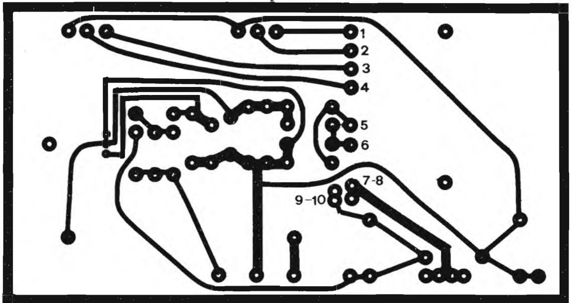
Figura 3 - Circuito stampato monofaccia per accensione elettronica.
