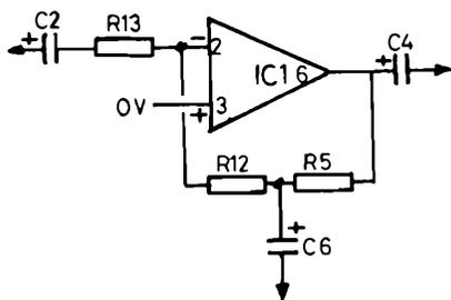
Figura 3 - Schema semplificato dell'integrato, funzionante come espansore.
