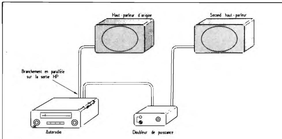
Figure 1 - Rappresentazione schematica del principio di funzionamento dell'amplificatore supplementare.
