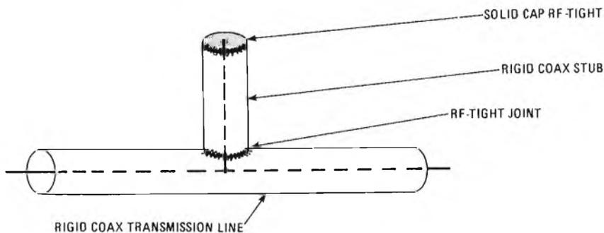
Figura 2 - Tecnica realizzata del raccordo coassiale.
