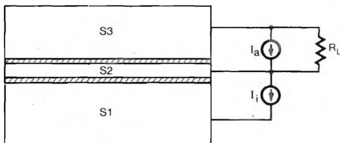
Il QUITERON è formato da strati di materiale superconduttore (S) e da materiale isolante (linee tratteggiate della figura).
