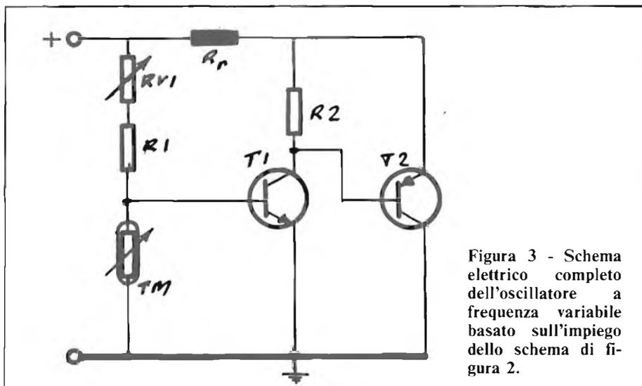
Figura 3 - Schema elettrico completo dell'oscillatore a frequenza variabile basato sull'impiego dello schema di figura 2.
