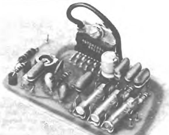
Figura 4 - Fotografia della basetta a circuito stampato sulla quale viene installata una delle unità di un impianto stereo, oppure l'unico amplificatore supplementare di un impianto monofonico.
