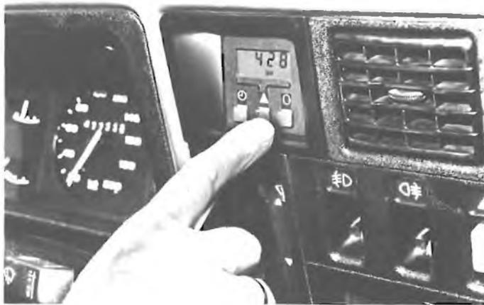
Viaggiando su auto equipaggiate con il nuovo calcolatore di bordo della Siemens, è possibile conoscere i più significativi dati di marcia: un minuscolo microcomputer rileva ed elabora tutti i dati che interessano, visualizzandoli, volendo su di uno strumento indicatore. L'apparecchio occupa un piccolo spazio paragonabile a quello che occorre per un orologio digitale. Premendo un pulsante, il calcolatore di bordo indica a scelta l'ora, il consumo del momento, il consumo e la ve-
