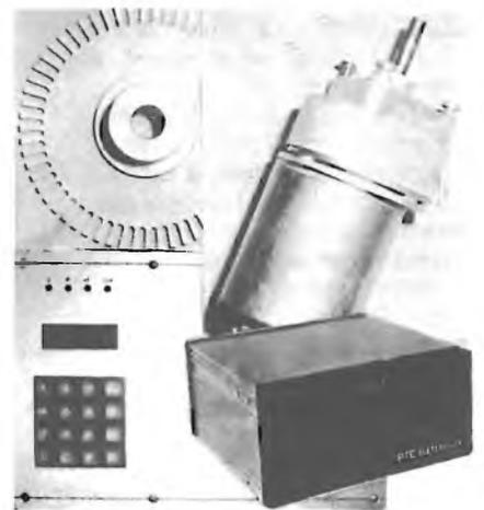
**CONTAGIRI elettronico completo di trasduttore e ruota dentata**
