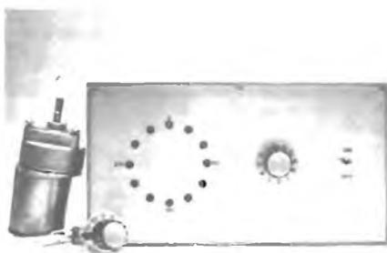
**VISUALIZZATORE** DI POSIZIONE per rotore
