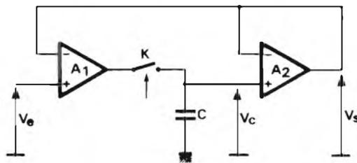
Figura 7 - Circuito pratico del campionatore-bloccatore realizzato con l'impiego di un numero limitato di componenti.
