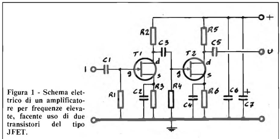
Figura 1 - Schema elettrico di un amplificatore per frequenze elevate, facente uso di due transistori del tipo JFET.
