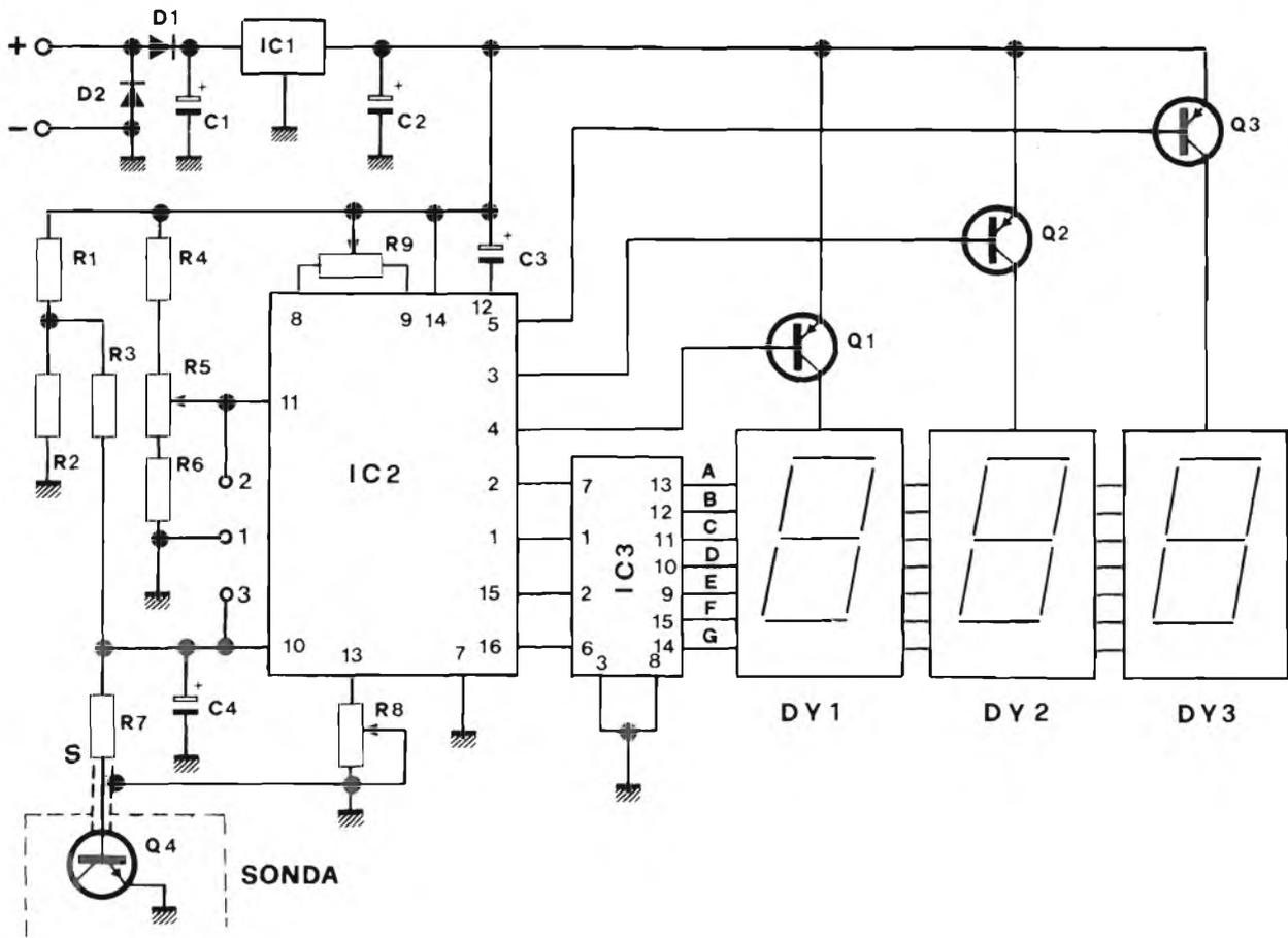
coppiati da Q1, Q2 e Q3 i quali hanno funzione di interfaccia compatibile col pilotaggio digitale fornito dal circuito integrato CA3162E.
