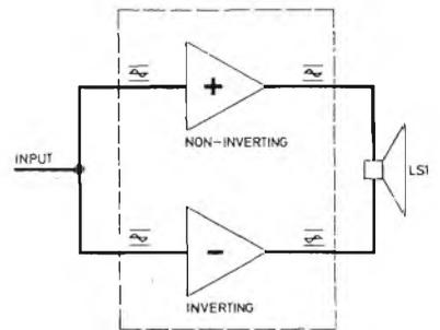
Figura 2 - Tecnica di collegamento di un sistema supplementare di amplificazione del tipo a ponte, funzionante in opposizione di fase.
