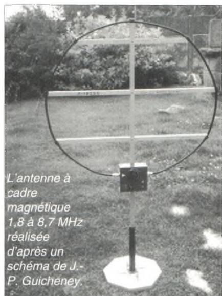
L'antenne à cadre magnétique 1,8 à 8,7 MHz réalisée d'après un schéma de J.-P. Guichenev.
