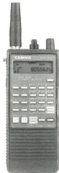
cache des performances assez surprenantes. Il est identique, à quelques détails près, au ALAN SCAN 1310. Il est équipé des modes AM, FM et WFM et de 1000 mémoires. Aussi destiné aux amateurs de radiodiffusion internationale, il est capable de recevoir entre 100 kHz et 1 300 MHz. Son "grand frère", le HSC-050, est équipé de la Bande Latérale Unique et couvre une gamme de fréquences allant jusqu'à 2 GHz.
