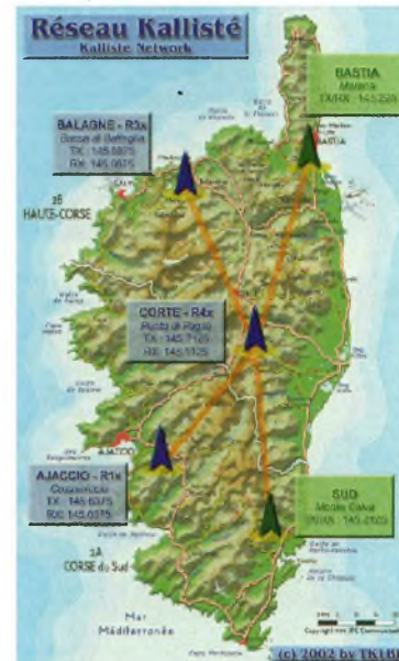
Les 5 relais recouvrant la Corse avec le réseau Kallisté
