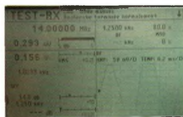
Voici la mesure en AM pour la radiodiffusion ondes courtes, pour un taux de modulation de 80% et 14 à 15 dB de rapport signal sur bruit, le DJ-X2000 sort des signaux à moins de 0.3 µV... qui dit mieux.
