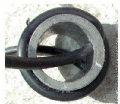
La self en vue de dessus. Ci-dessous : En bout d'antenne, une durite silicone permet de jouer le rôle de crochet.
