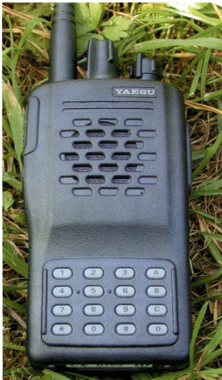
Pas d'écran LCD pour le Yaesu mais un clavier alphanumérique vraiment pratique.
