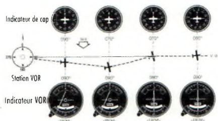
Déviations de l'aiguille de l'indicateur VOR
