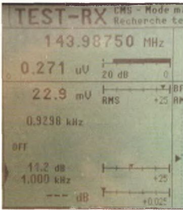
La vraie bande des parapentistes sur laquelle nous avons testé en FM le seuil à 12 dB SINAD.
