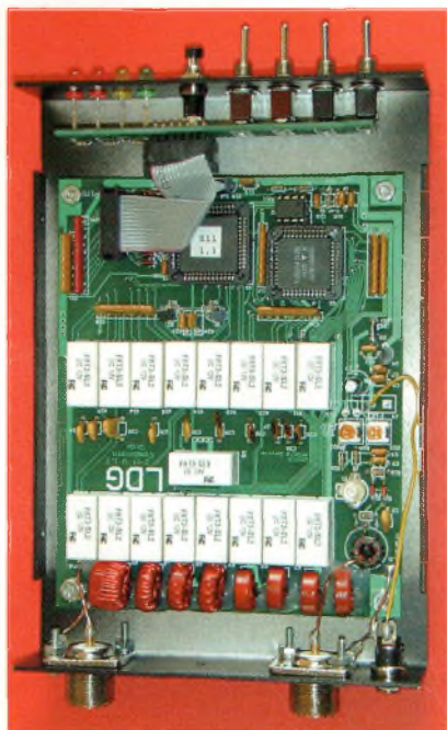
Une vue globale sur l'électronique analogique... relais et self mais aussi des condensateurs... le tout dans un univers construit autour d'un microcontrôleur Motorola.
