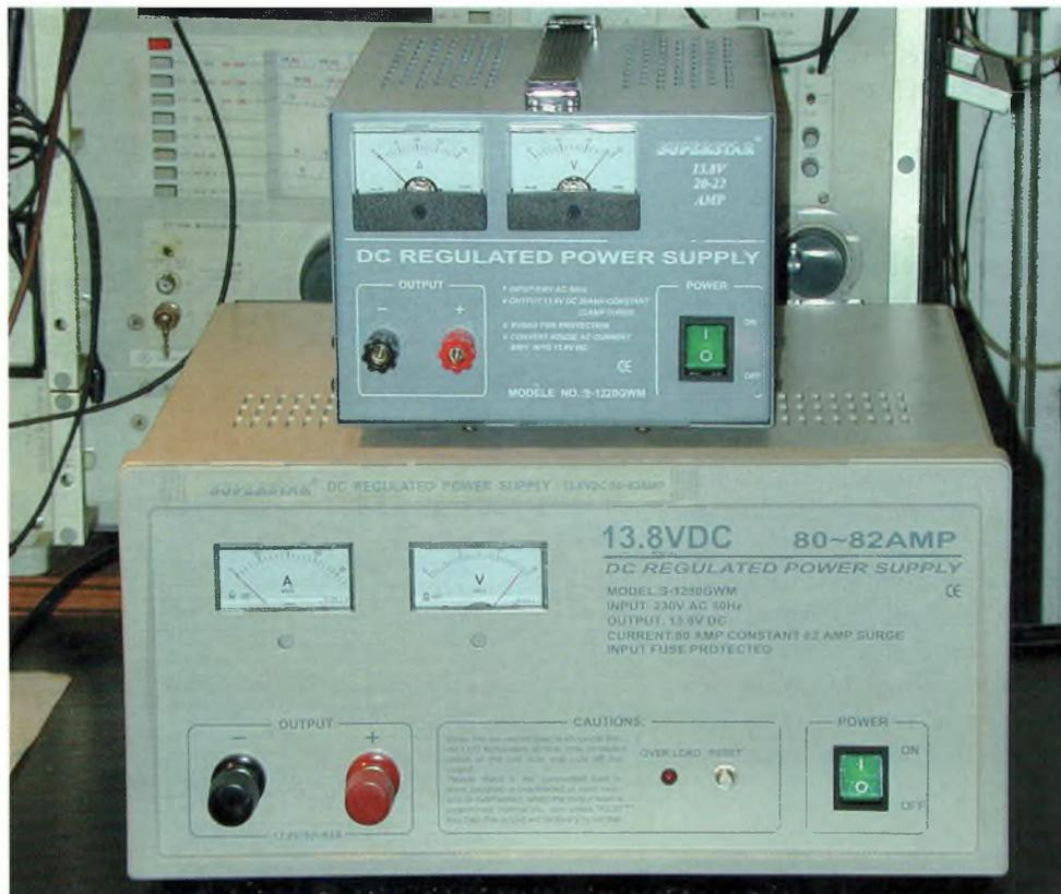
Pas de ventilateur sur la version 20 ampères, mais le gros dissipateur thermique semble suffire dans la plupart des cas.
