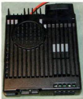
Un boîtier en alu moulé solide et qui a du mal à surchauffer.
