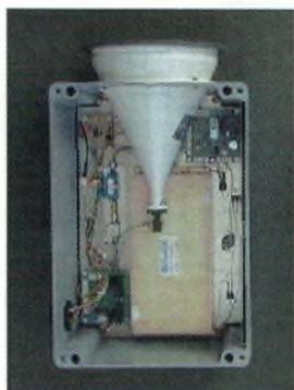
Un radiomètre en construction. Crédit Photo RCRU
