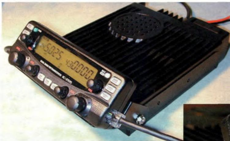
**E**n UHF la puissance de sortie débute à une valeur très inhabituelle puis chute brusquement pour se stabiliser vers 22-25 watts selon la fréquence. D'autre part, à la moindre pression sur le PTT le ventilateur s'excite et finit par agacer si le transceiver est proche.
