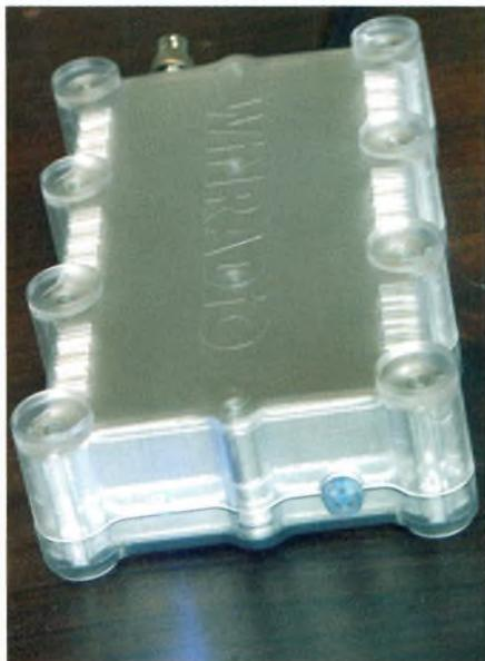
**Ce récepteur bénéficie des tous derniers perfectionnements technologiques. Son cœur repose sur une structure à double changement de fréquence. Il permet dans sa version « de base » d'écouter et de mesurer tout signal entre 9 kHz à 30 MHz, 180 MHz en option.**
