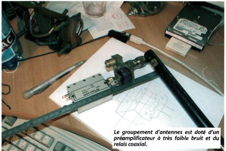
Le groupement d'antennes est doté d'un préamplificateur à très faible bruit et du relais coaxial.
