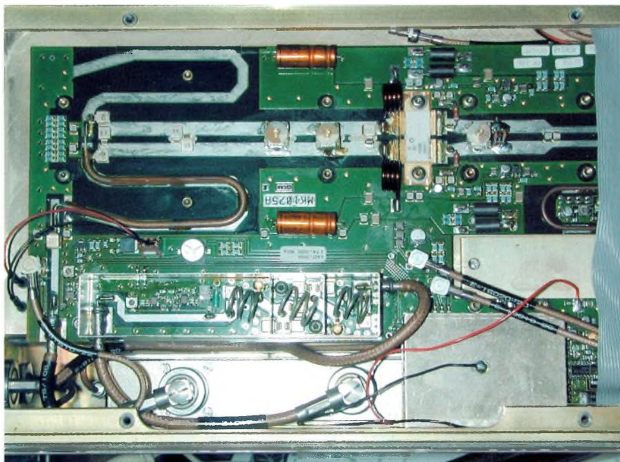
**L'amplificateur terminé, les réglages restent à faire. Commencez à puissance modérée pour augmenter progressivement. Le régime de fonctionnement d'origine n'est pas spécifiquement adapté pour la BLU mais, à faible puissance de sortie, jusqu'à 60 watts il est possible de l'utiliser. En réalisant les modifications du point de repos des 2 transistors certains utilisateurs sortent jusqu'à plus de 300 watts PEP.**
