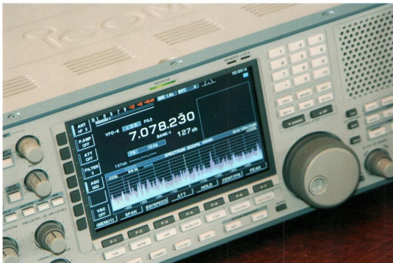
Tout d'abord il est d'une prise en main d'une simplicité exemplaire, dans la continuité des produits ICOM. Inutile également de dire que ce récepteur fonctionne essentiellement sur le principe du traitement du signal. Des circuits DSP assurent le traitement des signaux pour les différentes fonctions ainsi que pour les systèmes de démodulation, sauf vidéo. Il s'agit donc d'un récepteur SDR qui n'a pas besoin d'ordinateur pour fonctionner.
