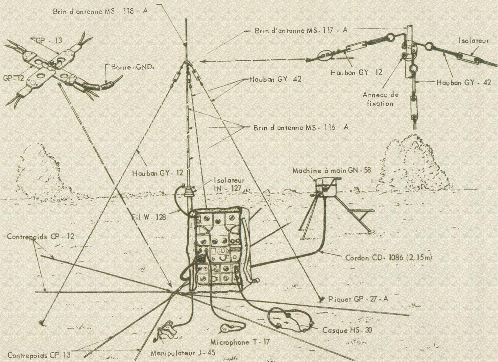
Fig. 1 bis - AN-GRC-9 - Installation à terre avec antenne - fouet
