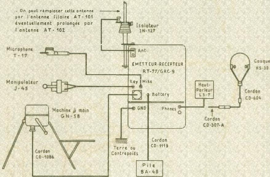
Fig. 2<sup>b</sup> AN/GRC-9 - SCHÉMA DE BRANCHEMENT DU POSTE AN/GRC-9 SUR VÉHICULE
