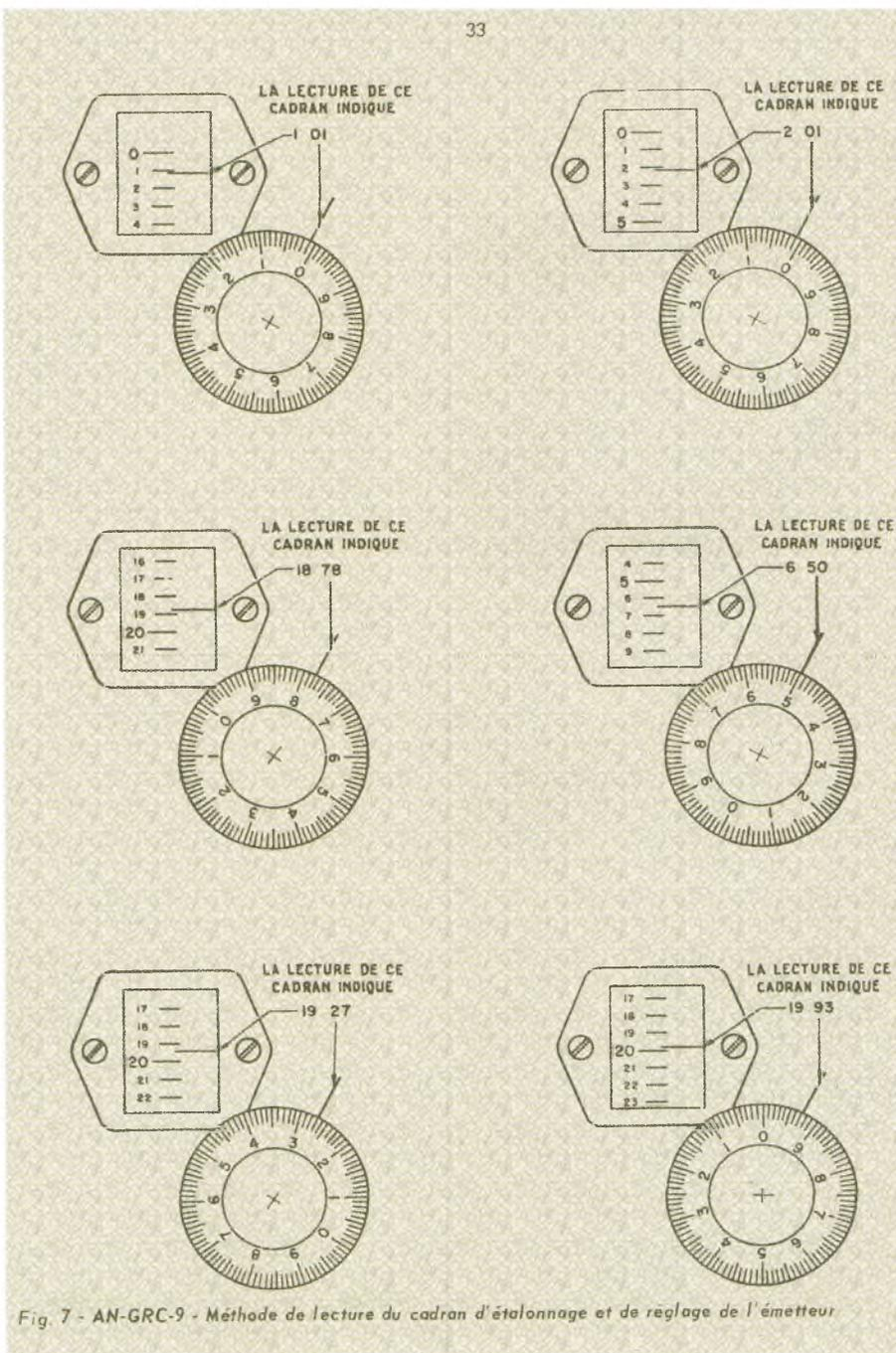
Fig. 7 - AN-GRC-9 - Méthode de lecture du cadran d'étalonnage et de réglage de l'émetteur
