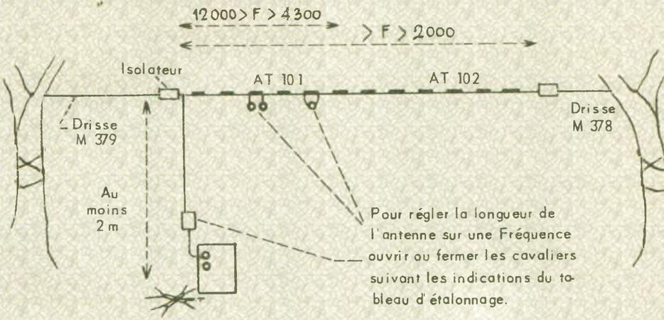
Fig. 1 ter - AN-GRC-9 - Antenne filaire AT-101 et AT-102
