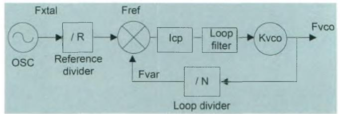
La topologie de PLL utilisée dans l'ASIC SigFox est appelée "fractionnaire" ou "fractional N" ou "Frac-N" car le diviseur de la boucle est fractionnaire et plus seulement entier. Beaucoup de littérature existe dans ce domaine. Nous avons sélectionné quelques références (réf 1, 6, 7)
