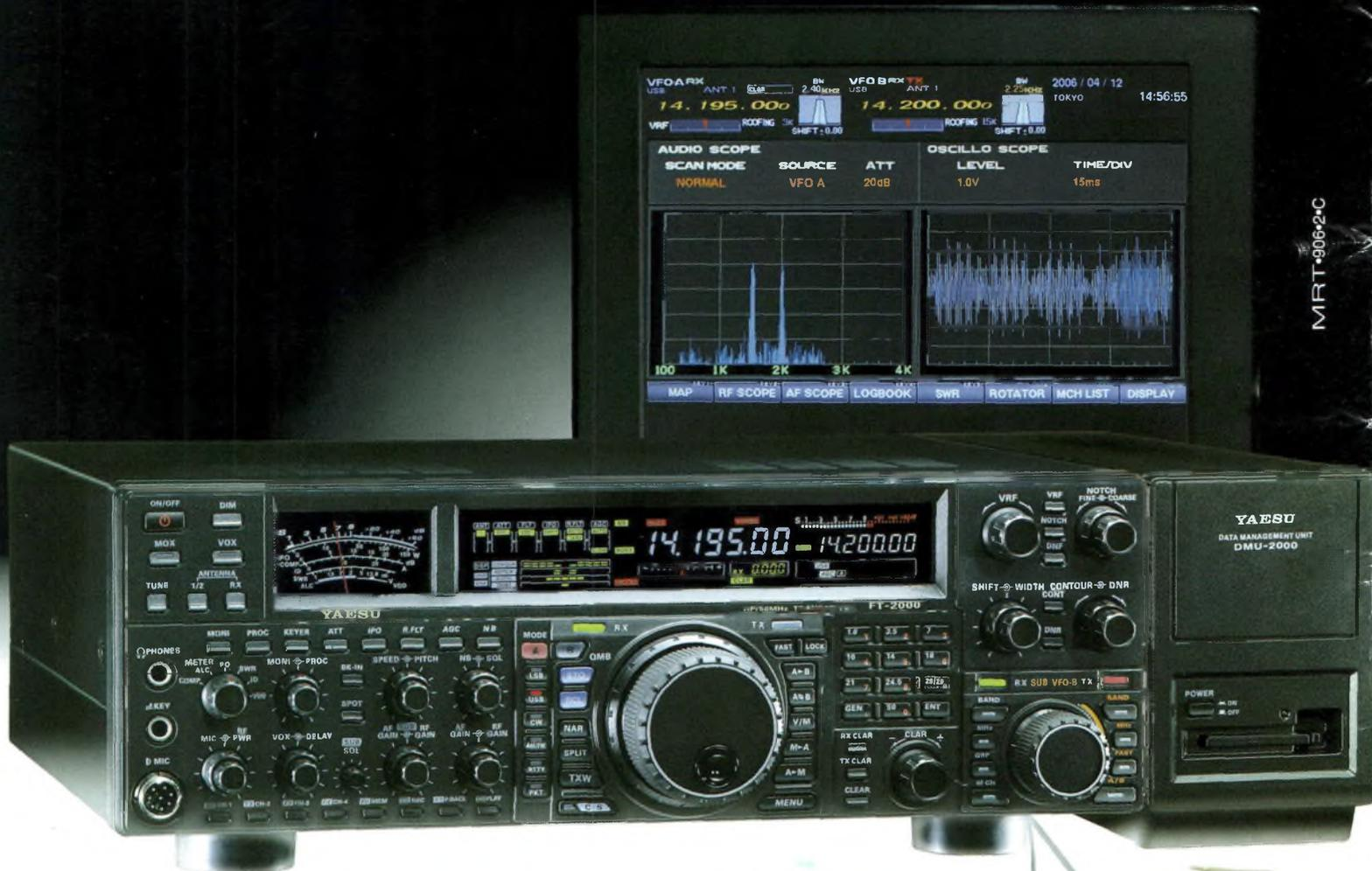
Moniteur, clavier et manipulateur non fournis. L'option DMU-2000 et un moniteur sont nécessaires pour l'affichage des différentes fonctions.
