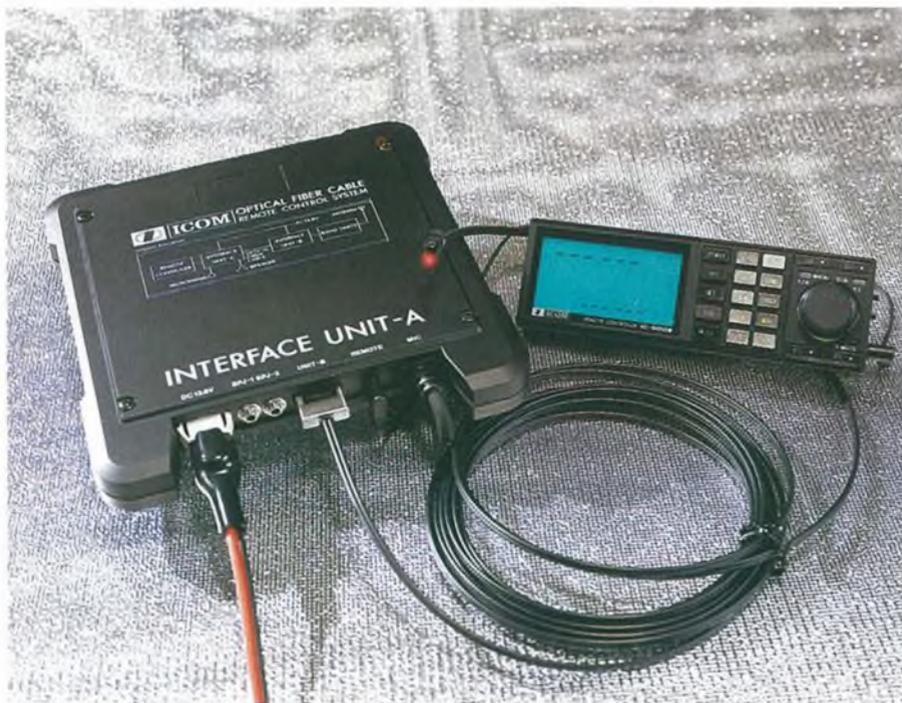
Foto 1: La consolle di comando connessa all'interfaccia A. Si può notare la luce emessa dall'interfaccia tramite la fibra ottica.
