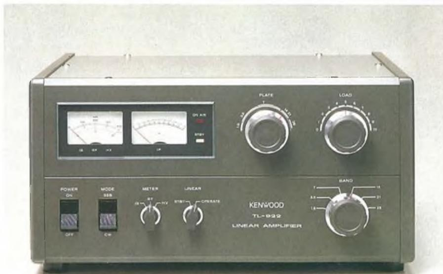
rata, i variabili ed i commutatori di banda sono di ottima fattura e tutti i componenti metallici, sottoposti a corrente R.F., sono argentati.
