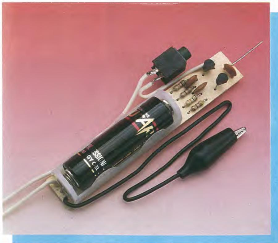
Foto 1. L'iniettore di segnali è utile in tutti quei casi in cui vi siano da verificare guasti in circuiti di amplificazione.
