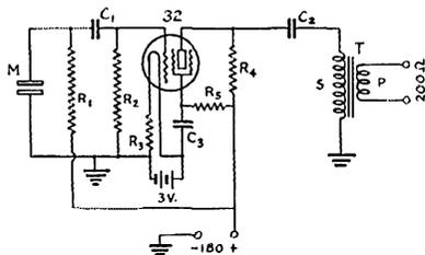
FIG. 1 — SINGLE-TUBE HEAD AMPLIFIER FOR CONDENSER MICROPHONE
