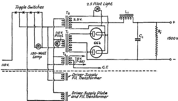
FIG. 2—THE POWER SUPPLY CIRCUIT
