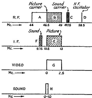
FIG. 1—BLOCK FREQUENCY DIAGRAM FOR THE VIDEO RECEIVER
