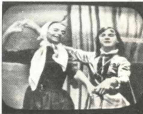
Fig. 2 - Anche una comune lampada, o un'insegna pubblicitaria al neon, può produrre degli inconvenienti più o meno marcati, come quello visibile in figura.
