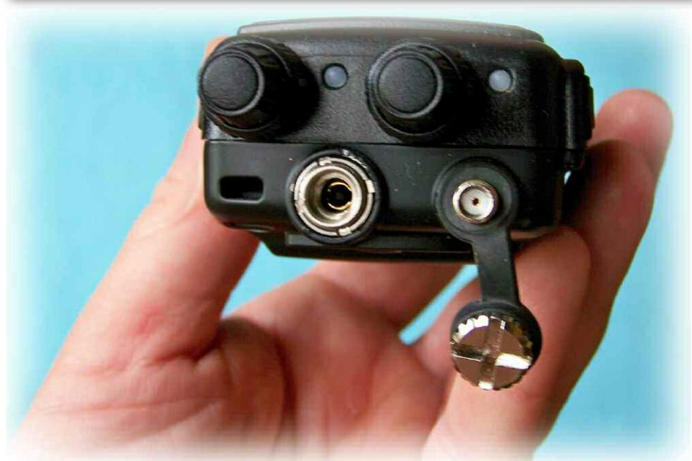
Sauf qu'il faudra bien prévoir le raccord parce que la fiche d'antenne n'est pas une BNC mais une SMA. Il est possible d'utiliser la fonction qui permet de scanner simultanément sur les 2 VFO et/ou sur 2 bandes ou fréquences différentes.
