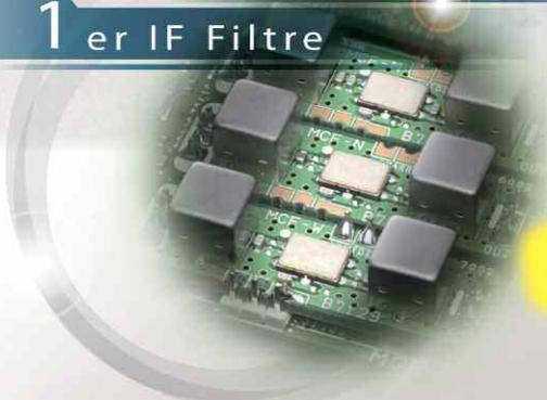
Equipé de 3 « roofing filters » : 3 kHz, 6 kHz et 15 kHz !
