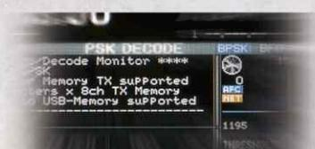
Codeur/décodeur RTTY et PSK31 intégré nécessitant simplement un clavier USB (pas de PC requis).
