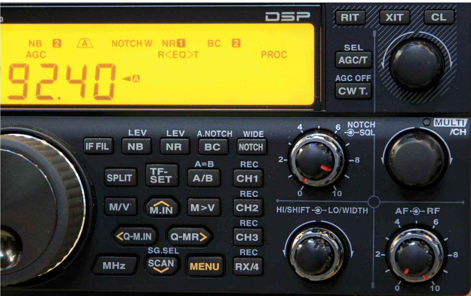
La partie infradyne agit comme un récepteur superhétérodyne à double changement de fréquence sur 11374 kHz puis 24 kHz pour le DSP. Le récepteur supradyne fonctionne lui avec un triple changement sur 73095 kHz, 10695 kHz puis 24 kHz pour le DSP. Le traitement des signaux FM passe par une fréquence intermédiaire de 455 kHz qui du coup reste en traitement analogique.
