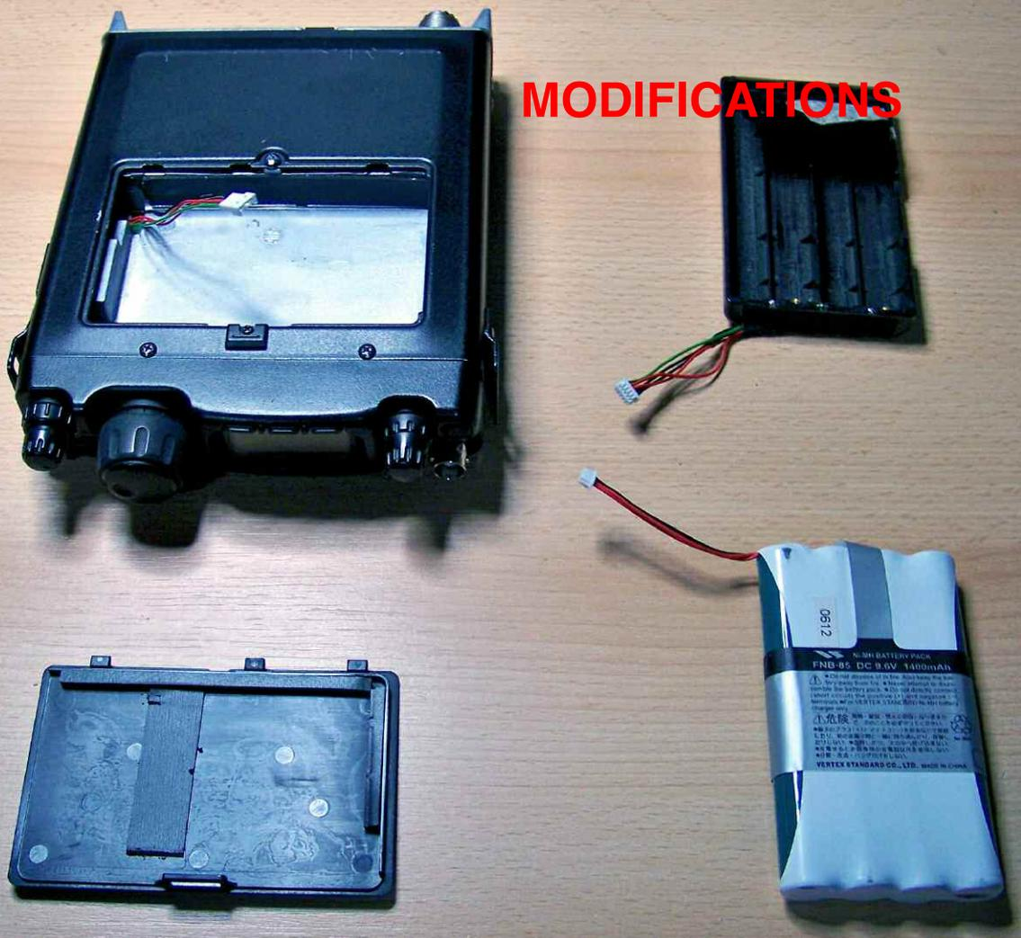
Sur le connecteur batterie il y a un fil VERT. Celui-ci est ramené sur un transistor pour une commande logique qui pilote la gestion de charge et donc l'autorise ou l'interdit.
