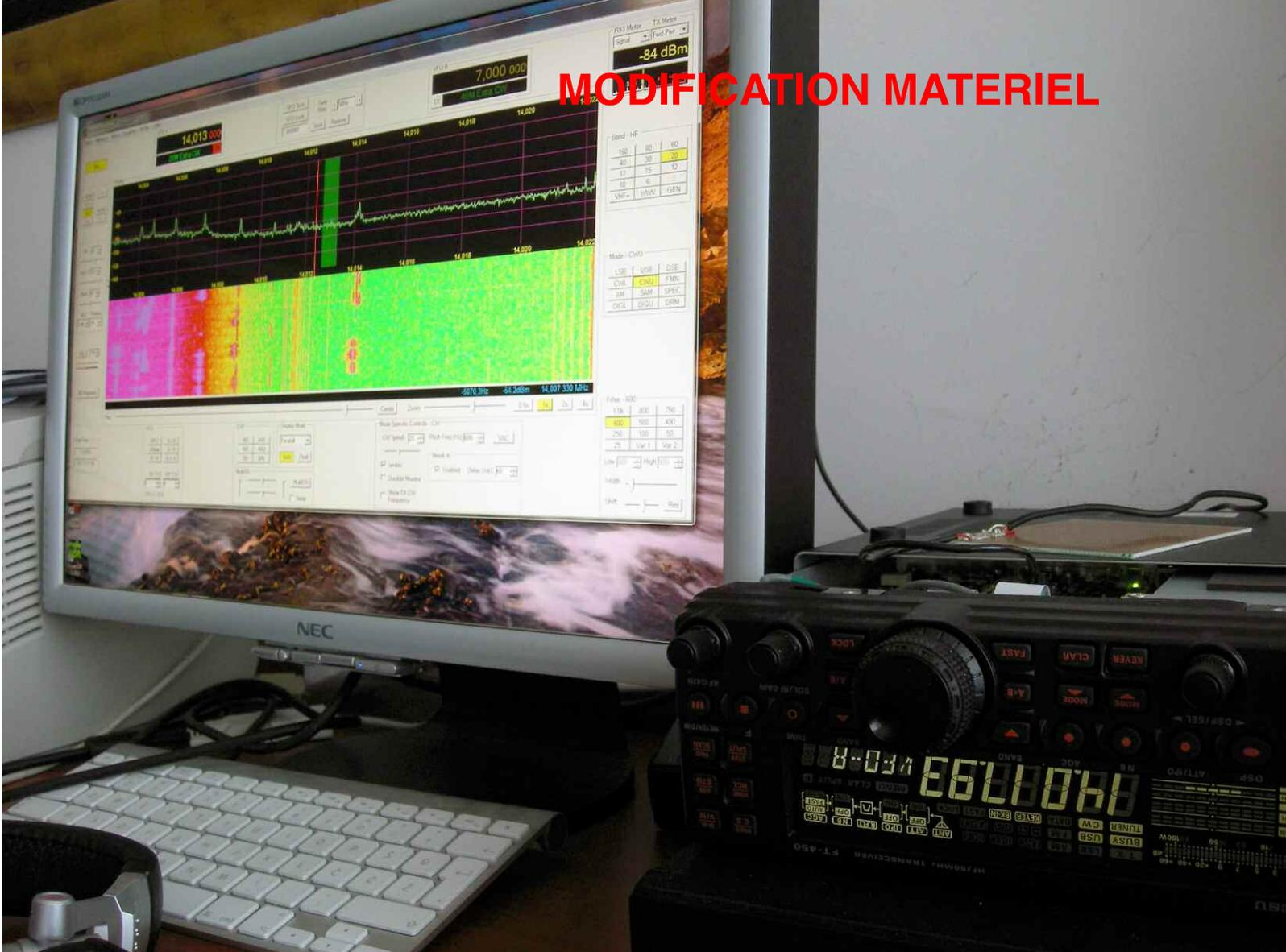
Le FT-450 en service avec son module SDR en cours de test. Ici avec le module Z1000B pris en FI.
