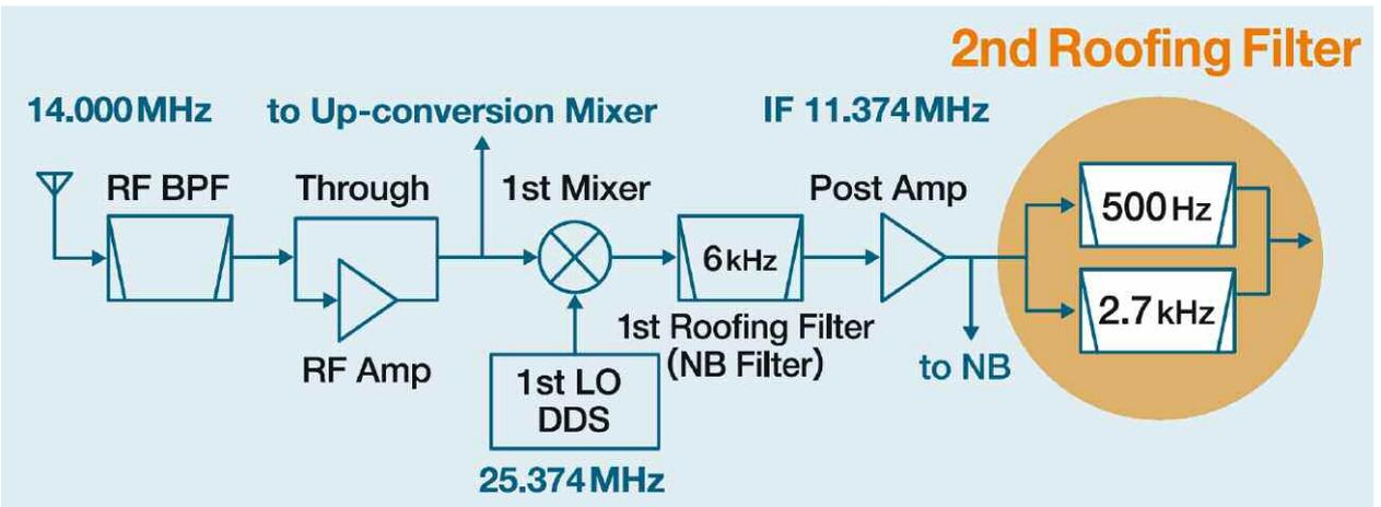
Le synoptique de la partie infradyne du récepteur, on notera la présence des filtres de toiture livrés d'origine dans le poste.
