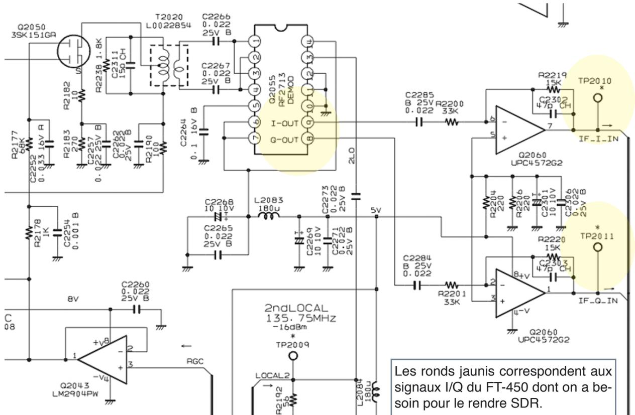
Si on peut récupérer les signaux et les mettre sur l'entrée ligne de la carte son d'un micro-ordinateur, ensuite avec un logiciel comme Rocky, PowerSDR, ou GNU Radio, les possibilités de traitement sont infinies!
