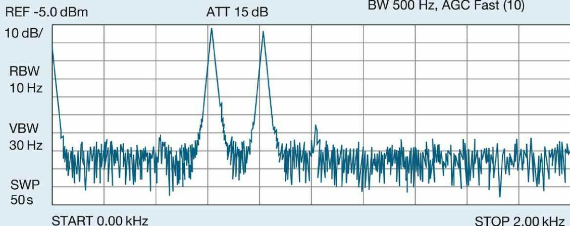
Cette mesure d'intermodulation est proposée par Kenwood, le résultat est significatif d'un bon, voire très bon récepteur.
