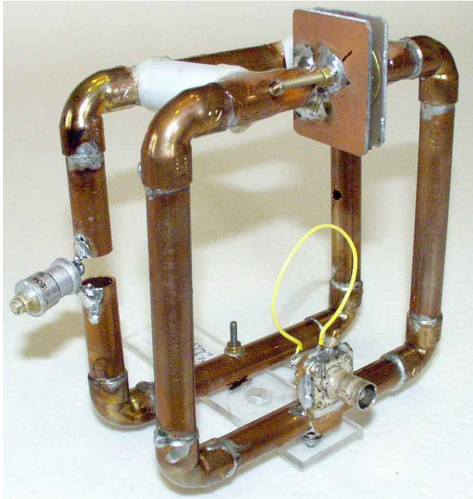
Grâce à l'effet directif de la seconde boucle, un gain de 6 dB a pu être obtenu.
