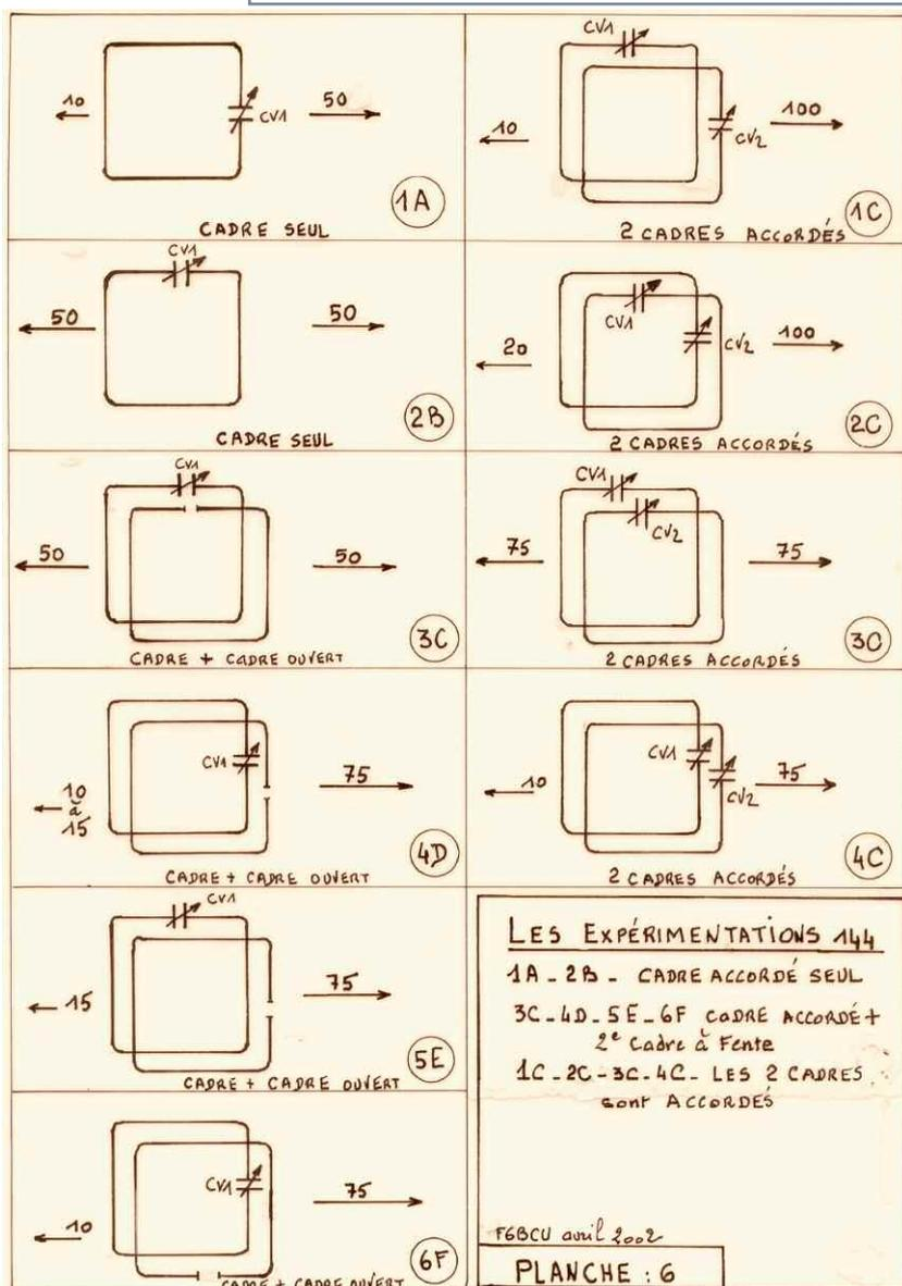
A lire l'article de F9VX, l'adjonction de la boucle N°2, fente en haut, côté capacité d'accord donnerait des performances insoupçonnées :
