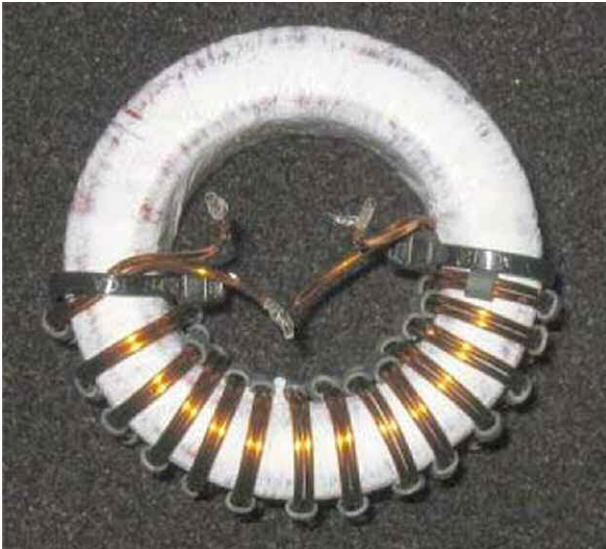
La trace rouge – Enroulement bifilaire à spires rapprochées avec du fil émaillé 1mm. (Sur la photo le noyau est entouré d'une bande en PTFE pour éviter d'endommager l'émail du fil) J'ai un peu joué avec cette réalisation pour en optimiser les performances et obtenir une réponse plate. Notez que les spires ne sont pas espacées régulièrement autour du tore. Nous en reparlerons plus tard.
