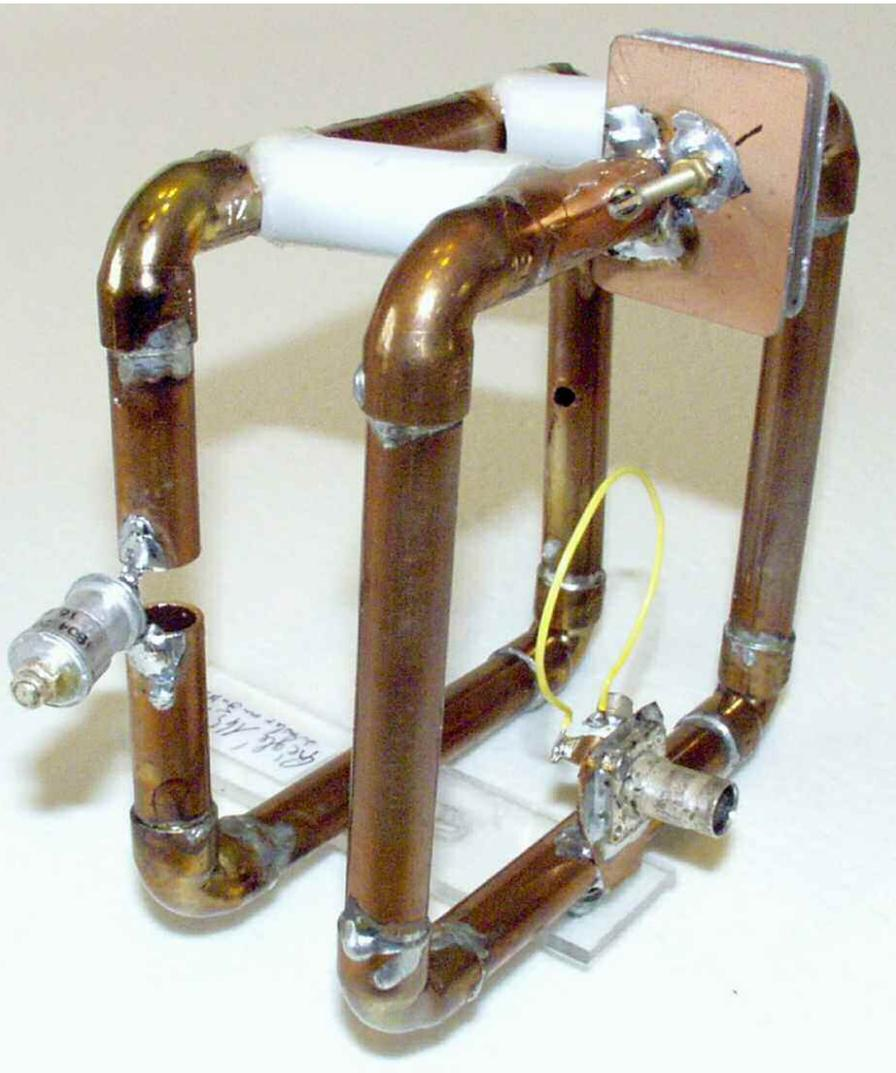
Bande passante : pré-réglée pour nos essais sur 145.562.5, à -3dB nous couvrons 1 MHz. sans retouche de l'accord des 2 cadres.
