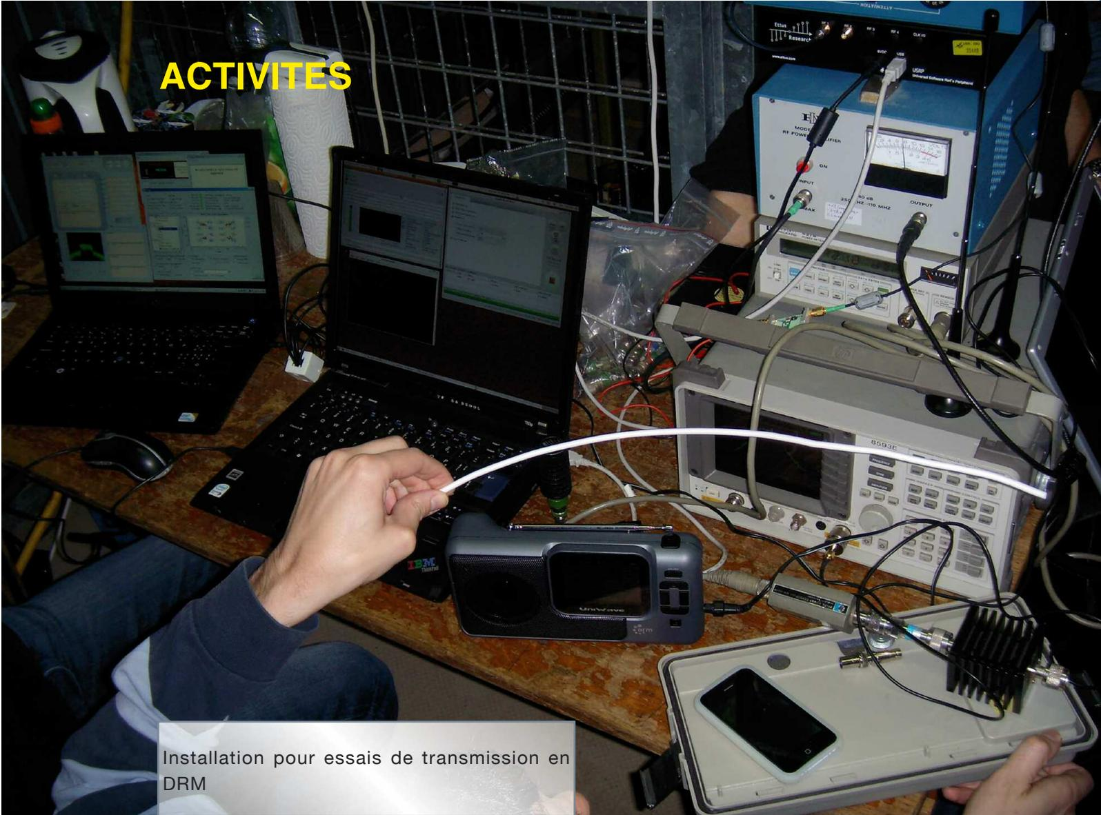
Installation pour essais de transmission en DRM
