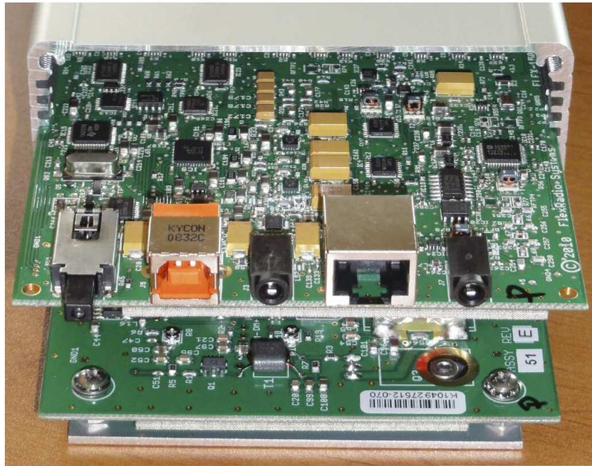
Voici les cartes électroniques qui composent ce FLEX-1500. Bien qu'ayant évolué depuis le SDR-1000 la méthode de fabrication reste identique afin de préserver un prix de revient assez bas. **On notera quand même les faces avant et arrière en aluminium et les bords de cartes dotés de balais métalliques afin d'assurer la continuité électrique.**
