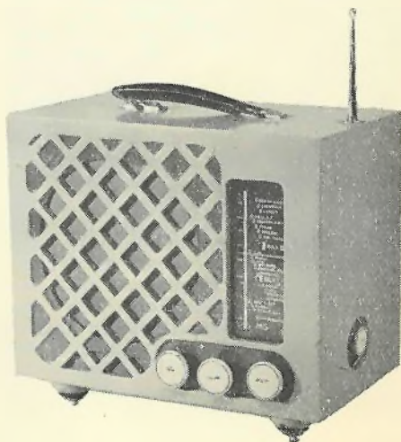
DE FIETSRADIO met algehele voeding d.m.v. twee rijwieldynamo's.
