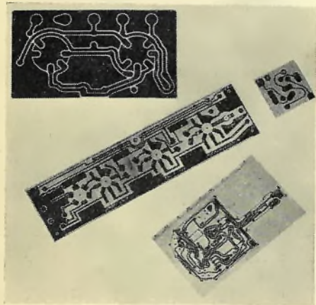
b. Technograph Ltd. Plastiek met koperbeslag, schakeling wordt geëtst. De platen worden van Bakelite Ltd. betrokken
