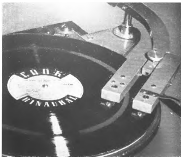
Fig. 45 - LIVINGSTON TOONARM voor binaurale reproductie van grammofoonplaten
