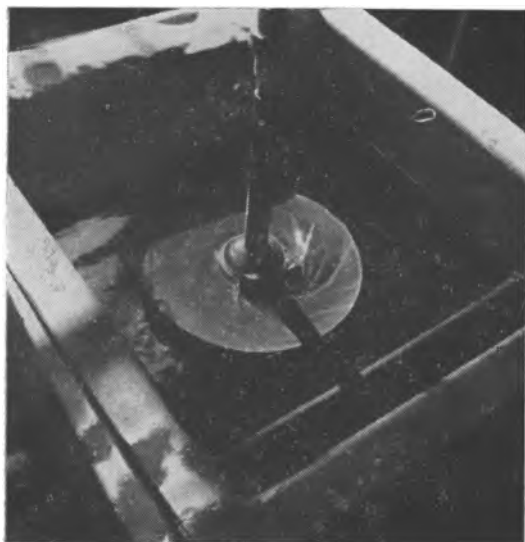
Fig. 62 - GALVANISCH KOPERBAD met draaiende katode.
