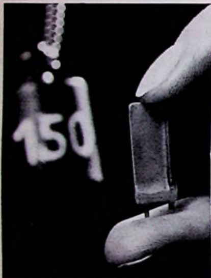
Afb. 1. Het piëzo-keramische element van de druktoets.
