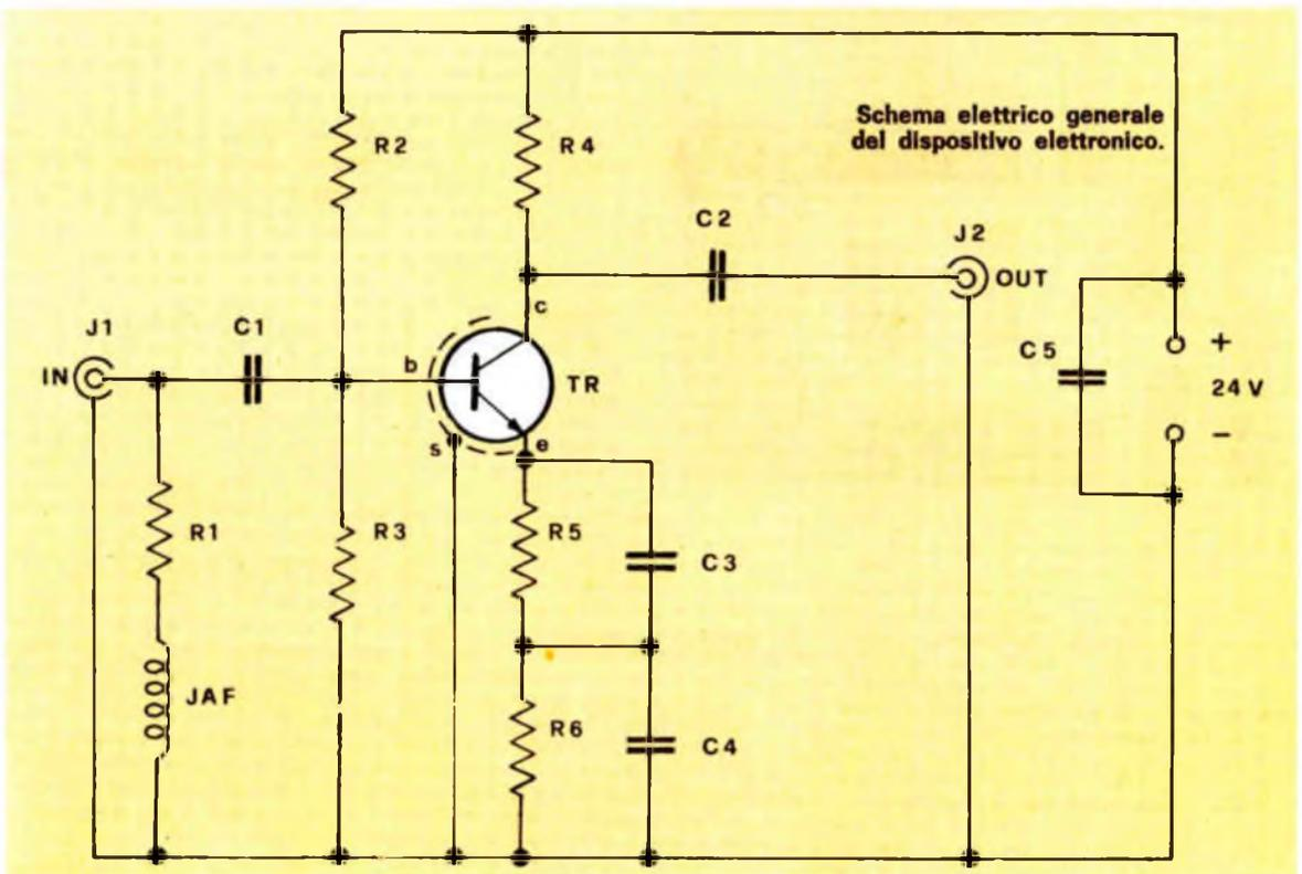
è dettata dalla presenza di una larghissima banda da amplificare e quindi, come sicuramente saprete, il valore dell'impedenza è funzione della frequenza per cui all'aumento del ritmo di oscillazione si produce un cambiamento d'impedenza che, impiegando una rete aperiodica sul genere di R1-Jaf, può essere compensatore stabilendo un'impedenza d'ingresso costante e pari a 75 ohm.
