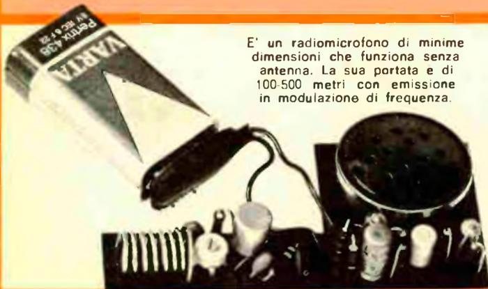
E' un radiomicrofono di minime dimensioni che funziona senza antenna. La sua portata e di 100-500 metri con emissione in modulazione di frequenza.
