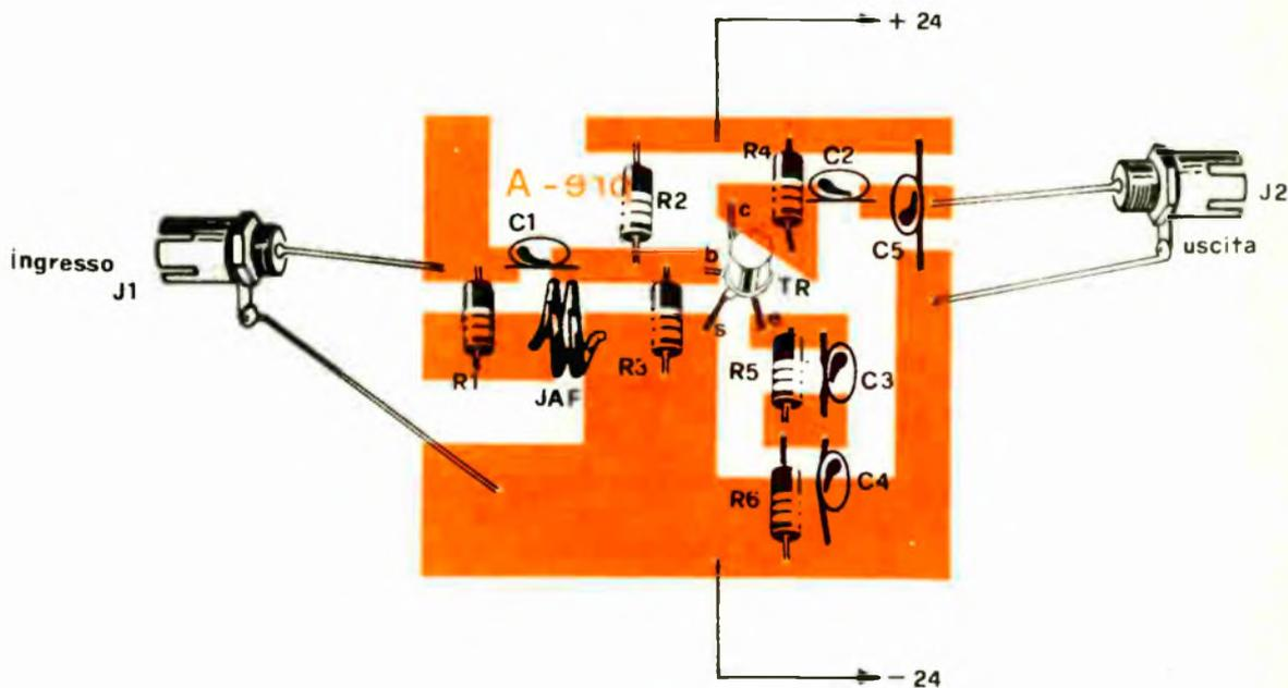
Disposizione dei componenti a cui è necessario attenersi per un corretto montaggio.
