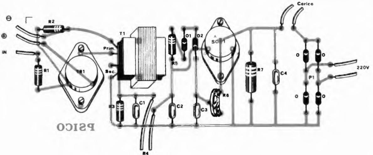
Disposizione dei componenti sulla basetta. Per un miglior funzionamento consigliamo di fissare lo SCR ad un buon dissipatore.
