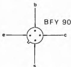
**Codice per l'identificazione dei quattro terminali (E, B, C, S) del semiconduttore utilizzato per la costruzione del booster.**
