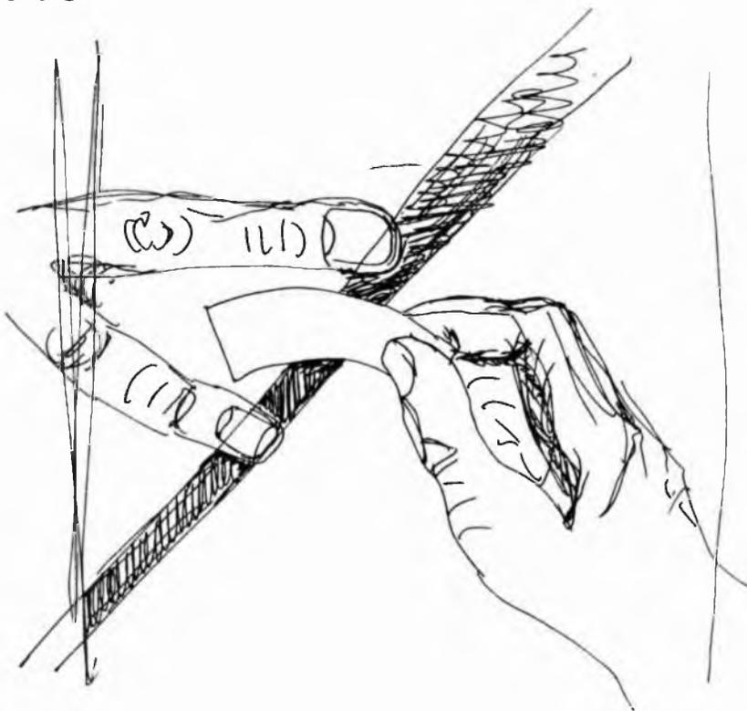
**Distaccata la giunta dal piano, si rifila con le forbici il nastro adesivo eccedente. Il taglio non deve presentare scalini, che incepperebbero il nastro nel suo scorrimento.**
