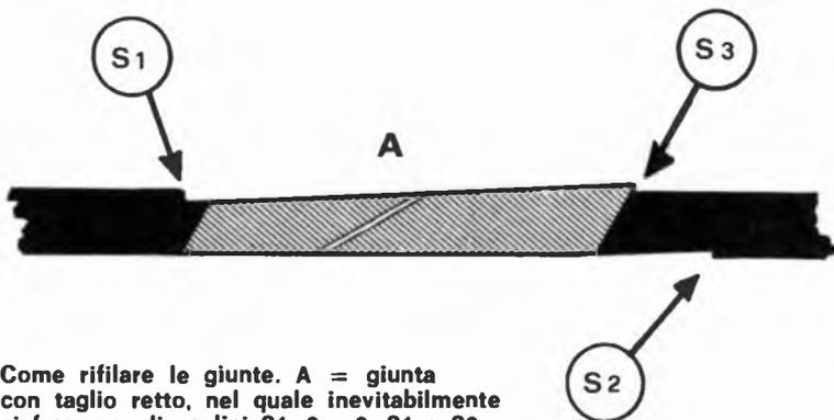
Come rifilare le giunte. A = giunta con taglio retto, nel quale inevitabilmente si formano gli scalini S1, 2 e 3. S1 e S2 indeboliscono il nastro e possono essere rilevati elettronicamente.
