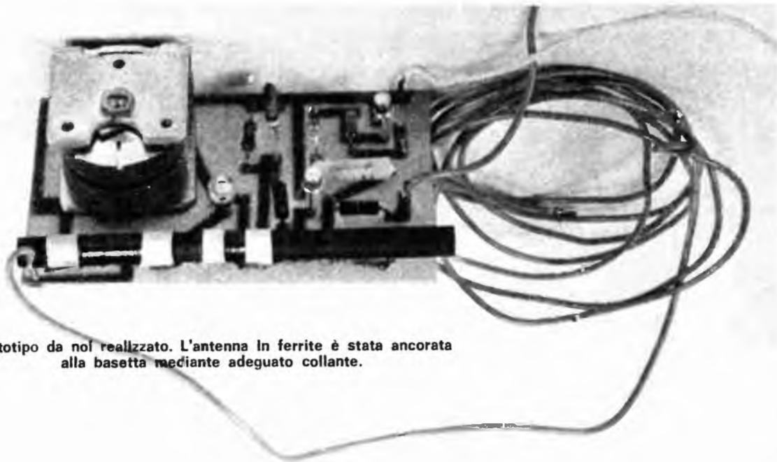
Prototipo da noi realizzato. L'antenna in ferrite è stata ancorata alla basetta mediante adeguato collante.
