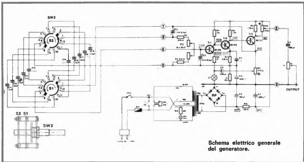
tramite il gioco di commutazione di SW2, ed anche tramite la capacità variabile C1, in modo da ottenere una normalizzazione della forma d'onda dei segnali prodotti.
