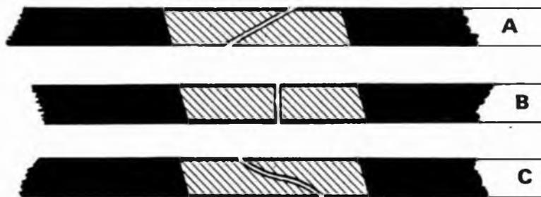
Tre tipi di giunte: A = giunta diagonale classica che non consente di celare il « trucco ». B = giunta ad angolo retto: permette accurati e raffinati montaggi ma richiede molta esperienza. C = giunta « viedotape », eseguita con la giuntatrice Video. Serve per il montaggio delle videoregistrazioni per la TV.
