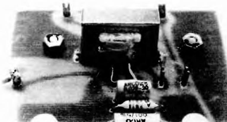
Il trasformatore di uscita utilizzato nel circuito può essere fissato sulla basetta praticando degli appositi fori.
