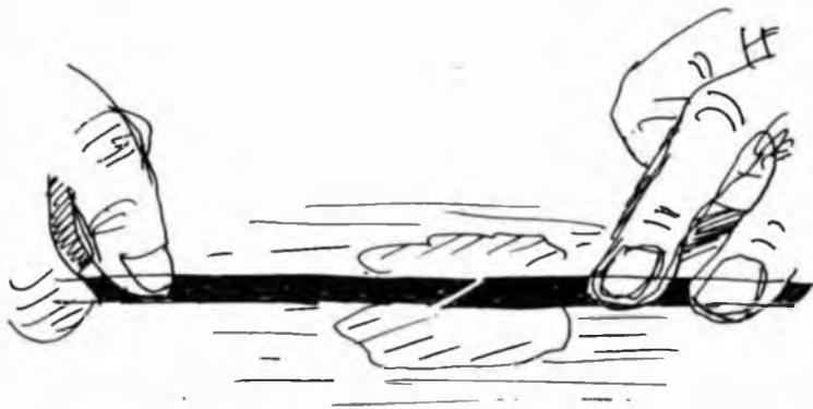
Gli spezzoni dei nastri, tagliati diagonalmente, vengono accostati su di un piano liscio, magari di vetro, fino a toccarsi ma non a sovrapporsi. Per facilitare l'accostamento ed il distacco del nastro adesivo, la superficie piana viene leggermente inumidita, magari con la saliva.
