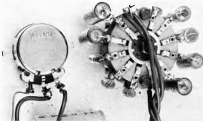
Come si vede dall'immagine, i condensatori per la selezione delle portate sono direttamente fissati al commutatore.
