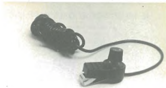
Pick-up piezoelettrico da applicare al foro della cassa armonica.
