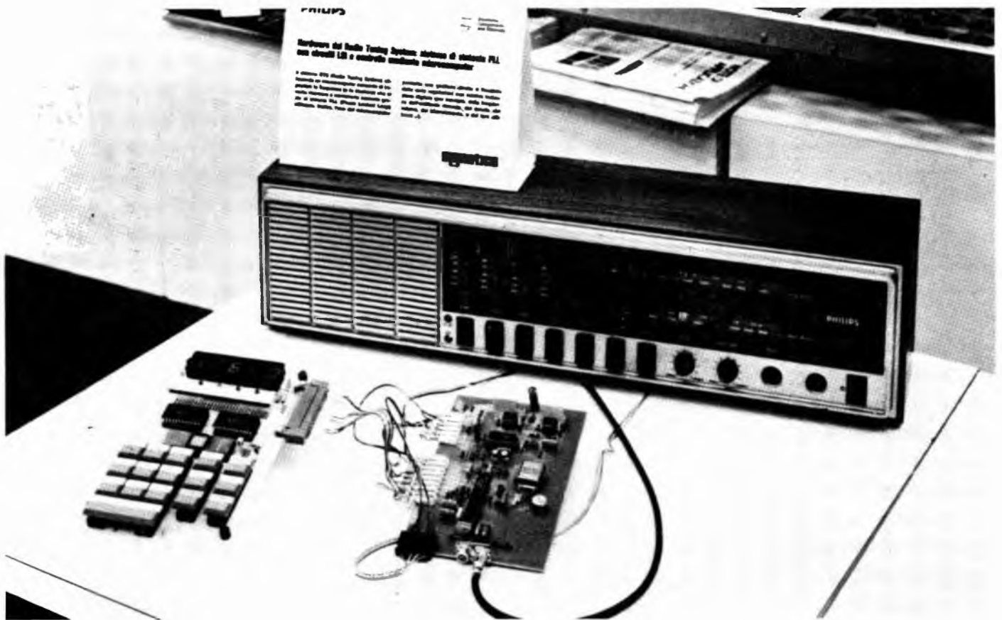
Sistema sintonia a microcalcolatore RTS Philips Elcoma. Qui sotto sequenza operazioni in un ciclo di misura nell'integrato SAA 1070.
