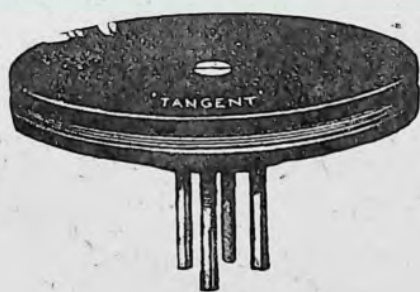
Fig. 4. — Transformateur haute fréquence sans fer, du type décrit dans le N° 3 de « Radio-Revus ».
